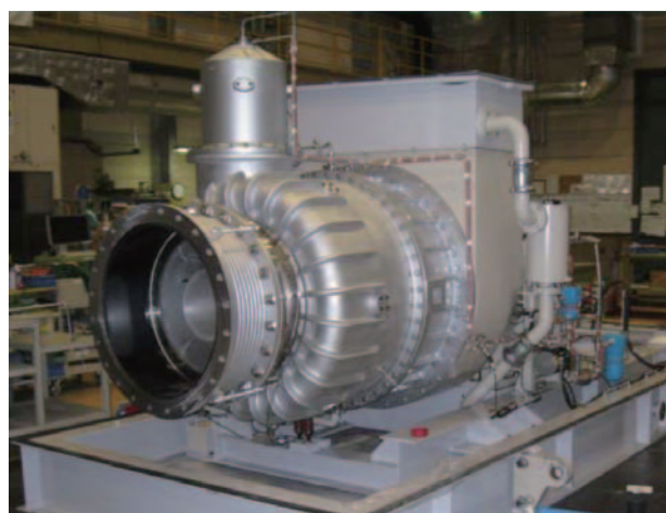
図1 NGT3B-S型ガスタービン外観
