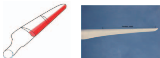
(a). Heater mat (b). ブレードの装着された加熱システム
