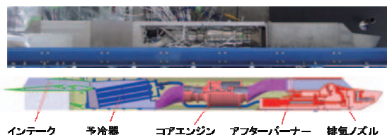
図3 飛行実証用極超音速ターボジェットエンジンの構成 (上：外観写真、下：断面図)
