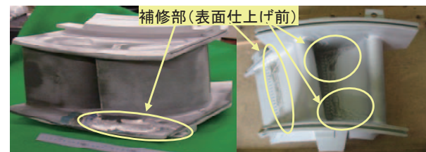
図12 拡散ろう付け補修静翼（表面仕上げ前）
