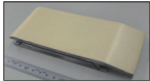
図11 シュラウドセグメント内輪への高性能遮熱コーティング適用
