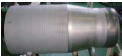
図13 クーポンリペアによる燃焼器部品修理例
