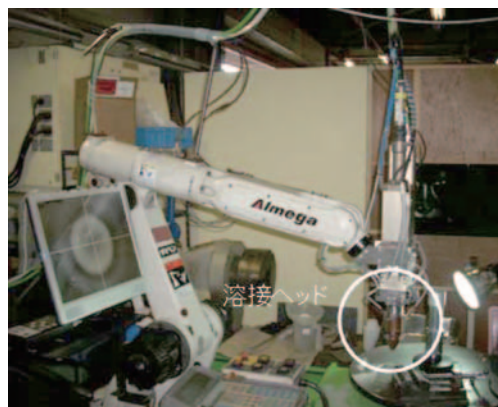
図6 翼先端部の補修試験に用いた装置外観
