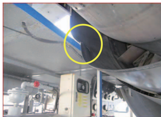
図1-1 給油車両と接触して損傷した排気ノズル
