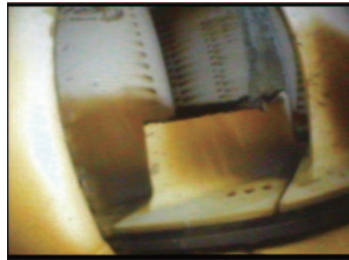
図8 エンジンメーカーからの緊急通知で発見されたPW4000 高圧タービン第1段ブレードの破損状況
