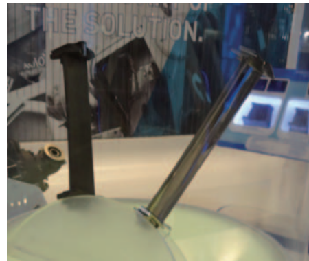
図5 Avio社のTiAl翼の試作品、 (左) 積層・焼結後、(右) 機械仕上後
