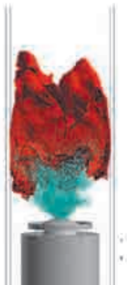
瞬間ガス温度の等値面と 燃料液滴の分布 (本文 図2 参照)
