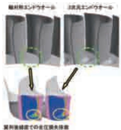
図18 非対称エンドウォールによる2次流れ損失低減
