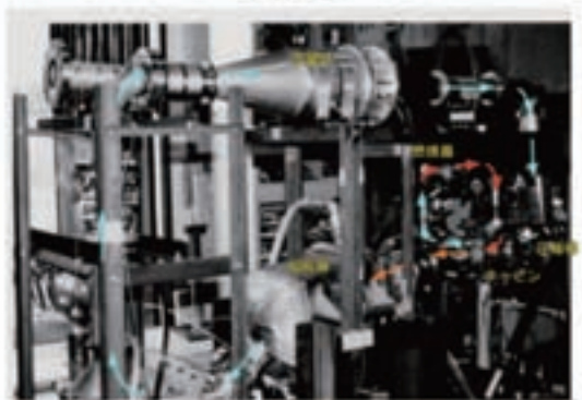
水素-酸素を燃焼媒体で燃焼、作動媒体：アルゴン、定格出力：23.5kW、 定格回転数：96,000rpm、圧力比：3.8
