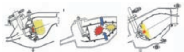
図5 低NO x 燃焼方式概念、左から部分希釈、部分過濃、急速混合 11)
