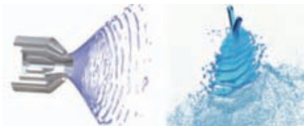
図3 二相流コードによる微粒化現象の数値解析例 (左) 旋回流型液膜微粒化の数値解析 (右) 流体解析と離散粒子法による衝突液膜微粒化解析
