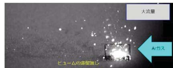
(a) Arガス流量によるヒューム除去性の差異
