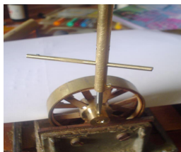
roue serrée dans l'étau
