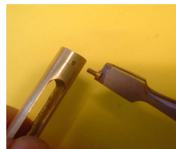
face meulée, tête de vis coincée entre les 2 faces
