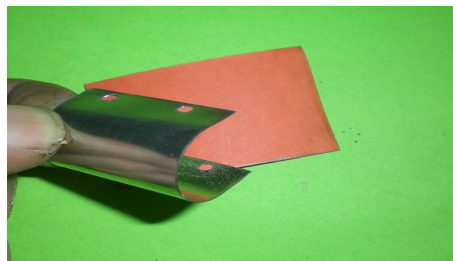
Gabarit, découpe aux ciseaux, perçage.
