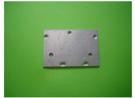
Plaque de support : fraisage sur l'envers pour vis à tête fraisée.
