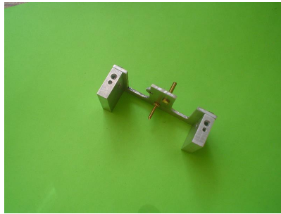
Montage des flancs et de l'axe du levier (vis M1.6).
