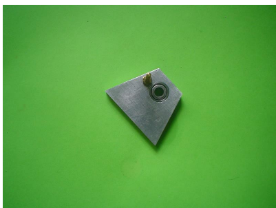
Roulement et axe du pignon de 10 dents (vis M2).
