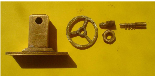
2 plats de laiton et carré de 10x 10 pour le corps pièce d'horlogerie pour le volant
