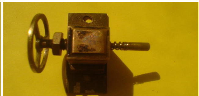
en vissant le volant, on appuie sur le ressort qui déplace le téton qui va plaquer le cylindre sur le bloc d'alimentation un écrou permet le blocage
