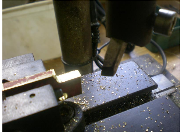
Les extrémités peuvent être sciées puis limées ou mieux réalisées à la fraiseuse;
