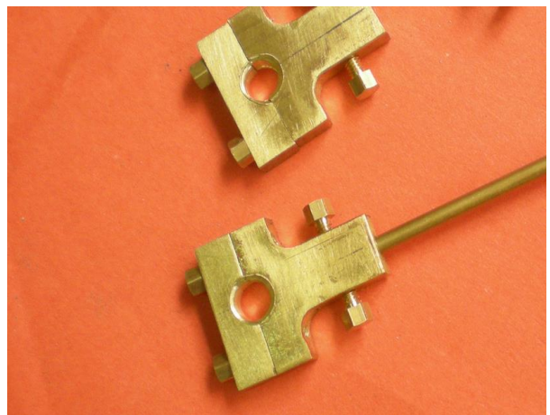
Perçage, taraudage et nos deux chapes sont terminées.
