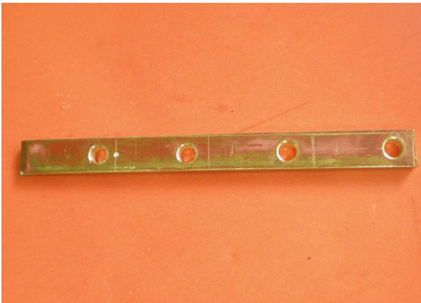
Traçage large en longueur et perçage d'un trou de diamètre 4.
