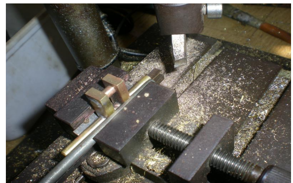
Le premier côté du vilebrequin est placé verticalement pour la réalisation du plat de liaison.
