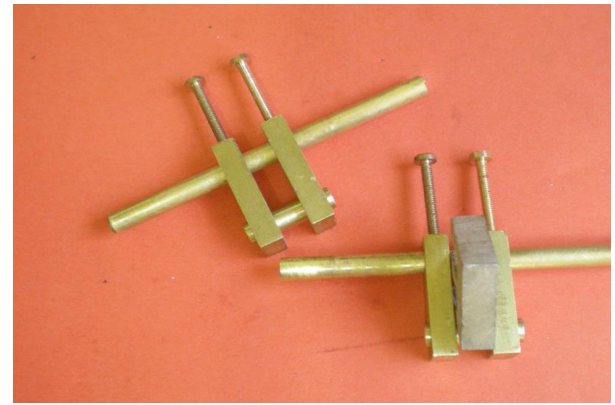
Perçage et taraudage à M2. Cale pour le réglage de la cote de 5.
