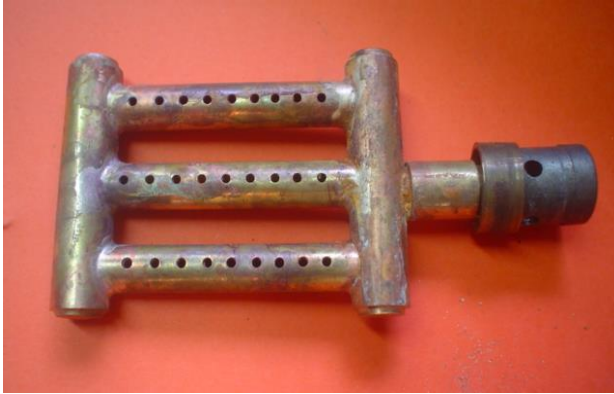
brûleur avec 3 tubes et le porte-gicleur de camping-gaz pour les essais
