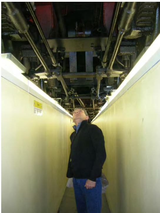
Une autre grosse locomotive à vapeur, 3 cylindres est visitable depuis une fosse très bien éclairée. « Tiens, la bielle motrice du cylindre intérieur n'est pas présente ! ».
