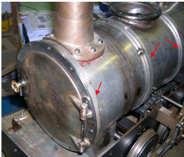
Photo 1 : mise en place des cerclages inox sur corps cylindrique.
