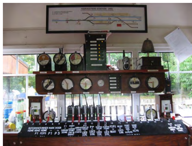
Un sympathique poste d'aiguillage, avec des manettes et des contrôles d'aiguilles et de signaux à faire baver d'envie Pierre et Jean-Pierre Vankerckhove du PTVF... Notez la petite potence avec ses signaux mécaniques.
