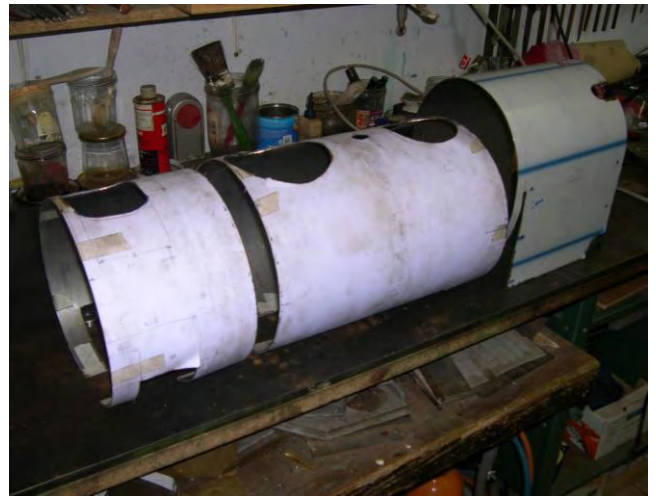
Photo 7 : les 3 tôles enveloppes usinées.
