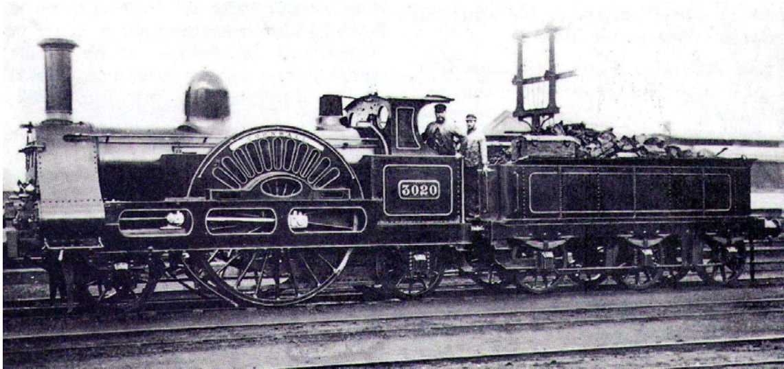
Photo 2 : 1850 – Locomotive « Cornwall » à roues motrices de 2,59 m.
