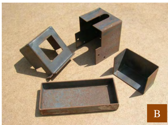
A) Pliages d'équerre simples aux cotes demandées. B) Pliage d'un morceau de tôle pour confectionner, d'un seul tenant, des capots simples ou complexes (ouvertures réalisées avant pliage !). Soudure autogène au chalumeau sur les angles extérieurs.
