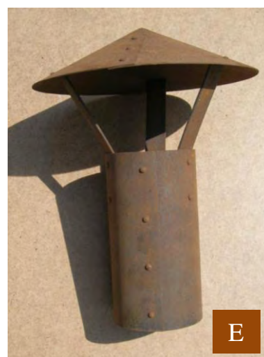
C) Bordage de tôles planes sur fil clair et bordage creux. D) tube carré confectionné par soudure autogène de 4 bandes de tôle. Pliage de cornière et assemblage de renforts d'angle par rivetage à froid. Assemblage de T et brides diverses sur tôle pliée. E) Cheminée et son chapeau (en partant de tôles planes formées au maillet sur bigorne), tout riveté par rivets d'acier.
