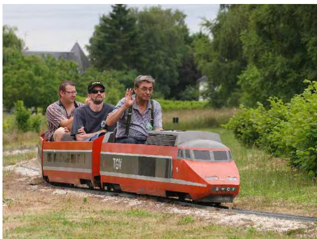
Photo 1 : rame TVG à moteur Diesel bicylindre et transmission hydraulique du CVDP.
