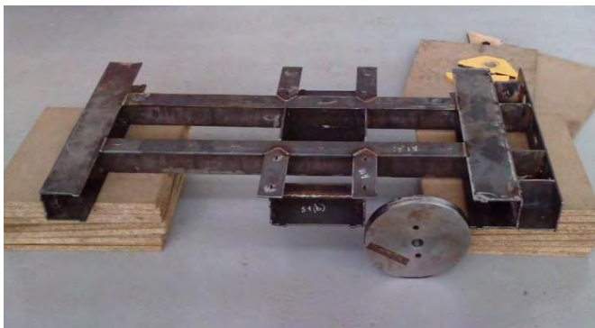
Photo 8 : début de soudure du châssis au MIG.
