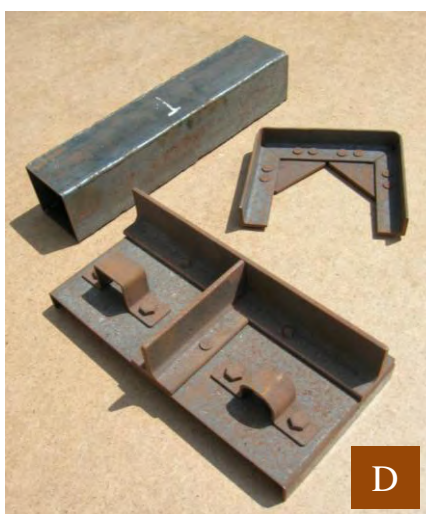
C) Bordage de tôles planes sur fil clair et bordage creux. D) tube carré confectionné par soudure autogène de 4 bandes de tôle. Pliage de cornière et assemblage de renforts d'angle par rivetage à froid. Assemblage de T et brides diverses sur tôle pliée. E) Cheminée et son chapeau (en partant de tôles planes formées au maillet sur bigorne), tout riveté par rivets d'acier.
