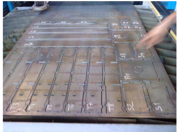
Photos 2 à 5 : découpe à la torche plasma des éléments constitutifs du châssis.
