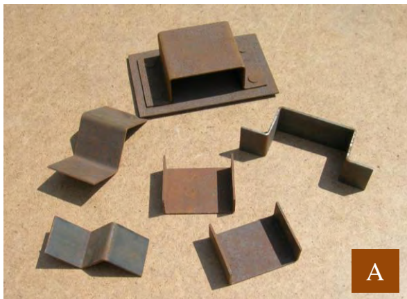
A) Pliages d'équerre simples aux cotes demandées. B) Pliage d'un morceau de tôle pour confectionner, d'un seul tenant, des capots simples ou complexes (ouvertures réalisées avant pliage !). Soudure autogène au chalumeau sur les angles extérieurs.
