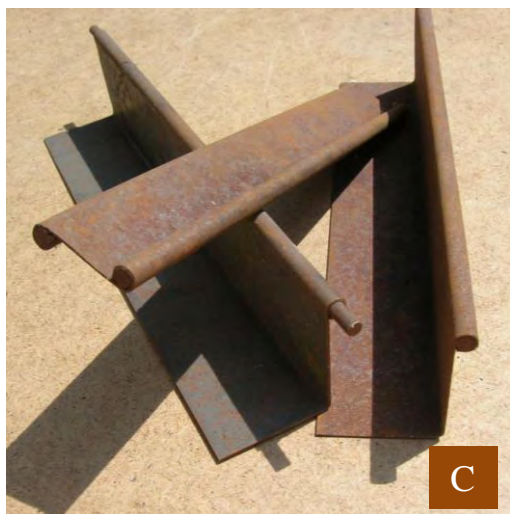
C) Bordage de tôles planes sur fil clair et bordage creux. D) tube carré confectionné par soudure autogène de 4 bandes de tôle. Pliage de cornière et assemblage de renforts d'angle par rivetage à froid. Assemblage de T et brides diverses sur tôle pliée. E) Cheminée et son chapeau (en partant de tôles planes formées au maillet sur bigorne), tout riveté par rivets d'acier.
