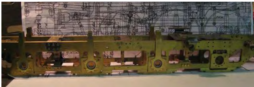
Un châssis moteur assemblé, boîtes d'essieux dans leurs glissières.
