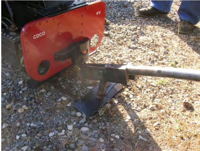
Position de l'outillage avant levée de la machine. Remarquez, avec la photo précédente, la forme du bec de levage adaptée à la forme du tampon unique et central. Photo de droite : Jacques MION à l'œuvre. Photos Alain Bersillon.
