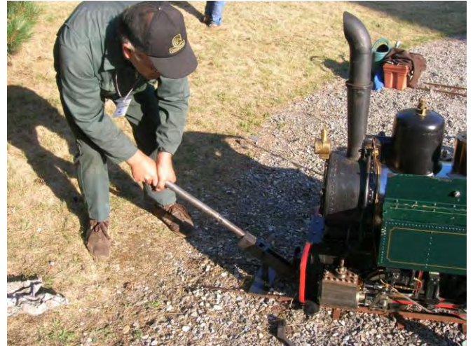
Position de l'outillage avant levée de la machine. Remarquez, avec la photo précédente, la forme du bec de levage adaptée à la forme du tampon unique et central. Photo de droite : Jacques MION à l'œuvre. Photos Alain Bersillon.
