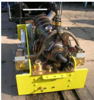
Une 110 expérimentale, chauffée au gaz, construite par Rudy MEMIN.
