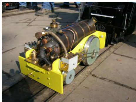
Une 110 expérimentale, chauffée au gaz, construite par Rudy MEMIN.
