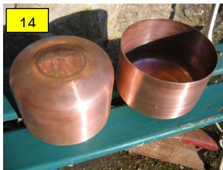
Photo 15 : assemblées, les deux pièces constitueront un réservoir pour une automobile à vapeur.
