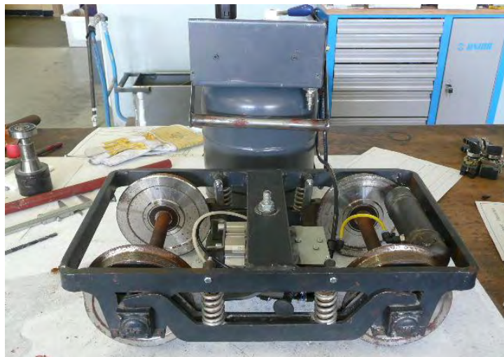
Le bogie freiné, devant une bonbonne d'alimentation en air comprimé, surmontée d'un pupitre de commande du frein, pendant les tests de fonctionnement. Photos Pierre Sitarski.
