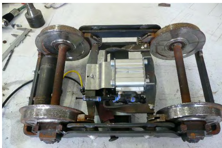
A gauche, le piston de frein à double effet (matériel du commerce). A droite, l'ensemble piston de frein et son palonnier installés dans un bogie de conception Luc Teenstedt. On remarque à gauche, parallèle au corps d'essieu, le petit réservoir de commande en acier.
