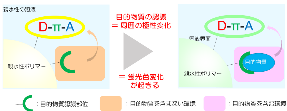
図 15. 水中でも蛍光発光を利用できる化学センサー開発の予想図
