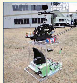
図1 提案のシングルロータヘリコプター（下側は搭載したペイロード）
