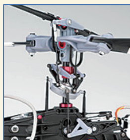
図4 シングルロータのロータヘッド部
