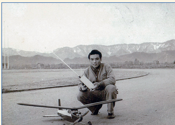
図5 1954年製作のラジコン機 第1号. 送信機, 受信機共真空管を使用
