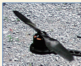
図5 プロペラとモータが直結されたマルチロータ型のロータブレード部
