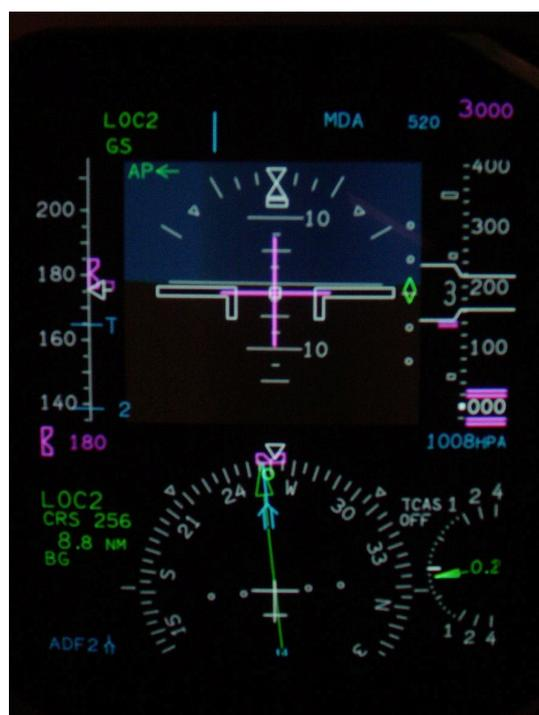
L'information localizer est matérialisée sur le HSI par un segment vertical de couleur verte sur une échelle horizontale graduée de - 2,5 à 2,5 points. Lorsque la hauteur de l'avion est inférieure à six cents pieds sol, une représentation dilatée du localizer apparaît sur la partie basse de l'ADI sous la forme d'un losange cyan.
