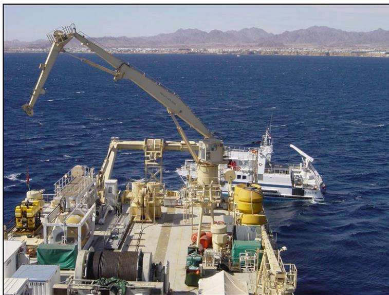
**Figure 15 : travail en positionnement dynamique des deux bateaux**
