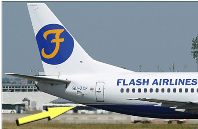
*Figure 11 : zone d'installation des enregistreurs*
