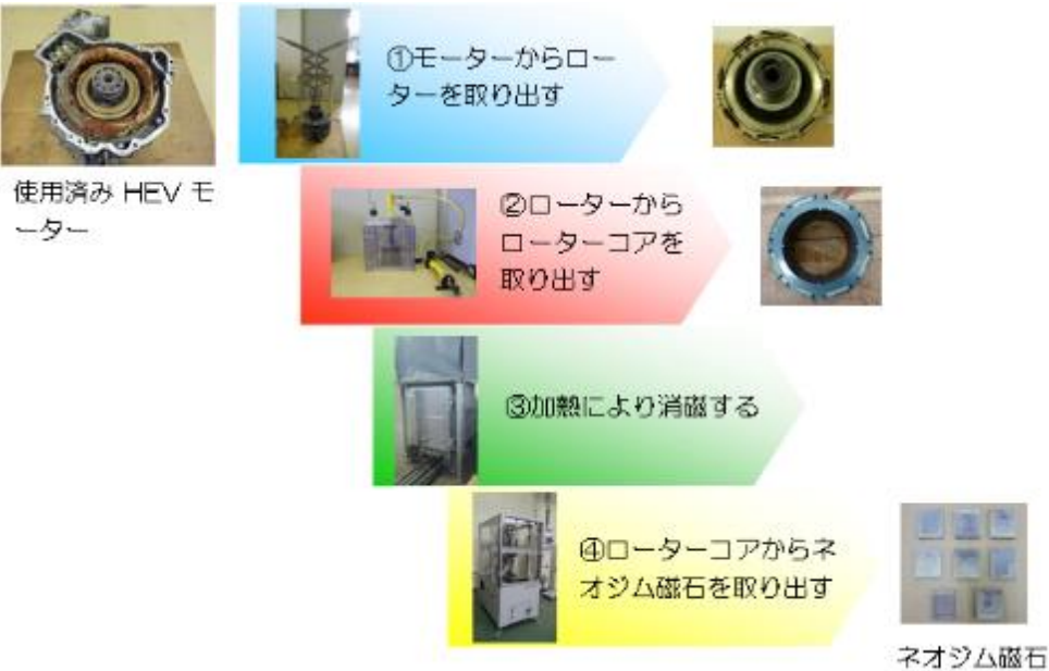
ネオジム磁石を取り出すフロー図
