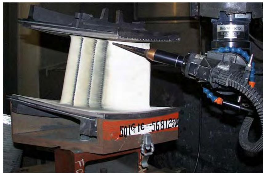
(バックプロテクトが必須のため、タービン動翼は放電加工で穴あけを行います。)
