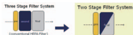
図8 2段式HEPAフィルター
