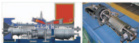
Fig.21 H-80ガスタービン (断面図・ケーシング開放)
