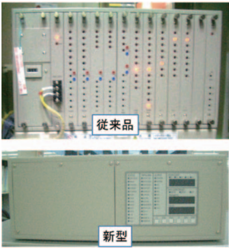
Fig. 21 新旧エンジン制御装置の外観
