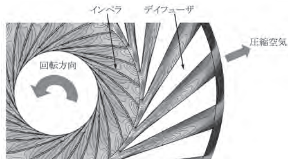
注：遠心圧縮機の CFD 一体解析によって得られた相対マッハ数分布であり、通路内での流れの減速過程が確認できる。
