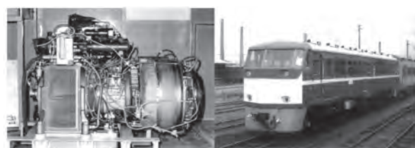
注：ヘリコプター用として定評のあるライカミング製 T53 型ガスタービンの航転型で、改造したディーゼル気動車に搭載して走行試験を実施
