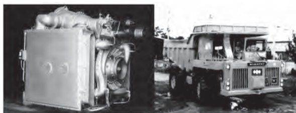
注：小松製作所が建設機械の動力源として開発した 440kW 級ガスタービンで、ダンプトラックに搭載して試験を実施
