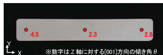
図4 試作単結晶板材の断面マクロ組織観察および結晶方位測定結果
