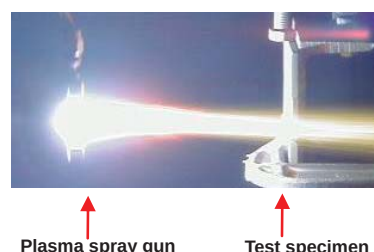
図 5 試作セラミックス粉末の溶射成膜状況
