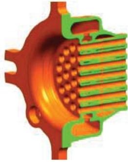
図2 高濃度水素用多管予混合型噴射器の断面見取り図 14)
