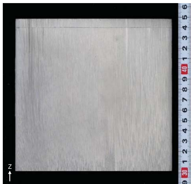
図3 試作単結晶板材のマクロ組織観察
