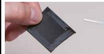
Placez le panneau latéral gauche de la monoque à son emplacement sur le côté de la monoque et tenez les pièces ensemble de 2 à 3 minutes afin de laisser la colle sécher.
