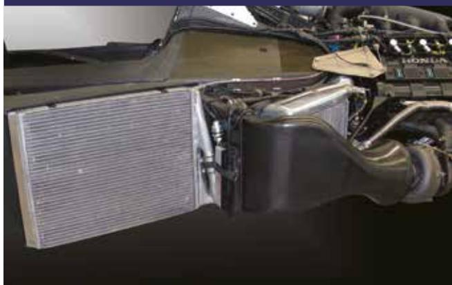
Lors de la compression de l'air dans le moteur, le turbocompresseur en augmente aussi la température. L'intercooler fait baisser la température de l'air avant que celui-ci n'entre dans le moteur et en augmente la densité. Cela améliore l'efficacité de la combustion du moteur, et donc la puissance. Les intercoolers de ce modèle sont fabriqués en métal découpé afin d'avoir une apparence de poids et de réalisme.
