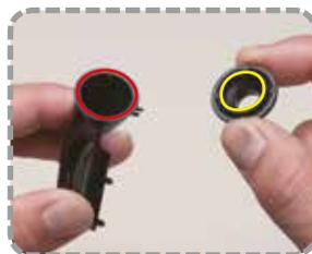
Introduisez la partie cerclée en jaune de l'adaptateur de l'entrée d'air du turbocompresseur dans l'extrémité de l'entrée (cercle rouge). Alignez la marque d'union à la carotte de l'adaptateur (flèche bleue) et les deux saillants cerclés de l'entrée d'air.
