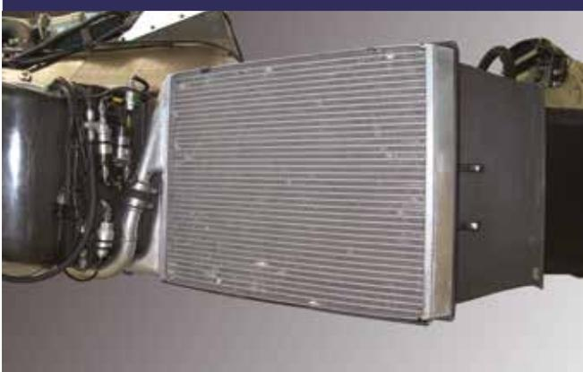
Le système de refroidissement du moteur Honda RA 168E V6 de la MP4/4 était constitué de deux radiateurs, un de chaque côté de la ligne des cylindres, et de deux pompes à eau, une de chaque côté du carter.
