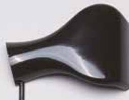
Extérieur de l'entrée d'air du turbocompresseur (droit)
