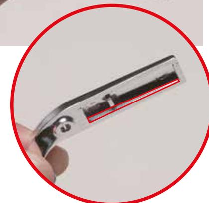
Décapez la peinture sur les premiers 3 mm à l'intérieur de la section en U de la partie inférieure de l'intercooler.
