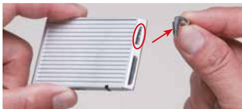
Appliquez la colle à l'intérieur de la fente cerclée en rouge sur le radiateur, puis remettez en place la sortie et appuyez. Tenez les pièces assemblées pendant quelques minutes.
