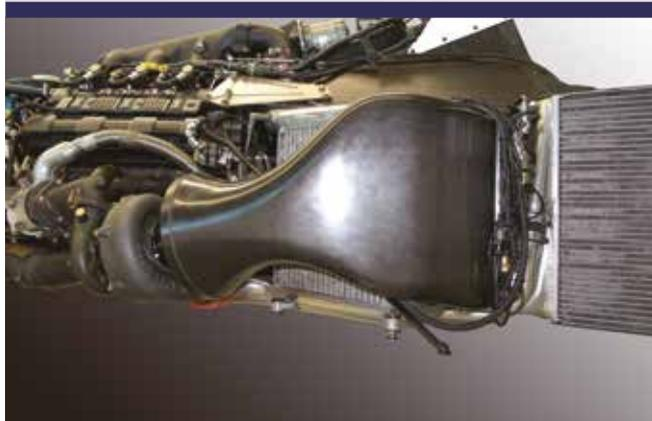
La MP4/4 commença la saison de 1988 avec des durites d'entrée du turbo en forme de périscope, qui dépassaient de chaque côté de la capsule centrale. Elles devaient optimiser le flux d'air des turbocompresseurs sur des circuits lents et sinueux comme celui de Monaco, et sur des circuits en hauteur et à des températures élevées comme celui de Mexico. Elles furent néanmoins remplacées par des conduits à l'intérieur des capsules latérales à la mi-saison.
