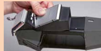
**3** Fixez provisoirement la protection du radiateur droit et la base de la protection du radiateur et reprenez les pas 1 et 2 afin de vous assurer que la protection s'assemble bien sur le côté droit de la monocoque.
