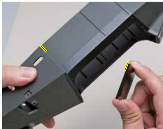
Tout en tenant le panneau latéral et en vous aidant du crayon mécanique, marquez soigneusement le contour des bords (ici en bleu) sur le côté de la monocoque.
