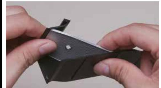
Déposez de la colle plastique dans l'orifice cerclé en rouge sur la protection du radiateur.
