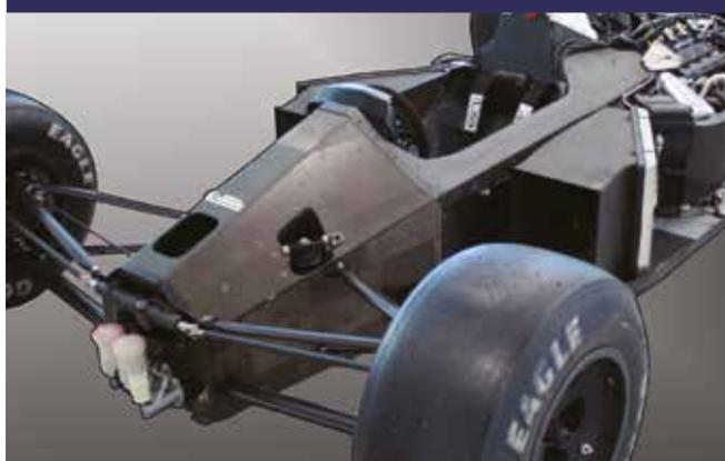
La monocoque en fibre de carbone de la MP4/4, très résistante malgré sa légèreté, a été dessinée en pensant au rendement de la voiture et à la sécurité du pilote. La monocoque de ce modèle vous permet d'avoir une idée assez claire de la texture de la surface de la coque sur la voiture réelle.
