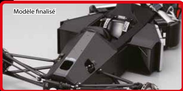
Sur l'image les deux protections du radiateur se trouvent de part et d'autre de la cabine.
