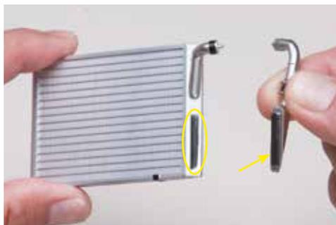
Appliquez la colle à l'intérieur de la fente cerclée sur le radiateur. Ensuite remettez en place l'entrée et tenez les pièces assemblées pendant quelques minutes.
