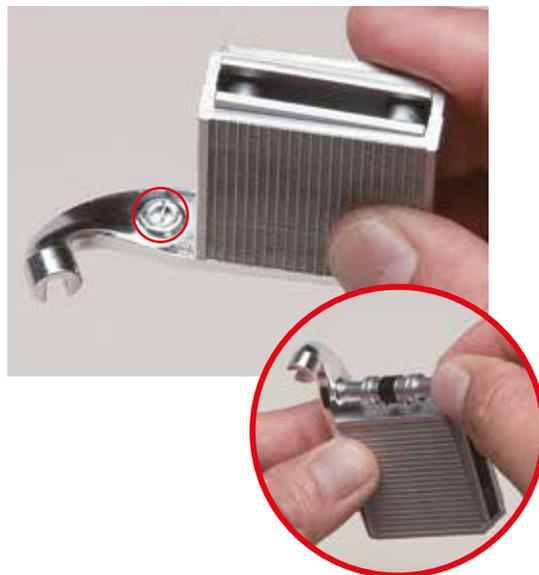
Déposez une petite quantité de colle instantanée sur les zones découpées précédemment (flèches) de la partie supérieure de l'intercooler. Assemblez ensuite la partie supérieure de l'intercooler, et tenez les pièces unies afin de laisser sécher la colle.
