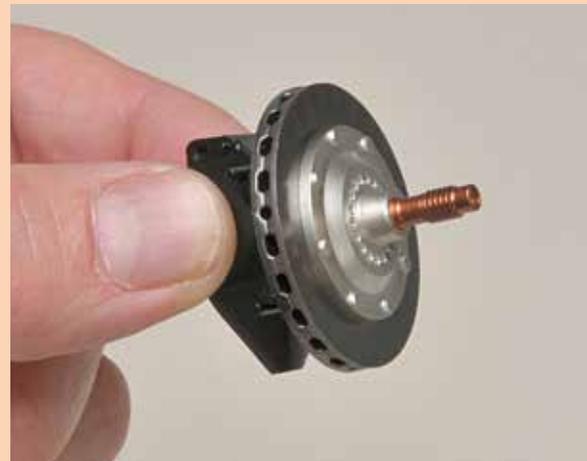
**3** Placez la première bride du frein sur le bord du disque et contre le montant avant. Les orifices marqués en rouge correspondent aux saillants (flèches) et le trou central (lignes bleues) reste sur le disque.
