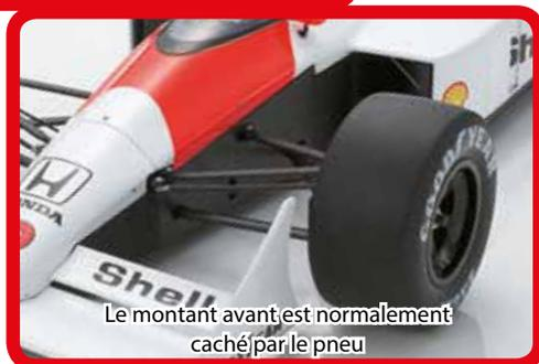
Le montant avant est normalement caché par le pneu
