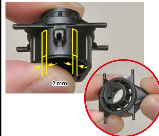
Appliquez de l'adhésif plastique autour de l'intérieur de l'assemblage du montant avant sur 2 mm juste sous le bord, en jaune sur l'image ci-dessous.
