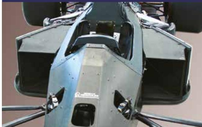
Les protections du radiateur sont montées de chaque côté de la voiture et restent normalement cachées dans les réceptacles latéraux. Leur structure et leur forme jouent un rôle dans le refroidissement du moteur car elles apportent de l'air avec les intercoolers et radiateurs.
