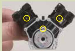
**2** Dévissez les points cerclés en jaune. Gardez l'avant du bloc moteur en place. Ensuite, dévissez les points cerclés en rouge tout en tenant les disques d'embrayage et la protection en place.
