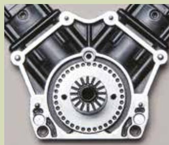
**8** Appliquez une couche sur la zone entourée de bleu du disque du frein et sur l'extrémité du palier (flèche rouge).
