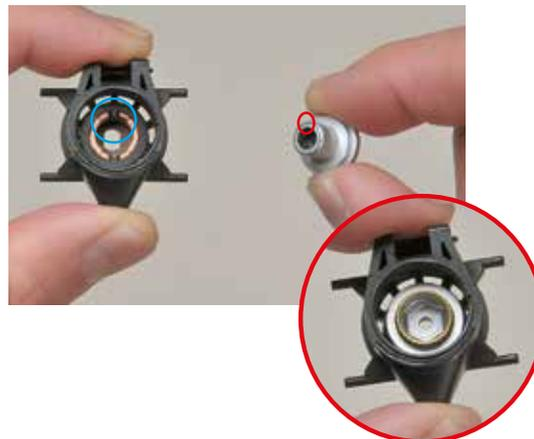
Introduisez l'extrémité du palier dans le trou cerclé de bleu sur l'intérieur du porte-moyeu en alignant d'abord les deux côtés plats des deux pièces (flèches jaunes). Enfoncez le porte-moyeu dans l'orifice de la partie extérieure du porte-moyeu avant.
