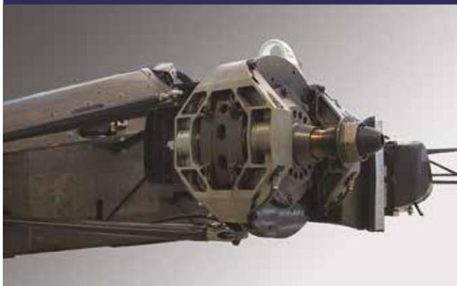
Les montants avant sont des éléments fondamentaux de la suspension avant et des structures supportant les moyeux et les freins.
