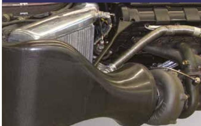
Les intercoolers, montés près de l'arrière des protections gauche et droite du radiateur, réduisent la température élevée de l'air alimentant le moteur à travers le turbocompresseur. Sur votre modèle l'intercooler est en métal moulé sous pression et en HIPS (polystyrène choc).
