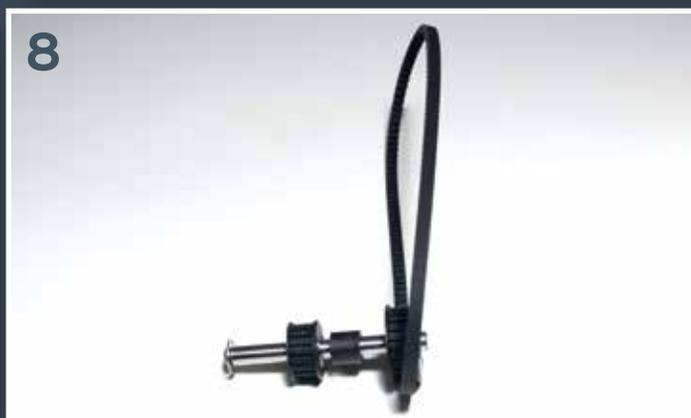
**3** Introduisez le boulon de transmission dans l'orifice proche de l'extrémité de l'arbre, comme sur l'image.
