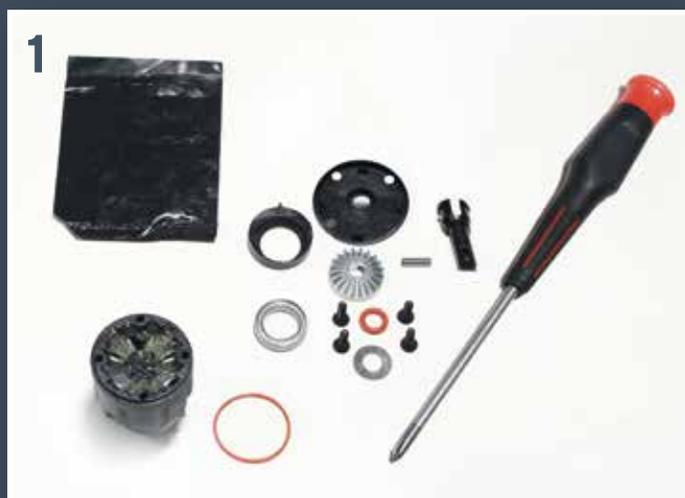
**1** Dans cette étape vous aurez besoin des nouvelles pièces, de l'assemblage déjà réalisé du différentiel avant (étape 13), du sachet de graisse et d'un tournevis Phillips.
