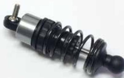
**15** Vissez maintenant le couvercle supérieur sur l'extrémité supérieure du corps de l'amortisseur. Appuyez juste ce qu'il faut pour que le diaphragme soit scellé et qu'il n'y ait pas de fuite d'huile.
