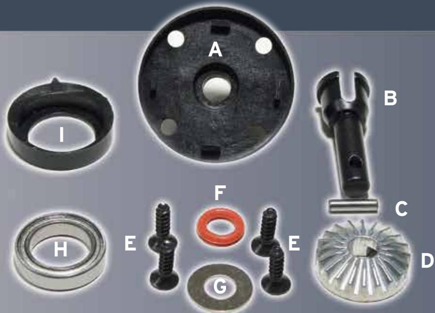
Les pièces fournies dans cette étape vous permettront de compléter le mécanisme intérieur du différentiel avant de votre Huracán. Vérifiez à la fin de l'étape que les engrenages du mécanisme tournent sans résistances. Si ce n'est pas le cas il est probable que vous ayez trop serré les vis de l'embouchure du boîtier : desserrez-les juste un peu et le mouvement des engrenages sera plus facile et doux.
