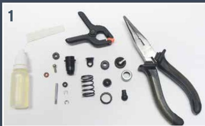
**1** Vous aurez besoin de l'ensemble des pièces de l'amortisseur de ce pack, de l'huile fournie dans l'étape 2, d'une pince en pointe, d'une pince de modélisme et d'une bande fine de tissu ou de carton.
