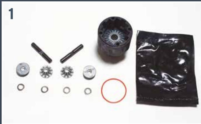
**1** Outre les nouvelles pièces, vous aurez besoin du différentiel avant, partiellement monté, du joint torique et du sachet de graisse de l'étape 10.
