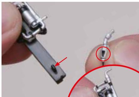
Retirez le capteur de la vanne après vérification.
