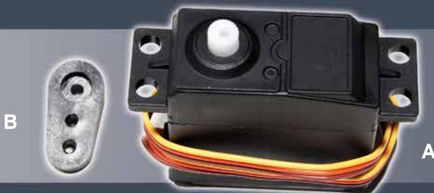
Les pièces fournies dans cette étape sont le deuxième servo de votre modèle et son bras. C'est un servo identique à celui fourni dans l'étape 43 et il est donc interchangeable jusqu'à son installation. L'un devient alors le servo de direction et l'autre le servo de l'étrangleur / frein. Comme vous ne pouvez pas encore installer les servos, cette étape vous explique comment les ajuster avant de les placer.
