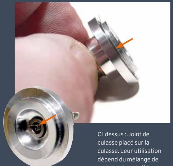
Ci-dessus : Joint de culasse placé sur la culasse. Leur utilisation dépend du mélange de carburant souhaité.
