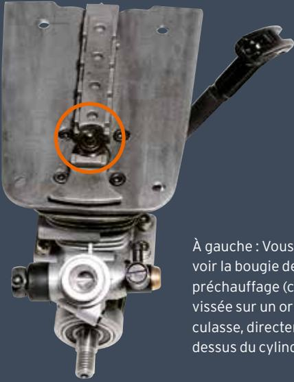
À gauche : Vous pouvez voir la bougie de préchauffage (cerclée) vissée sur un orifice de la culasse, directement au dessus du cylindre.
