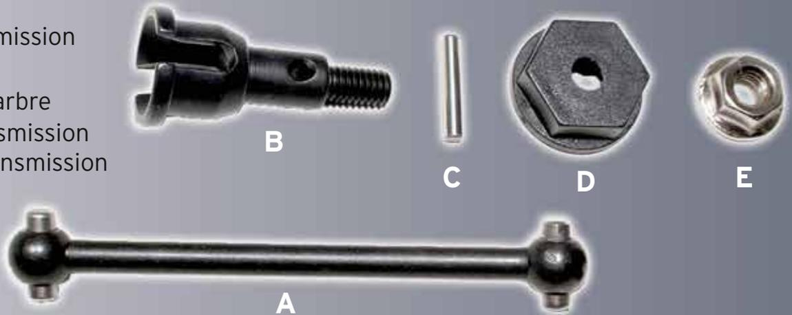
L'arbre de transmission, l'extrémité de l'arbre et les autres pièces fournies dans cette étape sont interchangeables avec celles fournies dans les étapes 21 et 36. Si vous avez suivi la séquence de l'assemblage, utilisez ces pièces pour la roue arrière gauche, car les autres jeux auront été utilisés pour les roues arrière droite et avant gauche.
