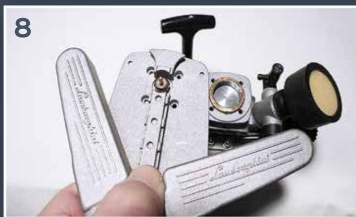
**3** Repérez les orifices indiqués sous les couvre-culasses. Ils devront être alignés aux orifices correspondants de la culasse. Les vis fixant les pièces y seront installées.
