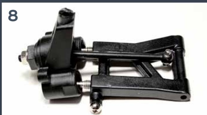
**3** Introduisez les extrémités des vis à bille du porte-moyeu arrière dans les orifices du bras inférieur et commencez à les serrer.
