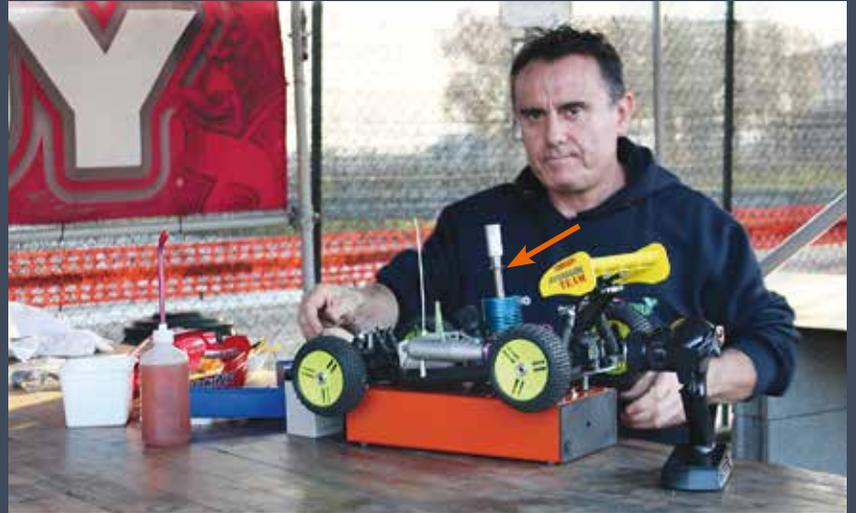
Ci-dessus : Un modèle RC en préparation. Le démarreur de la bougie (flèche) reste visible par dessus le haut du moteur.
