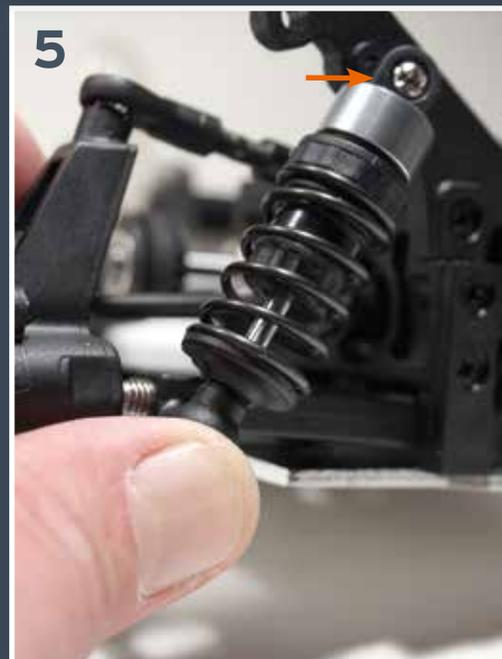
**2** Unissez le support de l'amortisseur arrière aux supports de la suspension arrière avec deux vis autoforeuses de 3 x 10 mm.
