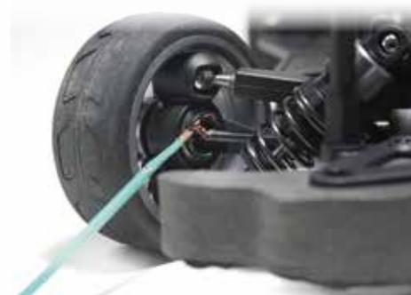
En déposant un peu de graisse de cuivre autour des extrémités des moyeux avant vous obtiendrez une direction adoucie et une friction minimale.
