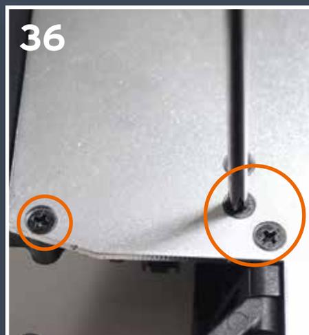
**32** Fixez le support du servo sur la plaque du châssis avec les vis retirées dans le pas 9.
