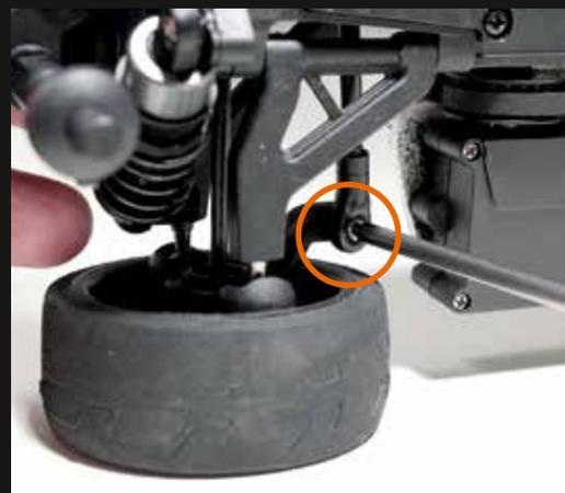
Les connexions entre les amortisseurs et les bras de direction sont soumises à des tensions importantes une fois le modèle en marche. Les vis peuvent se desserrer. Serrez bien fort les vis indiquées avant de démarrer.
