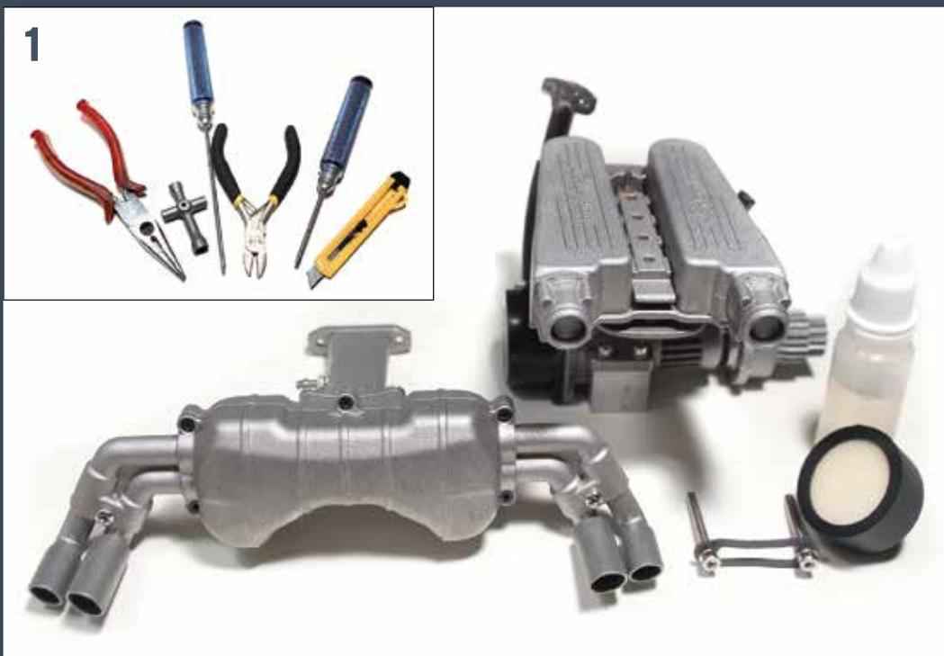
**1** Après avoir assemblé la quatrième roue, préparez le moteur (retiré dans l'étape 67), le système d'échappement, les vis et rondelles de 3 x 28 mm (étapes 28 et 39), le filtre d'air et le flacon d'huile (étape 46). Vous aurez aussi besoin d'une pince, d'une pince coupante, d'une clé serre-tube de 5,5 mm, d'un cutter, de clés Allen de 2 mm et de 2,5 mm et d'une bande de serrage courte (absente sur l'image).
