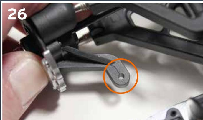
**26** Serrez les vis à bille dans les orifices des porte-moyeux (une de chaque côté).
