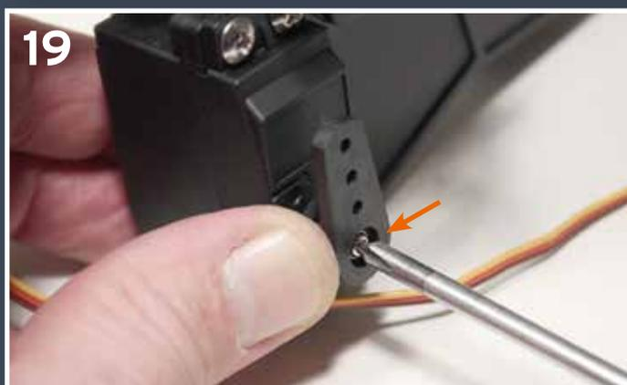
**14** Placez le servo de direction sur le support du servo en faisant glisser les écrous dans les rainures indiquées du support.
