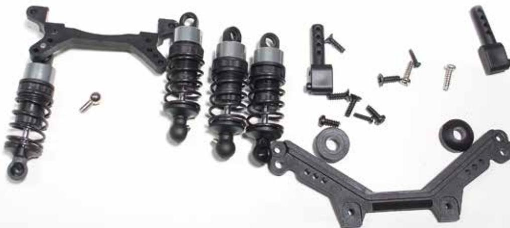
**1** Avant de commencer vous aurez besoin de l'assemblage principal, d'un tournevis Phillips, des supports des amortisseurs avant et arrière, des trois amortisseurs montés dans des étapes précédentes et de celui que vous venez de monter, ainsi que des vis de l'étape 7.
