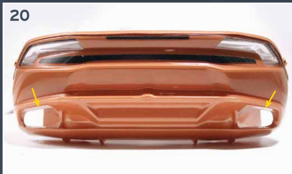
**19** En outre, afin de permettre la circulation d'air dans le moteur vous devrez percer une série d'orifices sur le capot du moteur (voir les flèches). Voilà à quoi devrait ressembler l'arrière après avoir installé les phares arrière et pratiqué les ouvertures.
