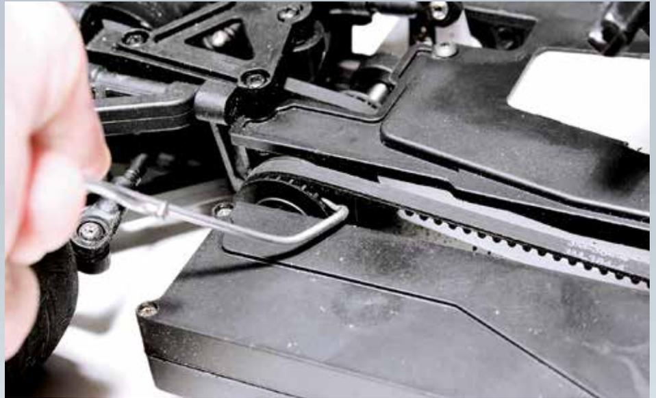
Le nettoyage régulier des poulies avec l'outil dédié permet de garder l'efficacité du système de transmission
