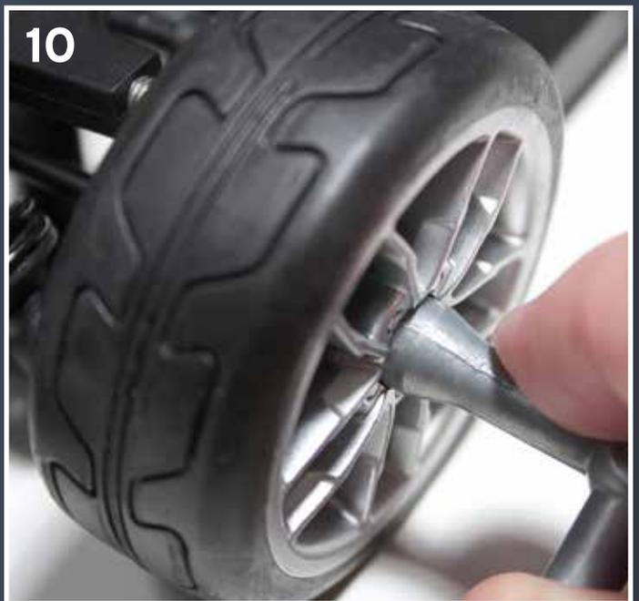
**10** Placez la roue sur la rondelle de transmission hexagonale et serrez ensuite l'écrou à bride à nouveau à l'extrémité du moyeu avec une clé serre-tube de 5,5 mm.
