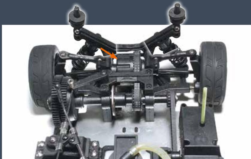
Extrémité arrière du châssis de votre Huracan RC. La flèche indique l'emplacement du différentiel arrière.
