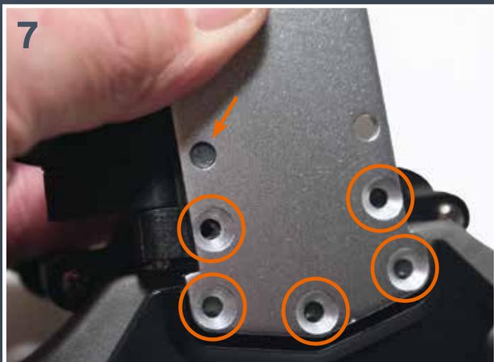
**7** Situez l'extrémité avant de la plaque du châssis dans le creux correspondant sous le pare-choc. Alignez les cinq orifices cerclés et ceux du pare-chocs et introduisez le boulon de l'assemblage de la suspension à l'intérieur de l'orifice indiqué par une flèche.
