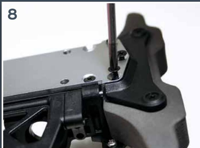
**8** Serrez les cinq vis autoforeuses (étape 9) dans les cinq orifices de la plaque du châssis afin d'y fixer le pare-choc.
