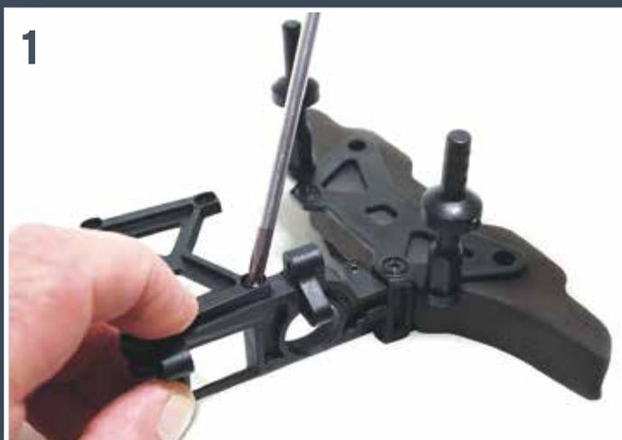
**1** Préparez le pare-choc et l'armature latérale avant droite de l'étape 9. Avec un tournevis Phillips dévissez la plaque supérieure de l'armature latérale.
