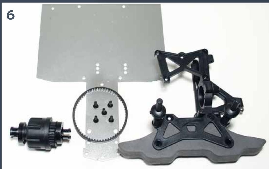
**6** Pour les pas suivants vous aurez besoin de l'assemblage de la suspension et du pare-choc sur lequel vous venez d'intervenir, ainsi que de la plaque du châssis de l'étape 25, cinq vis autoforeuses de l'étape 9 et du différentiel avant et sa courroie de transmission, de l'étape 15.
