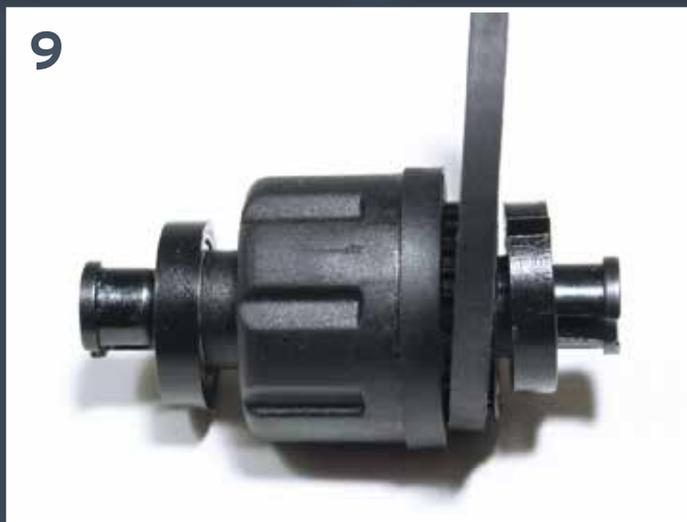
**9** Placez la courroie de transmission sur la poulie du différentiel avant.
