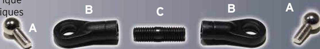
Les pièces fournies constituent le relais de la servo direction, l'arbre reliant la servo direction au reste du mécanisme de direction. Lorsqu'il fonctionne, le servo mécanisme pousse ou tire sur l'arbre afin de diriger la voiture. En poussant l'arbre la voiture tourne à droite, en tirant sur l'arbre la voiture tourne à gauche.
