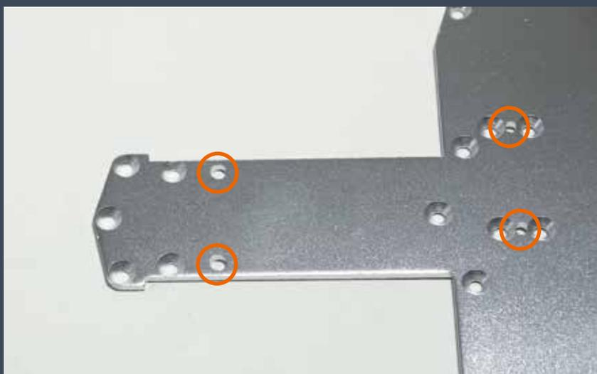
Ci-dessus : Extrémité avant de la plaque du châssis. Les orifices cerclés ne sont pas fraisés, car ils sont pensés pour tenir des passants en plastique et non pas des vis.
