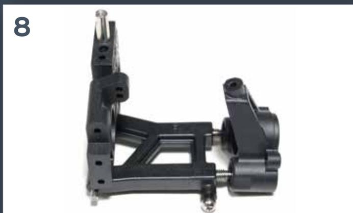
**3** Serrez la vis à tête sphérique dans l'orifice indiqué du bras inférieur arrière droit.
