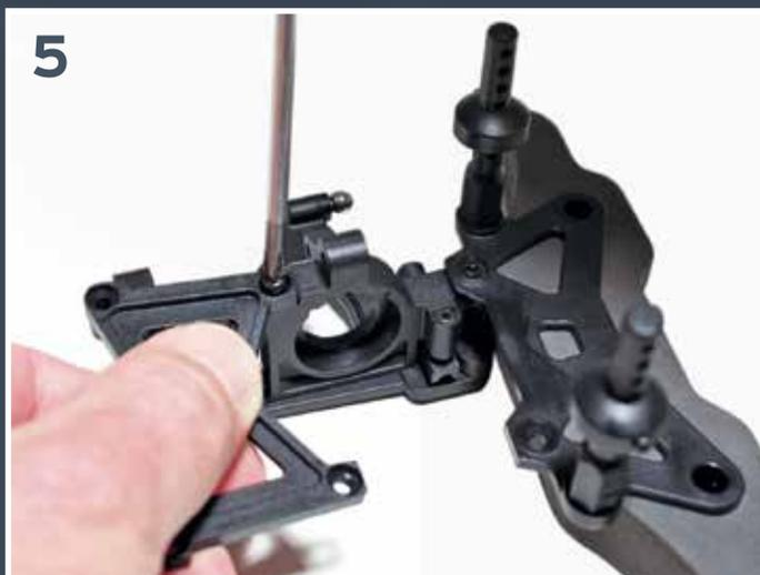
**4** Vissez l'assemblage de la suspension avant gauche sur l'assemblage du pare-choc avant, comme sur l'image.
