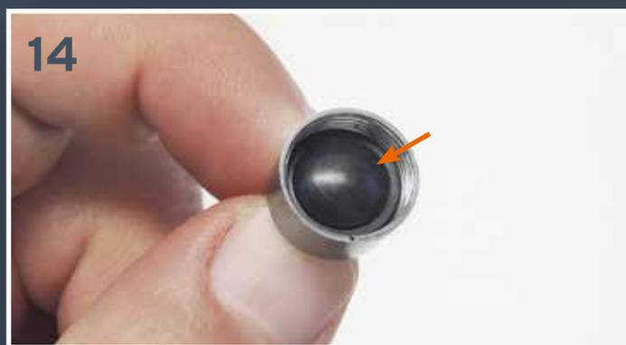
**9** Introduisez ce bout lubrifié dans l'orifice le plus large du corps de l'amortisseur. Enfoncez-le à travers la rondelle jusqu'à ce que le pas de vis ressorte de l'autre côté, comme sur l'image.
