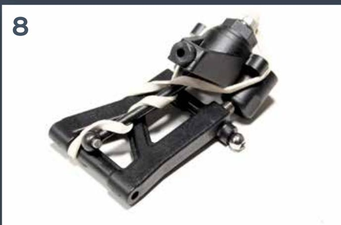
**3** Introduisez l'extrémité de l'arbre dans le support du moyeu.
