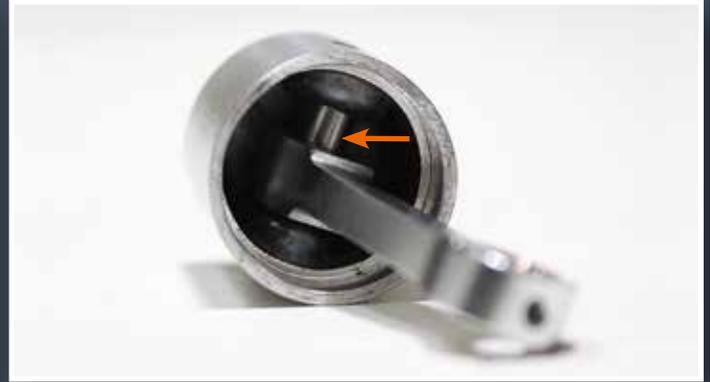
La bielle est unie à un boulon à l'intérieur du piston. L'autre extrémité de la bielle est unie au carter, qui soulève la bielle et le piston dans la chemise du cylindre.
