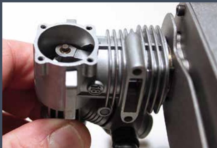
Voilà l'extrémité du carter sur laquelle sera fixée la plaque arrière du moteur de démarrage.
