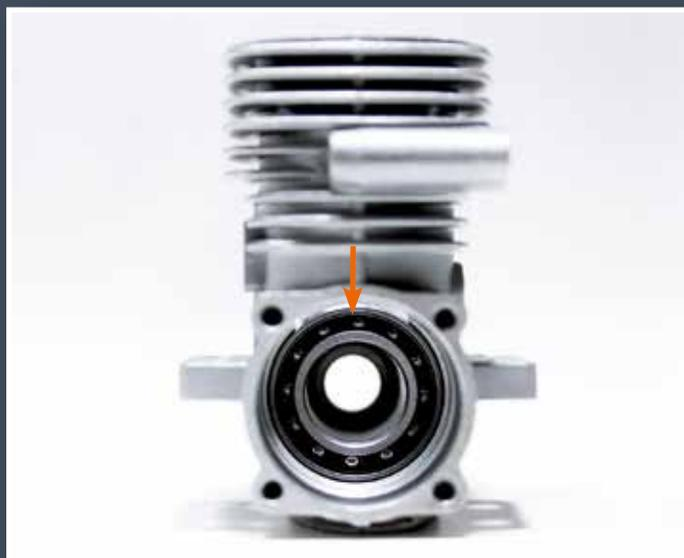
Ci-dessus : Vous pouvez voir le roulement principal non scellé et les 12 billes en acier. Le diamètre intérieur et extérieur est de 12 mm et de 20 mm respectivement.
