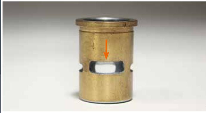
La quatrième ouverture latérale de la chemise du cylindre sert de sortie par laquelle sont expulsés les gaz d'échappement de la chambre de combustion.
