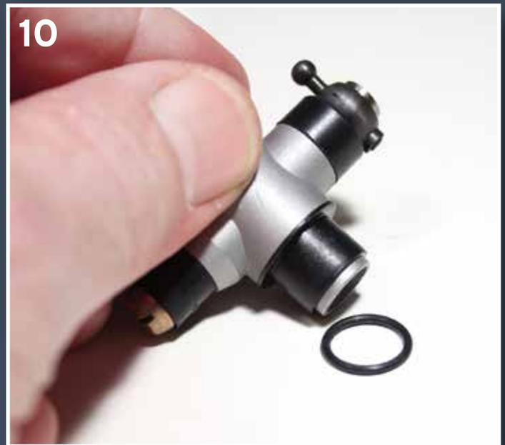
**7** La pointe de l'arbre couissant de l'accélérateur entre dans le distributeur se trouvant au milieu de l'extrémité étroite de la vis de mélange.
