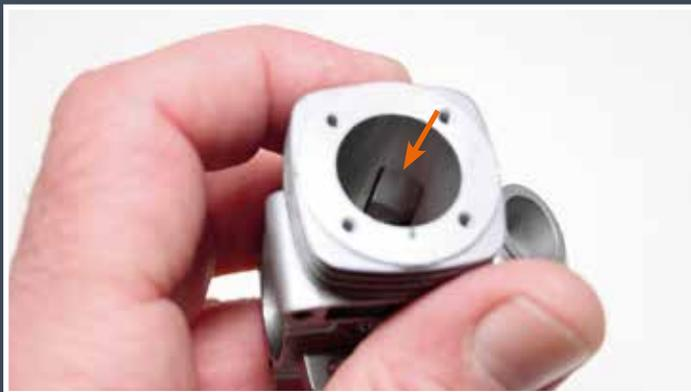
Le port d'entrée de l'autre côté du port d'échappement est plus étroit que les autres. La taille, la forme et la position de chaque conduit sont calculés pour optimiser le rendement du moteur.
