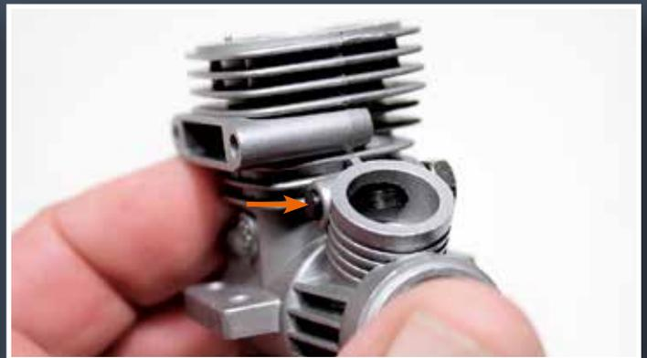
Si vous le souhaitez, vous pouvez faire passer le boulon d'union dans le carburateur par l'orifice indiqué et le fixer provisoirement en resserrant l'écrou.
