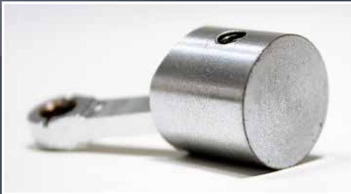
Le piston est en alliage d'aluminium. Le haut est totalement plat, comme sur la plupart des moteurs RC, car il est ainsi plus facile d'optimiser le volume dans la chambre de combustion, c'est-à-dire d'optimiser la puissance.
