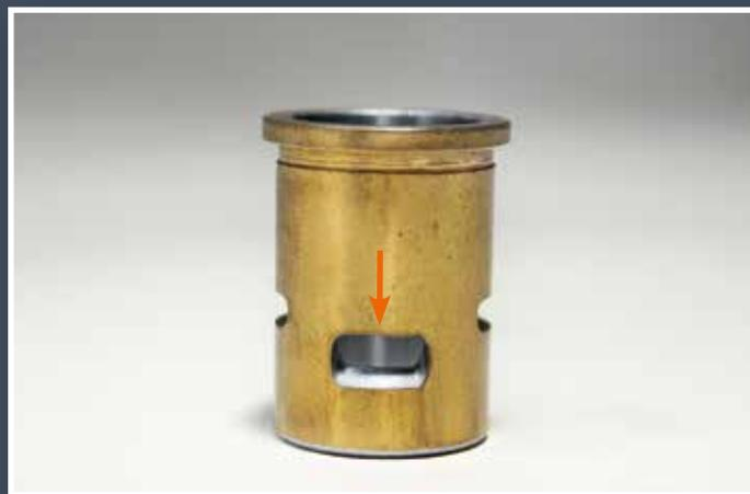
Quatre ouvertures latérales se trouvent sur la chemise du cylindre. Le mélange d'air et de carburant passe vers le carter dans l'ouverture indiquée ci-dessus. Elle est placée à l'opposé et légèrement plus bas que l'ouverture par laquelle sont libérés les gaz d'échappement.
