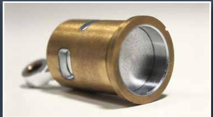
Le piston et la chemise du cylindre s'assemblent avec une très grande précision. Après avoir été soulevé, le piston s'arrête à quelques millimètres seulement du haut du cylindre.
