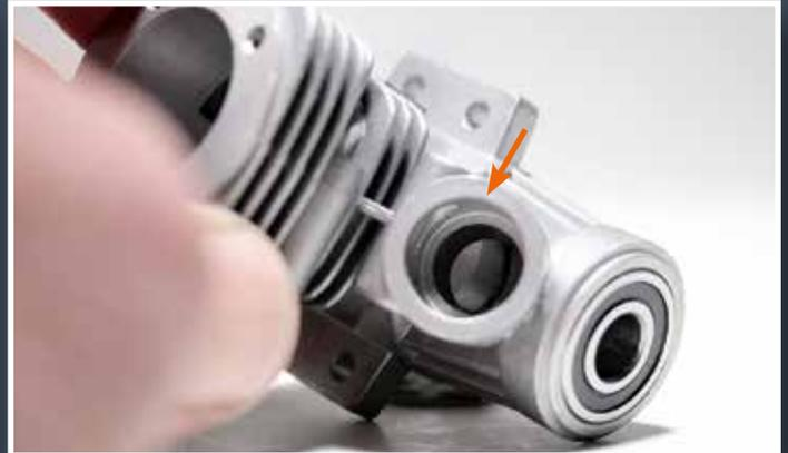
L'orifice indiqué est celui du support du carburateur, là où ce dernier sera assemblé. C'est l'ouverture à travers laquelle le mélange d'air et de carburant entre dans le moteur.
