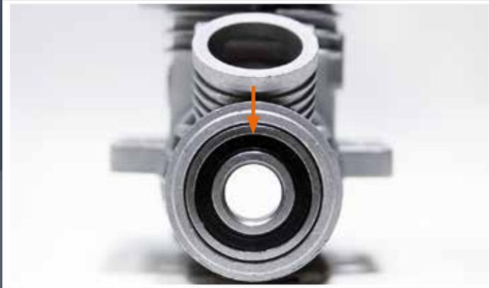
Le deuxième roulement à bille, située de l'autre côté du moteur, est muni de joints en caoutchouc et de sept billes en acier. Le diamètre intérieur est de 7 mm et l'extérieur est de 17 mm.
