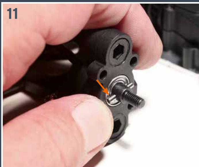
**11** Introduisez le boulon de transmission (étape 21) dans l'orifice sur l'extrémité de l'arbre. Veillez à le faire entrer bien au centre.
