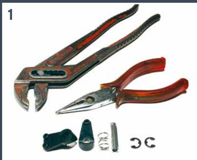
**1** Dans cette étape vous aurez besoin d'une pince en pointe et de toutes les pièces du couvercle de la servo-direction, à l'exception de la vis et de l'arbre intérieur. Il se peut que vous ayez aussi besoin d'une pince télescopique afin de comprimer le ressort.
