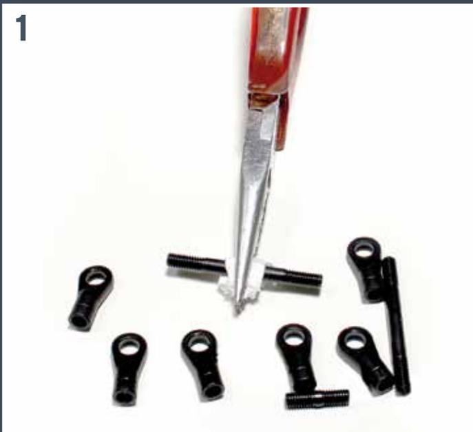
**1** En dehors des pièces fournies dans cette étape (et sans compter les vis à tête sphérique) vous aurez besoin d'une pince en pointe, de mouchoirs en papier et d'un calibre, de préférence électronique (voir pas 4).
