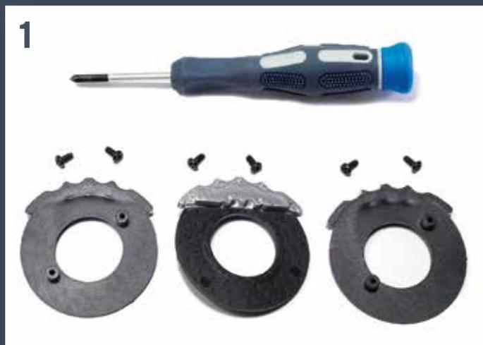
**1** Vous aurez besoin d'un petit tournevis Phillips, de six vis de 2 x 5 mm, des disques avant et d'un disque arrière.
