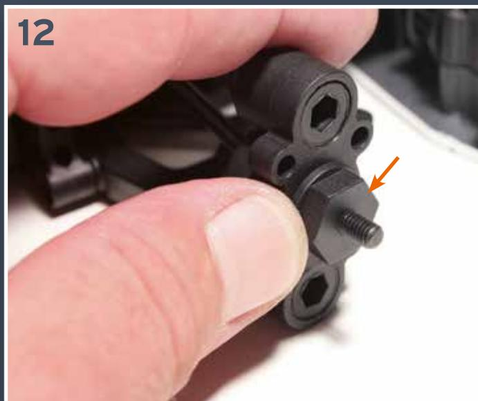
**12** Placez la rondelle de transmission hexagonale sur l'extrémité de l'arbre et du boulon.
