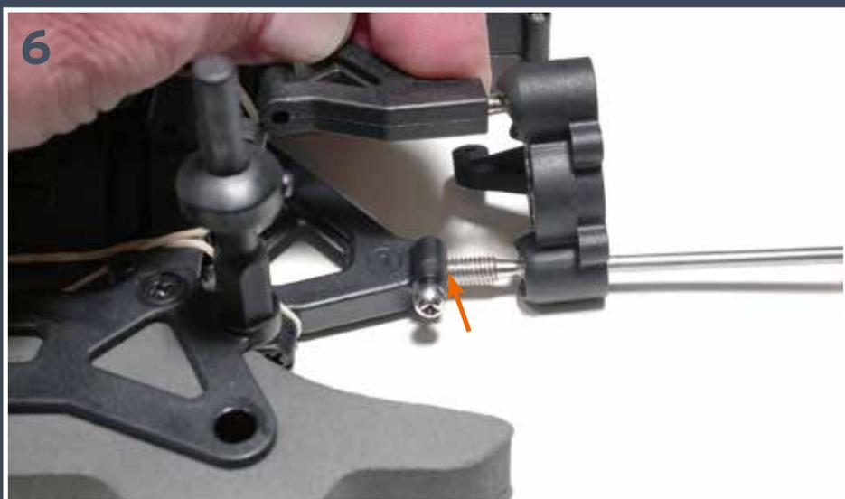
**6** Introduisez la vis à tête sphérique dans l'orifice indiqué sur le bras inférieur avant gauche.
