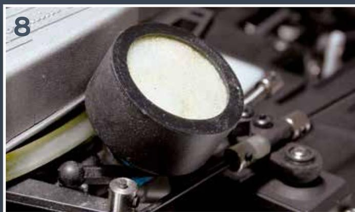
**3** Déposez quelques gouttes d'huile sur le côté du filtre également.
