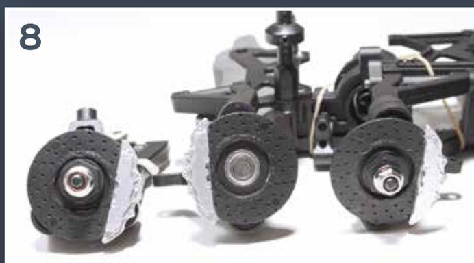
**3** Comparez les distances entre les saillants d'attache afin d'identifier les disques avant et arrière. La distance entre ces saillants sur un disque avant est moindre que sur un disque arrière.
