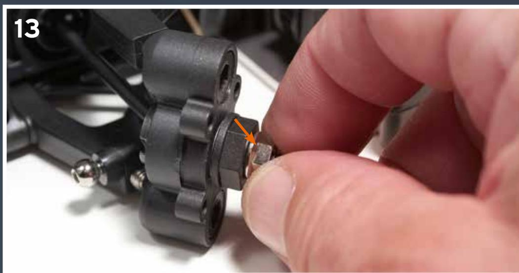
**13** Serrez maintenant l'écrou à bride sur l'extrémité de l'arbre afin de tenir les pièces en place.
