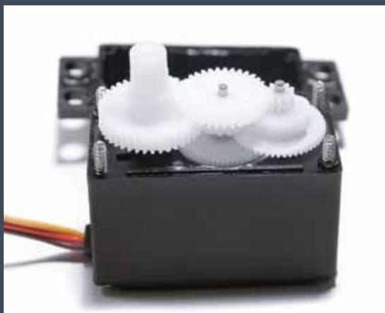
À gauche : Après avoir retiré le haut du boîtier du servo, vous exposez les engrenages transmettant le mouvement du moteur au bras du servo.
