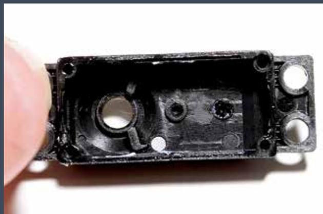
Ci-dessous : Intérieur de la partie supérieure du boîtier du servo.
