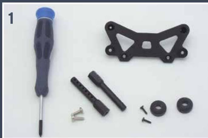
**1** Préparez la plaque du pare-choc, les deux appuis et supports de carrosserie, les deux vis des supports et les deux vis autoforeuses des appuis de carrosserie. Vous aurez aussi besoin du tournevis Phillips adapté.
