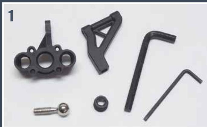
**1** Préparez le porte-moyeu avant gauche, le bras triangulaire supérieur avant gauche, la vis à bille et le contre-écrou, ainsi que deux tournevis hexagonaux (clés Allen) de 2,5 et 5 mm.
