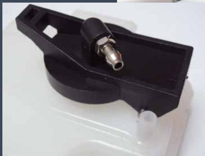
Les deux embouts connectent par tuyau le réservoir au pot de détente du silencieux et au carburateur.
