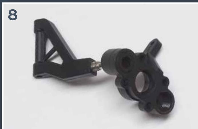
**3** Dévissez la vis du bras triangulaire et placez-la dans le trou au-dessus du porte-moyeu avant gauche (flèche rouge).
