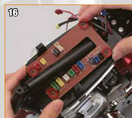
Alignez les orifices des coins de la plaque de contrôle et ceux sur la base du réservoir d'essence.
