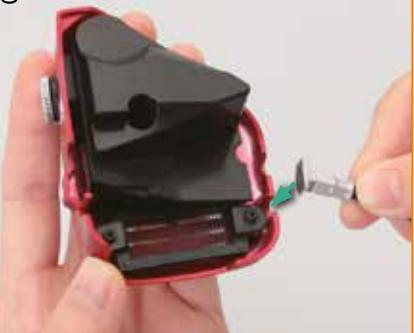
Alignez l'extrémité en T de la douille et l'encoche carrée sous le couvercle du réservoir d'huile.
