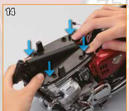
Montez la base du réservoir d'essence. Regroupez le connecteur blanc (5 broches), le connecteur jaune (2 broches) et le connecteur rouge (2 broches). Repérez les prises des couleurs respectives sur le tableau de contrôle.
