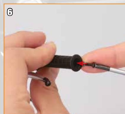
Insérez une vis de type G dans l'extrémité du guidon.
