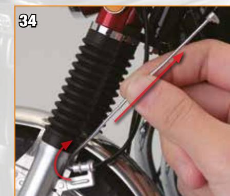
34 Tirez sur la douille du frein vers le haut en vérifiant que l'extrémité pliée reste bien dans l'orifice.
