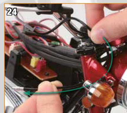
Passez l'extrémité libre du câble entre le joug supérieur et le phare et faites-le sortir délicatement vers l'arrière, en direction du moteur.
