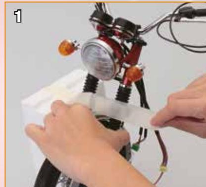
Retirez l'assemblage de la fourche avant du bloc de polystyrène.
