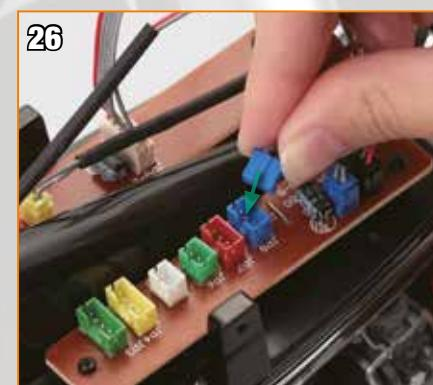
26 Insérez le connecteur bleu (3 broches) dans la prise bleue à 3 broches.
