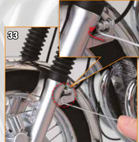
33 Insérez l'extrémité de la douille de freinage dans l'orifice indiqué sur le haut de l'assemblage du frein, tout juste derrière la partie arrière de la fourche gauche.
