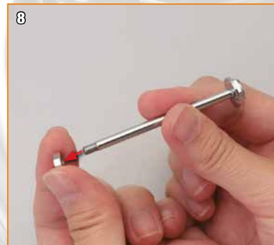
Retirez l'écrou de l'arbre de direction et posez-le sur le côté, en lieu sûr.
