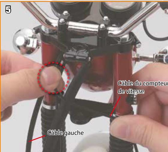
Passez l'extrémité libre du câble du compteur de vitesse jusqu'à la fourche avant droite. Passez-le ensuite de l'autre côté et tenez-le contre la partie gauche des deux câbles, reliés au connecteur vert, comme sur l'image.
