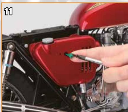
Réinsérez une vis de type E dans l'orifice au milieu du réservoir.
