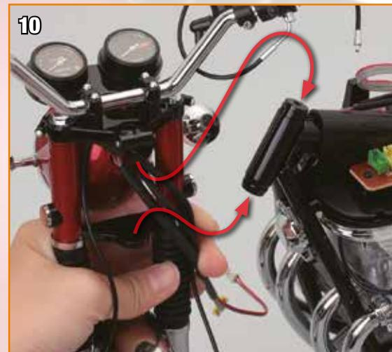
Tenez l'assemblage de la fourche avant devant le cadre principal et alignez les jougs supérieur et inférieur et les points indiqués sur la tête. Évitez de laisser les câbles au milieu en les rassemblant sur un côté.
