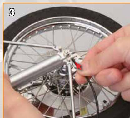
Enfoncez le câble du compteur de vitesse dans l'orifice. Si le câble n'est pas tendu, déposez une petite goutte de colle multi-usages dans l'orifice afin de l'y fixer.
