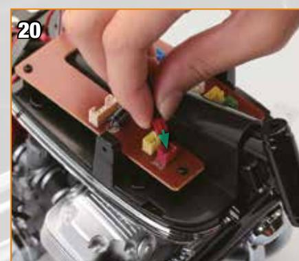
Insérez le connecteur rouge (2 broches) dans la prise rouge sur l'extrémité avant de la plaque.
