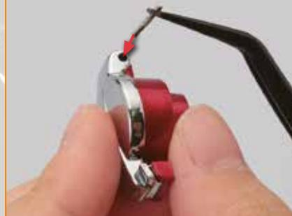
Insérez avec une pince le passant du bouchon du réservoir d'essence dans l'alignement des orifices de la charnière du bouchon du réservoir d'essence et du support.
