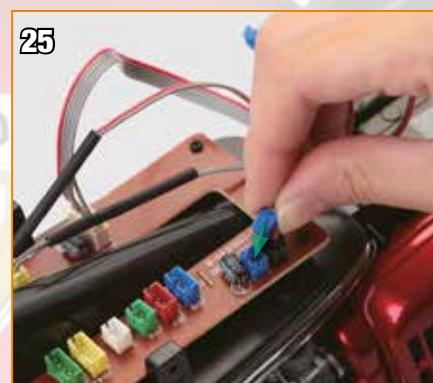
25 Insérez le connecteur bleu (2 broches) dans la prise bleue à 2 broches. Vérifiez qu'il s'agit bien de la prise à 2 broches car il y a aussi une prise bleue, mais à 3 broches.
