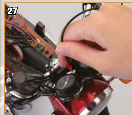
Prenez l'extrémité du câble issu de l'extrémité gauche du guidon, et passez-le dans l'ouverture entre le compteur de vitesses et le compteur de
