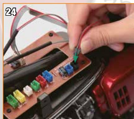
24 Insérez le connecteur noir (2 broches ou pôles) dans la prise noire à l'extrémité arrière de la plaque.
