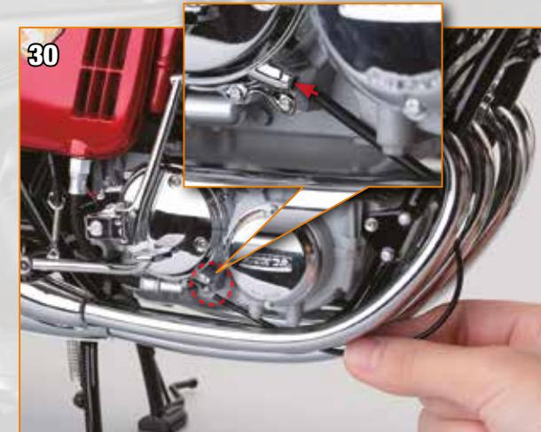
30 Repérez l'orifice à l'avant de la protection de l'embrayage et alignez-y l'extrémité du câble.
