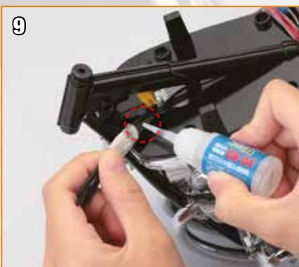
Prenez un morceau de ruban cache pour envelopper les quatre câbles du carburateur, puis déposez une ligne de colle instantanée sur l'emplacement cerclé sur l'image.
