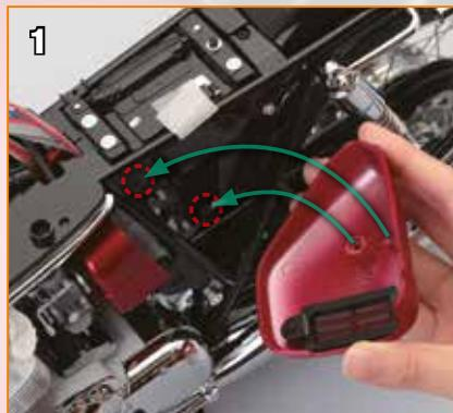
Alignez les saillants de montage à l'intérieur du couvercle de la batterie et les deux points cerclés du cadre principal.
