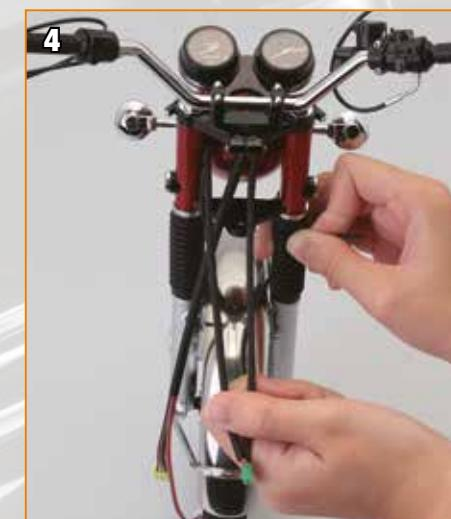
Tenez l'assemblage frontal verticalement et tirez délicatement sur les deux câbles par le connecteur vert, afin de les tendre complètement.
