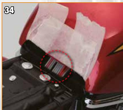
Vérifiez que la languette à l'arrière du réservoir (pas 30) ne gêne pas les câbles. Dans le cas contraire, limez davantage.
