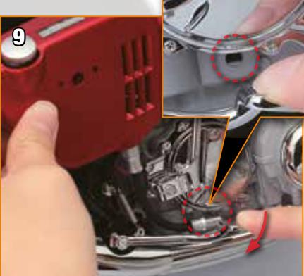
Tenez le réservoir d'huile en place sur le côté du cadre. Alignez le saillant de l'autre côté de la douille et l'orifice sous la protection de l'embrayage (cerclé dans l'agrandissement). L'orifice sera plus visible en faisant descendre la pédale de frein.
