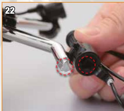
Le dessin de l'extrémité gauche du guidon correspond à l'orifice de l'extrémité du guidon.
