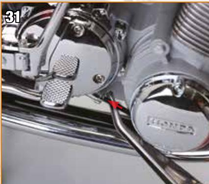
31 Insérez le câble dans l'orifice.
