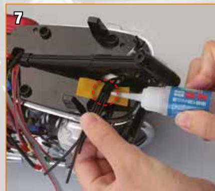
Déposez une ligne de colle instantanée à travers les quatre câbles, au milieu du ruban cache.
