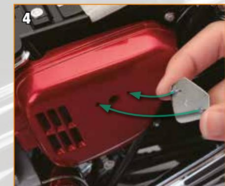
Assemblez les saillants à l'arrière de la plaque dans les orifices du couvercle de la batterie.
