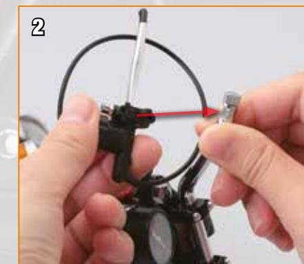
Préparez deux vis de type O, un tournevis Phillips et la pince du levier du frein avant. Alignez les sections en angle de l'assemblage du levier du frein avant.
