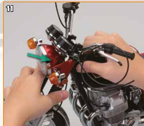
Rapprochez l'assemblage de la fourche avant et le cadre principal en insérant les jougs en haut et en bas de la tête, comme indiqué dans le pas précédent.
