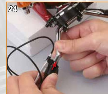
Assemblez l'extrémité du guidon sur le guidon.
