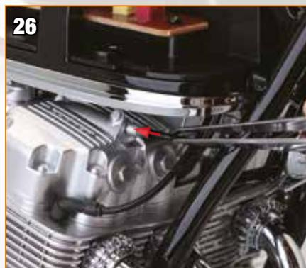
Insérez l'extrémité du câble dans l'orifice du bouchon de la culasse. S'il ne tient pas en place collez-le avec une goutte de colle multi-usages.
