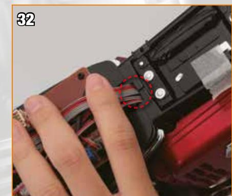
Placez les câbles en les laissant côté-à-côte et à plat sur l'ouverture du cadre, comme sur l'image (cerclés).
