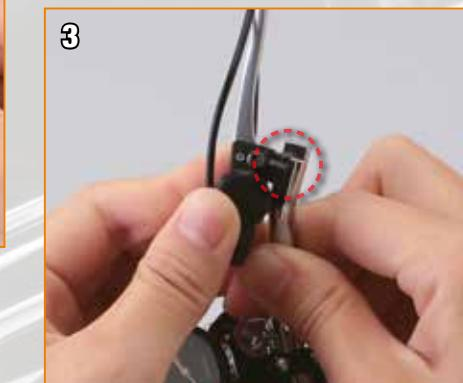
Montez l'assemblage du levier du frein avant sur le guidon et ajustez-le afin que les sections en angle soient en regard.
