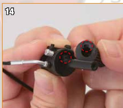
Prenez l'extrémité droite du guidon et la poignée et repérez le saillant carré à l'extrémité du guidon et l'encoche de la poignée (tous deux cerclés).
