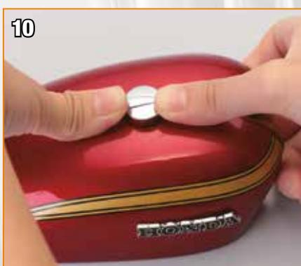
Assemblez le support du bouchon du réservoir d'essence sur le réservoir d'essence.
