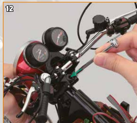
Insérez l'arbre de direction dans l'orifice du joug supérieur et passez-le à travers la tête vers l'extérieur, à travers le joug inférieur.
