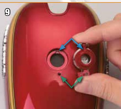
Retirez le réservoir d'essence du cadre et alignez les parties indiquées du support du réservoir d'essence et les parties correspondantes sur le réservoir, comme sur l'image.
