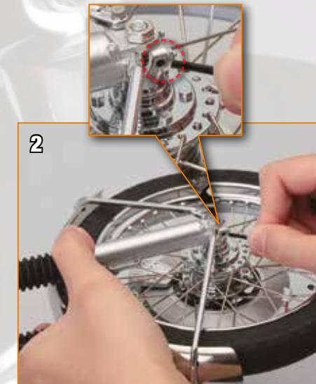
Repérez l'emplacement de l'orifice à l'arrière de la fourche avant droite, et insérez une extrémité du câble du compteur de vitesse.
