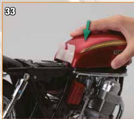
Placez le réservoir d'essence sur la structure et sur la base du réservoir.
