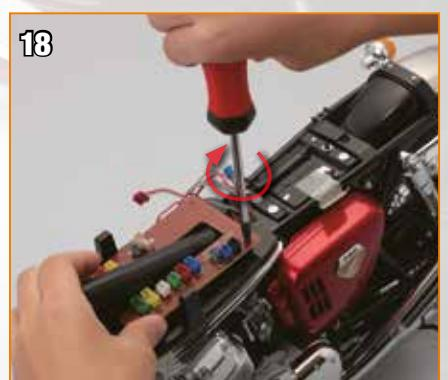
Serrez légèrement la vis de type G dans son emplacement. Serrez ensuite légèrement trois autres vis de type G dans les trois autres orifices de la plaque de contrôle. Après les avoir toutes installées, serrez-les complètement.
