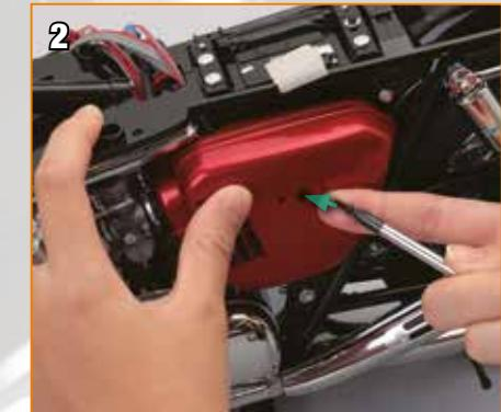
Tenez le couvercle de la batterie et insérez une vis de type E dans l'orifice indiqué par la flèche verte.
