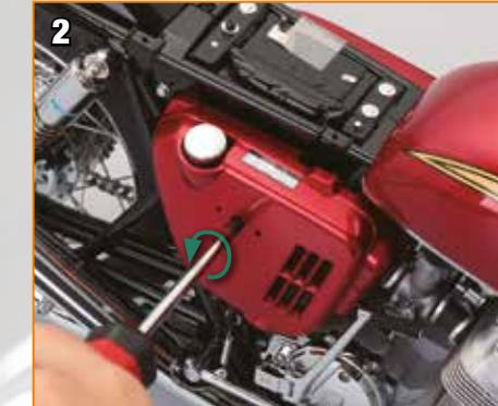
Desserrez et retirez la vis de type E au milieu du réservoir.
