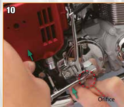
Tenez le réservoir d'huile en place, lâchez le levier de frein et insérez le saillant de l'extrémité de la douille dans l'orifice.
