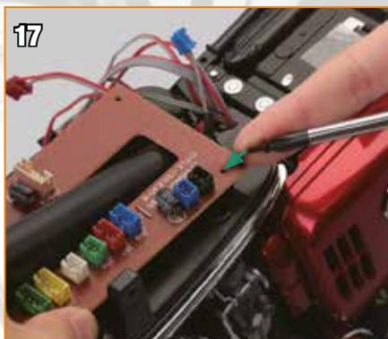
Placez une vis de type G (étape 59) dans l'orifice indiqué au coin de la plaque de contrôle.
