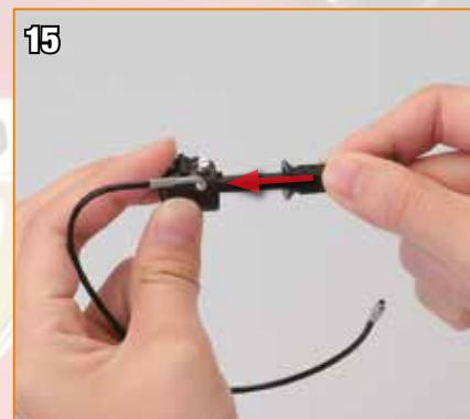
Alignez le saillant et l'encoche et enfoncez la poignée sur l'extrémité du guidon.
