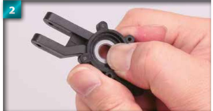
2 Vérifiez que le coussinet est bien calé dans l'encoche du moyeu.
