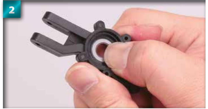
Vérifiez que le coussinet est bien placé à l'intérieur de l'orifice du moyeu.
