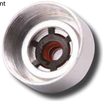
Tout en tenant le couvercle dans un mouchoir en papier, déposez quelques gouttes d'huile d'amortisseur sur les joints toriques et l'anneau de fermeture.
