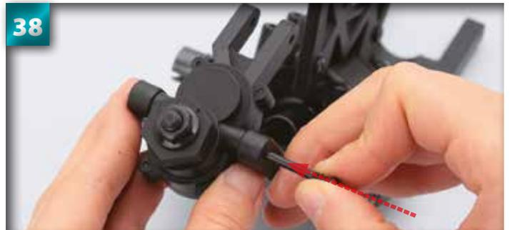
Introduisez une vis de 3 × 48 mm (étape 11) dans le trou sur la barre du bras. Faites-le passer dans les trous du moyeu jusqu'à ce qu'il ressorte par l'autre trou du bras.
