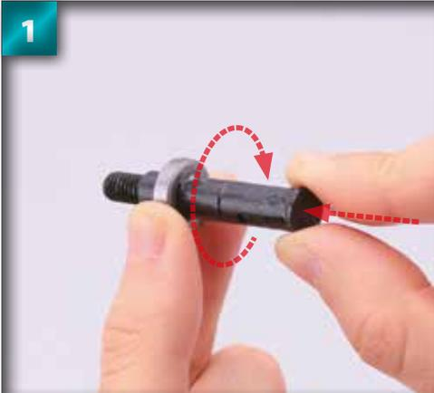
1 Déposez un peu de graisse dans l'arbre de la roue arrière et passez-le à travers le coussinet métallique 1480. Faites-le tourner dans le coussinet pour étaler uniformément la graisse.
