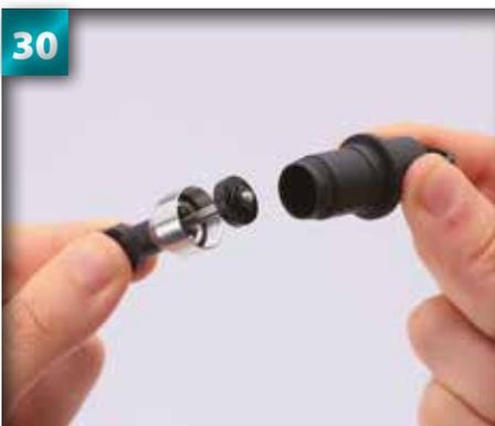
Laissez temporairement l'amortisseur assemblé en introduisant l'axe dans le boîtier.
