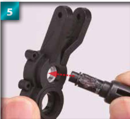
Introduisez l'articulation du différentiel dans le moyeu arrière en faisant en sorte de faire passer l'axe à travers le coussinet.
