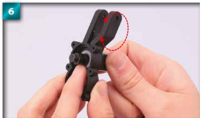
6 Faites tourner l'articulation du différentiel pour étaler la graisse uniformément et vérifiez que le coussinet reste bien calé.
