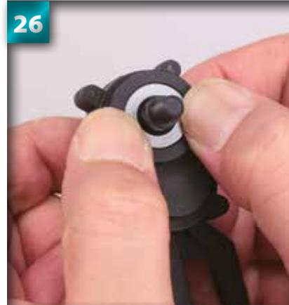
26 Enfoncez le coussinet dans l'arbre et faites-le tourner un peu pour étaler la graisse.
