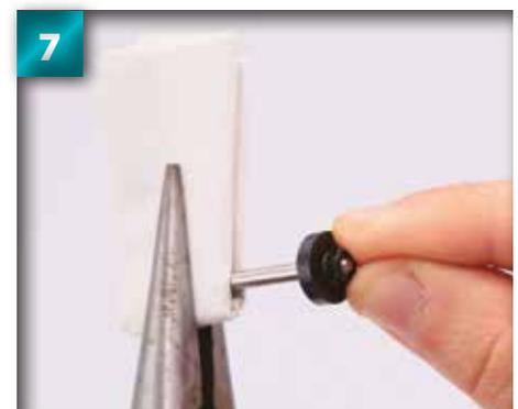
Placez l'écrou de 2,6 mm sur le filetage de l'axe.
