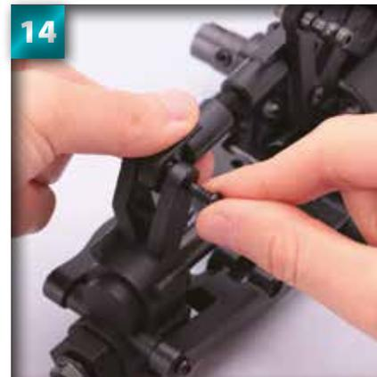
Alignez les trous de la boule perforée et ceux du pivot du bras et introduisez une vis de 3 x 20 mm.
