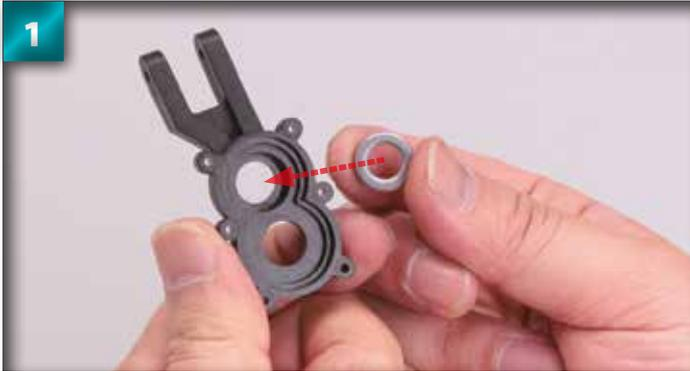
1 Placez le coussinet 1480 dans l'espace derrière le moyeu arrière.
