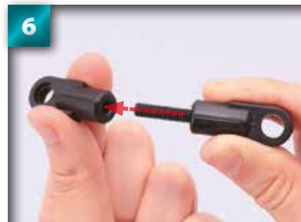
Placez l'autre extrémité de la vis de pression au bout de l'autre embout sphérique.
