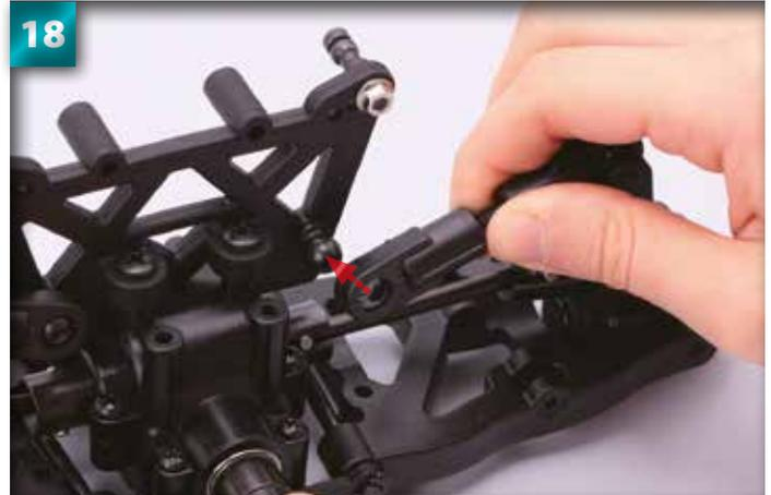
18 Placez l'embout sphérique de la barre de couplage devant la boule dépassant sur la structure de l'amortisseur arrière.
