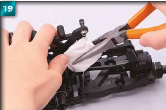
19 Enveloppez à nouveau ces pièces avec un mouchoir à papier et avec une pince assemblez l'embout sphérique de la barre de couplage dans la boule qui dépasse.
