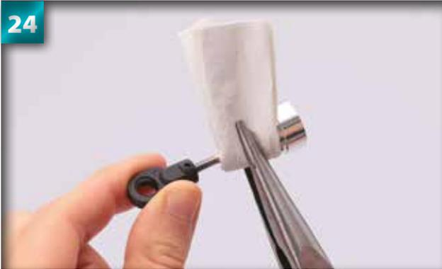
Vissez l'anneau inférieur sur l'axe jusqu'à ce que le filetage ne soit plus visible.
