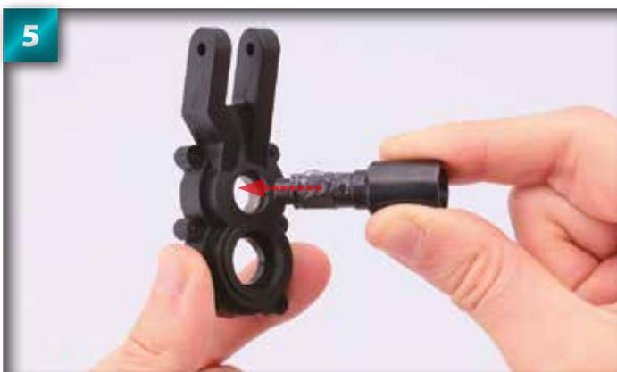
5 Introduisez l'articulation du différentiel dans le moyeu arrière afin que l'axe dépasse de l'autre côté du coussinet.
