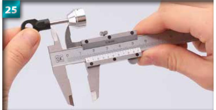
Mesurez l'espace entre le couvercle et l'anneau inférieur. Ce dernier devrait être à 14 mm du couvercle. Serrez ou desserrez au besoin pour l'ajuster correctement.
