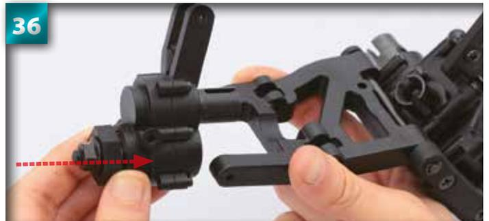
Tenez l'assemblage du moyeu en laissant l'arbre vers le bas et placez-le entre les deux barres du bras gauche.
