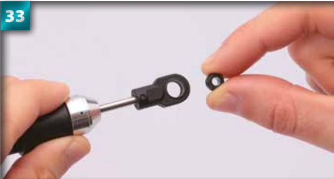
Tenez bien l'assemblage de l'amortisseur en tournant vers vous le côté le plus large de l'anneau inférieur. Les rotules perforées de 6,8 mm (étape 9) viennent se loger dans l'orifice.
