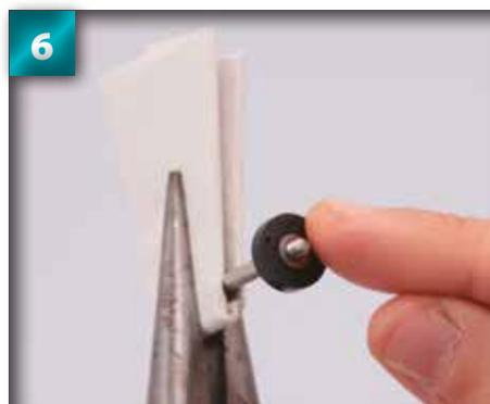
Passez la deuxième rondelle de 2,3 mm. Le piston doit se trouver entre les deux rondelles.
