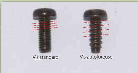
La vis à gauche sur l'image est standard : elle est introduite dans un orifice qui dispose déjà d'un pas de vis. Le filetage est fin et l'espace entre les sillons est très réduit.
