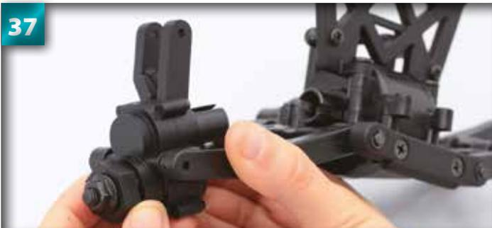
Alignez les trous des barres du bras et ceux des côtés de l'assemblage du moyeu.
