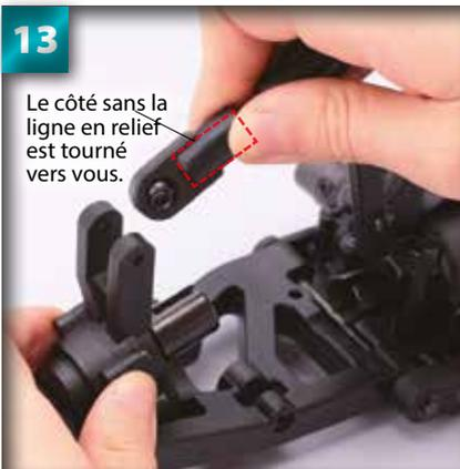
Placez une des barres de couplage entre les pivots du bras supérieur de la cloison arrière montée dans l'étape 12. Le côté de la barre de couplage sans la ligne en relief doit être tourné vers vous.
