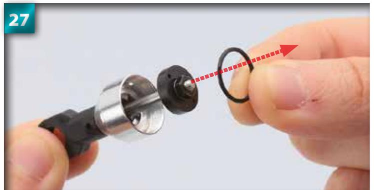
Appuyez sur l'axe à travers le couvercle et passez le joint torique de 11 mm par dessus le piston.
