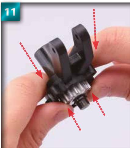
Pressez l'engrenage contre l'articulation jusqu'à ce qu'il soit aligné au coussinet.
