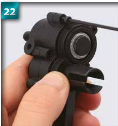
Introduisez la vis à capuchon dans le trou du coin de l'assemblage et serrez-la.
