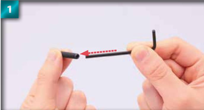
Introduisez la clé Allen fournie dans l'étape 7 à l'intérieur de l'orifice hexagonal au bout de la vis de pression 5 x 30 mm.
