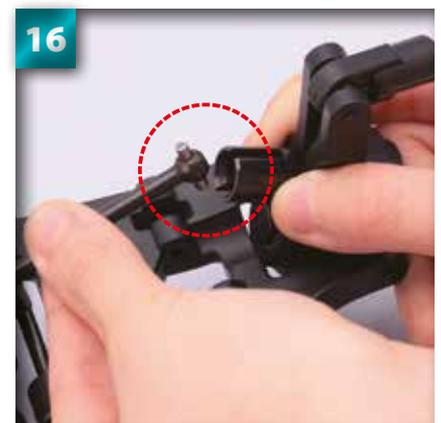
Placez l'extrémité de l'arbre de transmission arrière fourni dans l'étape 12 sur l'articulation de l'assemblage du moyeu.
