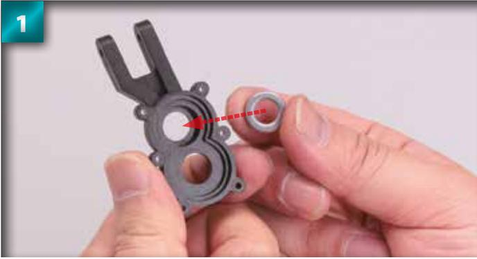
Placez le coussinet 1480 dans l'orifice du moyeu arrière.
