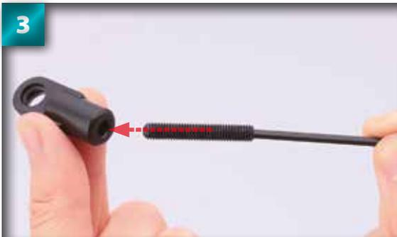
Introduisez soigneusement la vis de pression dans l'orifice à l'extrémité de l'embout sphérique.
