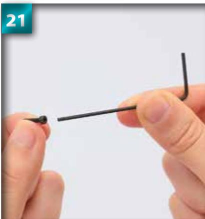
Placez une vis à capuchon de 2 x 10 mm (étape 11) au bout de la clé Allen de 1,5 mm.
