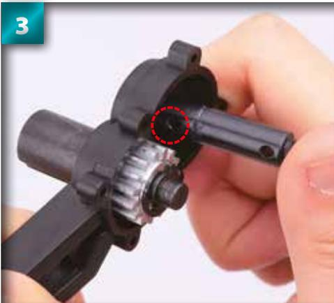
3 Tout en tenant le montage comme sur l'image, faites tourner l'arbre jusqu'à ce que l'orifice circulaire soit visible.
