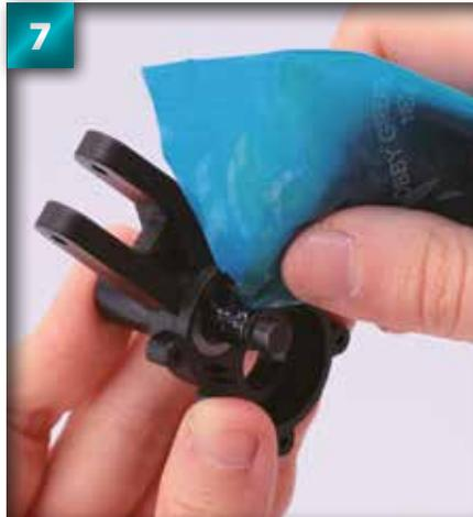
Déposez un peu plus de graisse sur la partie qui dépasse de l'axe du différentiel.
