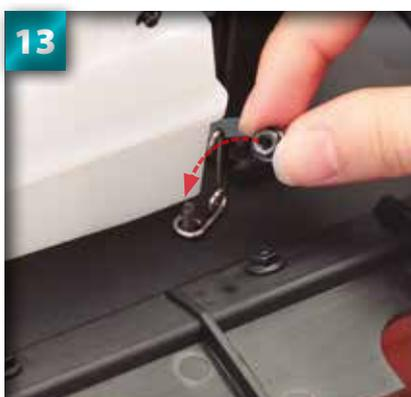
**13** Maintenez toujours la tête de la vis par dessous le montage et placez l'écrou à ressort 3 mm sur la pointe de la vis, côté large en premier.
