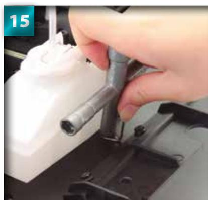
Une fois le châssis posé sur le côté, utilisez la clé en croix et le tournevis pour serrer la vis et l'écrou au maximum.
