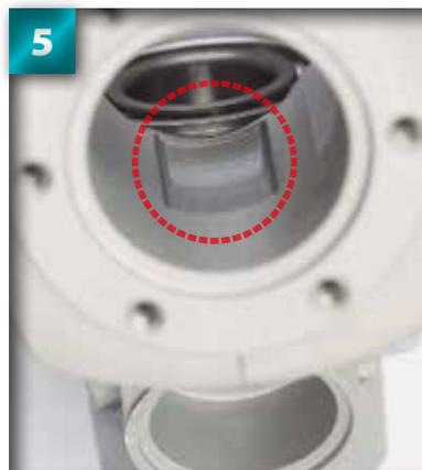
**5** L'intérieur de la chambre cylindrique du carter présente un renforcement. De par sa forme, il est censé guider le mélange de carburant vers le trou central du vilebrequin.
