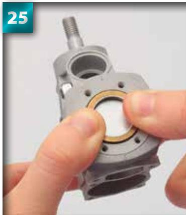
Voilà à quoi doit ressembler le montage à présent. La chemise doit légèrement dépasser par le haut.
