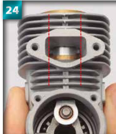
Cette image montre à quoi devrait ressembler le montage à présent, avec l'orifice de balayage bien aligné avec l'orifice d'échappement (comme l'indiquent les flèches rouges).
