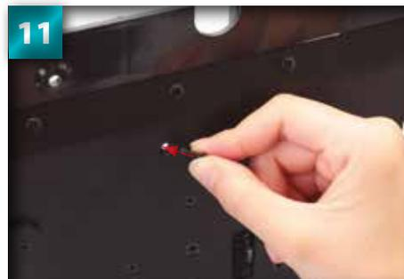
**11** Posez le montage principal du châssis sur le côté et placez la vis 3 x 10 mm dans le trou de la section avant, sur la gauche (tel qu'indiqué par la flèche).
