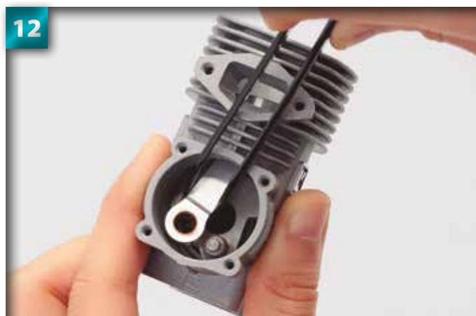
Utilisez une pince enveloppée dans du papier pour soulever la bielle et la positionner au-dessus de la barre du vilebrequin.
