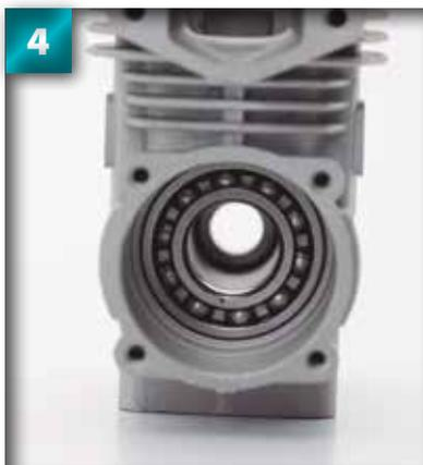
**4** Dans le moteur à deux temps de la Hummer, les billes de roulement à l'arrière du carter sont à découvert afin que le mélange de carburant leur serve de lubrifiant.
