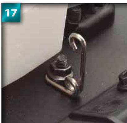
**17** La position du support du silencieux sous l'écrou doit être identique à celle de l'image, avec le bras long tourné vers le haut. Si votre montage est différent, faites-le pivoter manuellement et desserrez l'écrou si besoin est.
