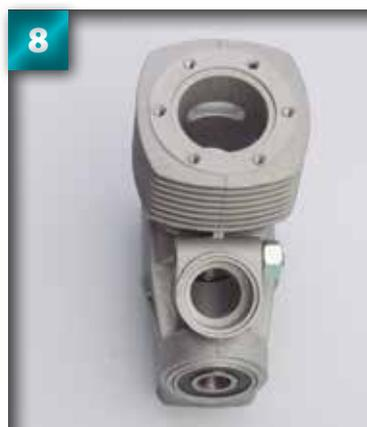
**8** L'orifice d'extraction est également visible sous cet angle, derrière la section verticale.
