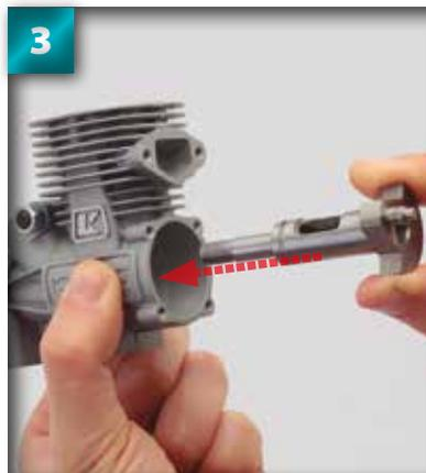
**3** Maintenez l'axe parfaitement aligné au moment de l'introduire dans l'ouverture du carter et appuyez délicatement les pièces l'une contre l'autre. Veillez à ne pas cogner les roulements.
