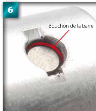
7 Jetez un coup d'œil au piston et examinez-le attentivement. Il est relié à la bielle au moyen de la barre du piston, qui ne peut pas bouger de sa position grâce au bouchon, en rouge sur la photo.
