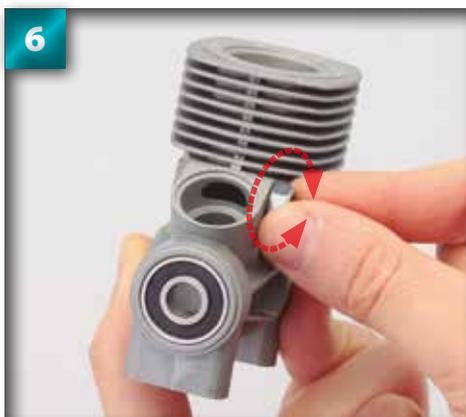
**6** Desserrez manuellement l'écrou du carburateur.
