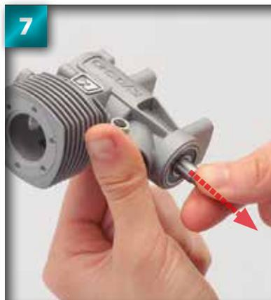
**7** Tirez le vilebrequin jusqu'à ce que la partie arrière vienne reposer contre les billes de roulement à l'intérieur du carter, juste devant le renforcement du contrepois.
