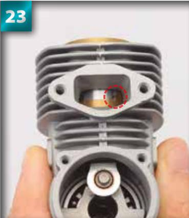
Veillez à ce que l'orifice de balayage, situé à l'arrière du montage, s'aligne avec l'orifice d'échappement du carter. L'image montre une mauvaise position des pièces : regardez bien le bord de l'orifice de balayage, indiqué en pointillés rouges, qui ne coïncide pas avec l'orifice du carter.
