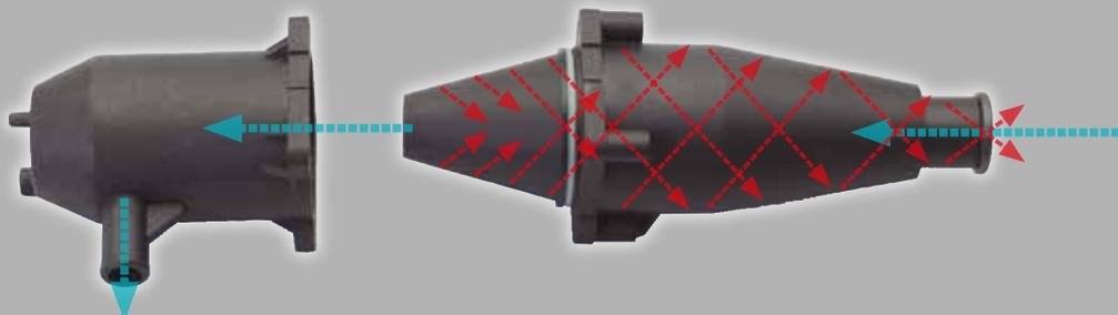
Les gaz brûlés (flèches bleues) entrent dans le silencieux et sont expulsés par le tuyau d'échappement, tandis que les ondes sonores qui les accompagnent (flèches rouges) rebondissent à l'intérieur de la chambre d'expansion, où elles sont neutralisées, ce qui réduit le bruit du moteur.
