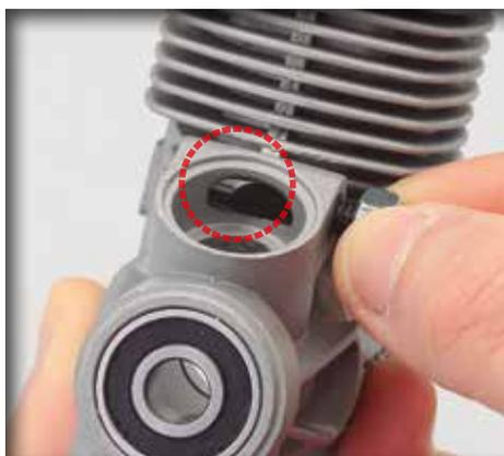
**6** En desserrant, vous verrez la pointe de l'axe de l'écrou attraper l'axe du carburateur. En vissant l'écrou, le carburateur reste bien en place.
