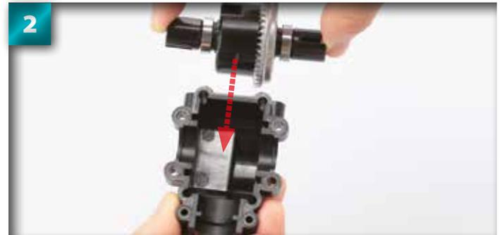
Placez le montage du différentiel de l'étape 24 dans la pièce inférieure de la cloison, avec la couronne sur le côté droit de la cloison.
