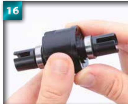
16 Assemblez les deux pièces en faisant coïncider les trous des deux faces.
