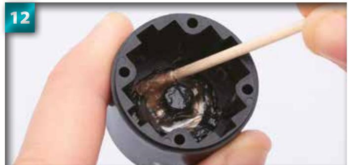
Badigeonnez de graisse l'intérieur du carter du différentiel. Recouvrez la rondelle et l'articulation.
