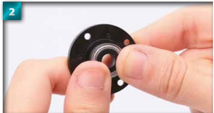
Appuyez fermement sur le roulement pour l'encastrer dans la structure. Veillez à ce que le roulement soit aligné avec le carter.
