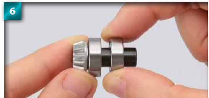
Maintenant glissez le deuxième roulement 1680 par le palier et placez-le au centre en laissant un espace entre les deux roulements.
