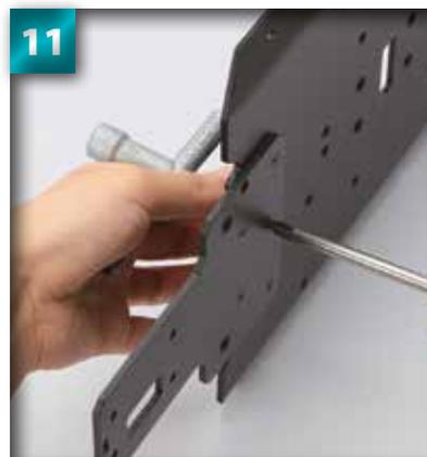
Tenez la clé cruciforme sur l'écrou pour éviter qu'il ne bouge et commencez à serrer les vis à partir de l'autre côté à l'aide d'un tournevis. Vissez-le jusqu'à ce qu'il soit bien fixé et faites de même avec les cinq autres vis et leurs écrous respectifs.
