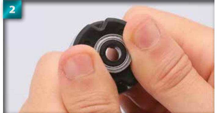
2 Faites pression vers le bas avec vos deux pouces sur le roulement à force égale. Attention à ne pas exercer trop de pression, au risque de l'endommager.
