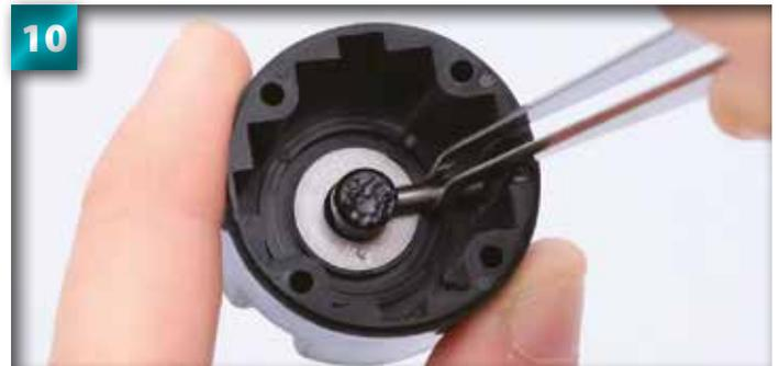
Introduisez avec précaution la barre métallique à travers ce trou avec les pinces. Profitez des creux qui restent à l'intérieur du carter pour mieux manœuvrer et mettre en place la barre.
