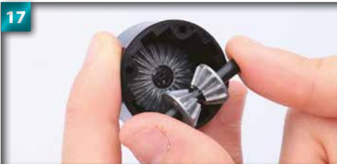
Avec les deux satellites 10T au centre, comme on le voit sur l'image mettez le palier dans le carter du différentiel. Les extrémités du palier doivent reposer dans les recoins latéraux du carter.
