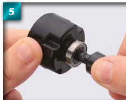
5 Tournez l'articulation de droite à gauche pour étaler la graisse. Si la graisse déborde entre le roulement et le carter, retirez-la avec un mouchoir.
