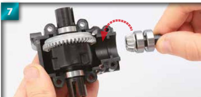
Introduisez le palier avec les roulements dans le creux situé derrière la pièce inférieure de la cloison (regardez la flèche).
