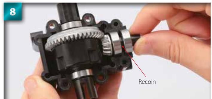
Le palier doit s'insérer de façon à ce que le cran situé dans le recoin sépare les deux roulements et que les dents du pignon 13T et de la couronne 43T restent imbriquées.
