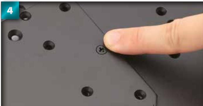
La vis doit traverser les deux trous, de sorte que la tête conique de la vis s'ajuste parfaitement à la surface plate. À ce stade, la vis bouge encore dans le trou.
