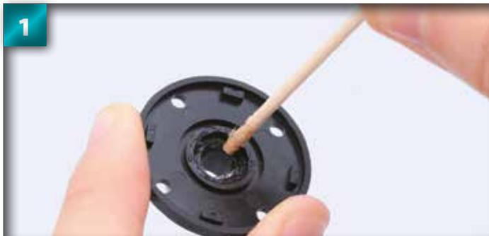
À l'aide d'un bâtonnet appliquez un peu de graisse sur le recoin central de l'intérieur du carter du différentiel.
