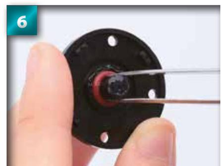
Enfoncez le joint torique à l'intérieur jusqu'à sa fixation dans le recoin que vous avez graissé à la case 1.
