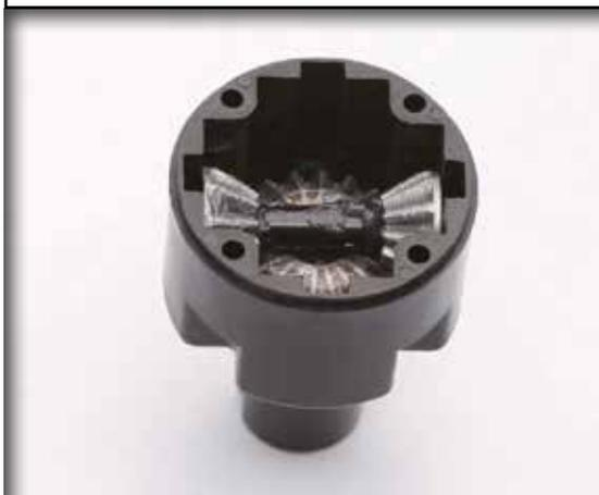
C'est très important de ranger les pièces montées au cours de cette session à l'abri des souillures et de la poussière, sinon celles-ci vont adhérer à la graisse et entrer dans le différentiel, ce qui pourrait créer des problèmes aux parties mobiles qu'il possède. Si possible, rangez le montage et la graisse dans différents sachets en plastique refermables.
