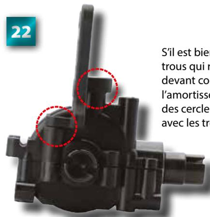
**22** S'il est bien en place, les trous qui ressortent tant par devant comme par derrière l'amortisseur (signalés par des cercles) coïncideront avec les trous de la cloison.
