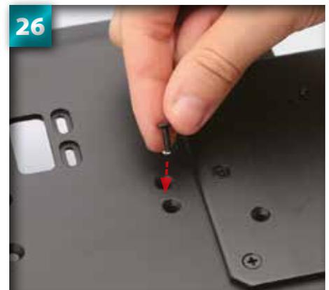
26 Introduisez une vis à tête conique de 3 x 10 mm dans l'un des trous en veillant à la faire coïncider avec l'un des trous de l'extrémité de la barre de torsion à l'arrière.
