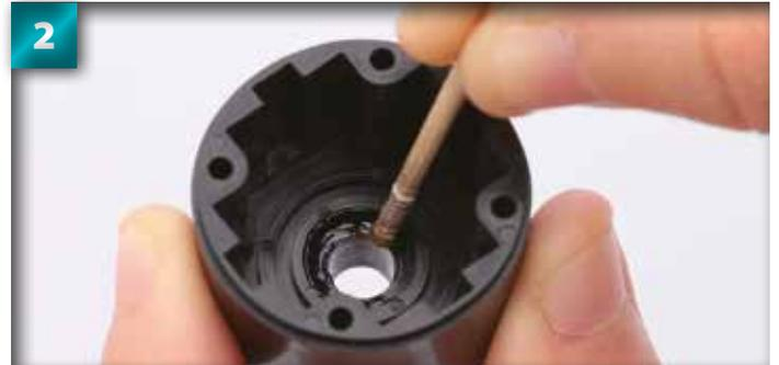
2 À l'aide du bâtonnet étalez la graisse sur le pourtour de la rainure de l'intérieur du carter du différentiel, comme sur l'image. Utilisez une quantité suffisante pour faire légèrement briller la rainure.
