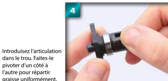
Introduisez l'articulation dans le trou. Faites-le pivoter d'un côté à l'autre pour répartir la graisse uniformément.
