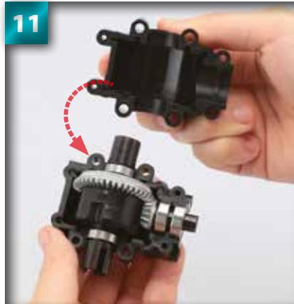
11 Vérifiez aussi que les deux parties s'ajustent l'une avec l'autre et qu'elles ne gênent pas le fonctionnement des roulements.
