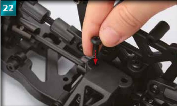
22 Introduisez l'une des vis à tête plate 4 x 10 mm dans le trou de la barre de torsion (regardez la flèche).
