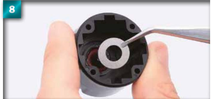
Puis placez la rondelle 6 x 12 mm sur l'axe, de façon à ce qu'elle repose sur la base et recouvre le joint torique. Peu importe le côté par lequel on introduit la rondelle.
