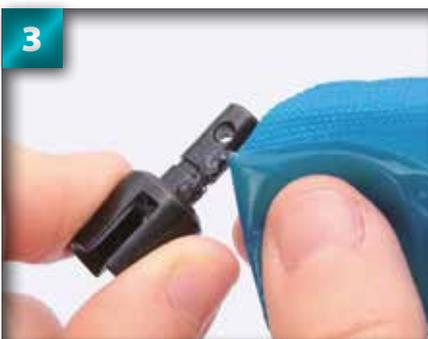
3 Maintenant mettez un peu de graisse sur la fine extrémité de l'articulation du différentiel. Regardez sur la photo pour en calculer la quantité nécessaire.
