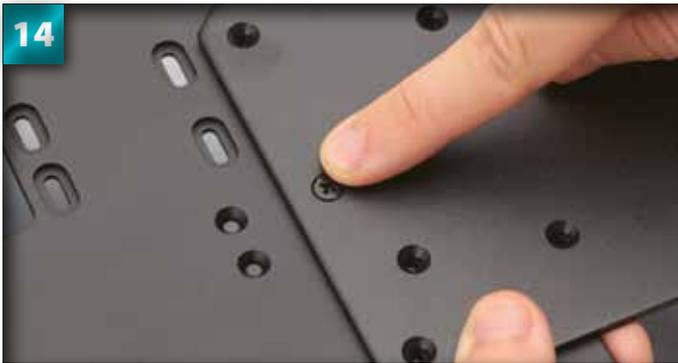
14 La vis doit traverser les deux trous pour que la tête conique de la vis s'ajuste parfaitement à la surface. Lors de cette étape la vis n'est pas encore vissée, donc maintenez-la en place avec précaution.
