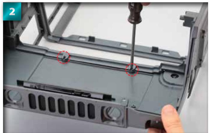
Serrez les vis autoforeuses de 2 x 6 mm dans les trous.
