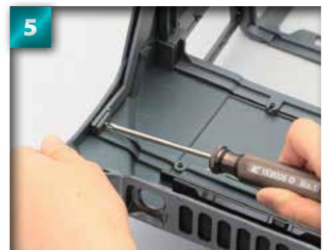
Ensuite introduisez une vis de 2 x 6 mm de chaque côté du capot. À part de poser les vis, mettez un peu de colle plastique à l'intérieur des jointures.
