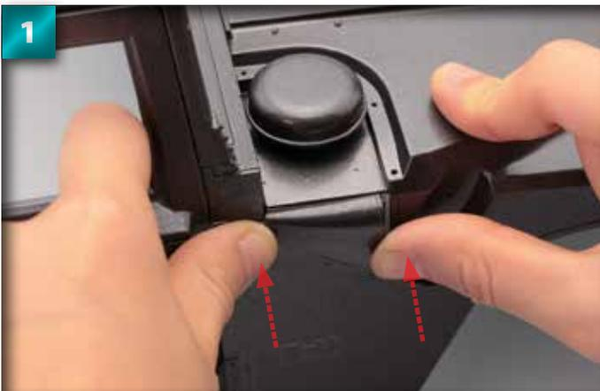
Faites pression sur la prise d'air pour la mettre en place. Suivez les flèches.
