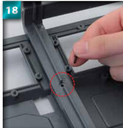
Placez l'une des vis autoforeuses de 2 x 6 mm fournies à l'étape 33 sur la projection centrale de l'armature de la porte.
