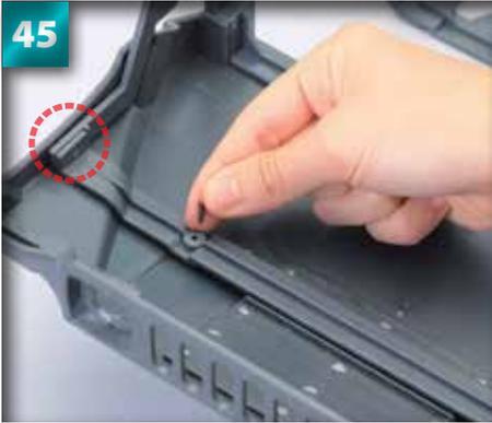
Placez une autre vis autoforeuse de 2 x 6 mm dans le premier trou de la pièce 3. Vérifiez que l'extrémité extérieure de la pièce 3 est à la même hauteur que la rainure de la pièce 9 et que les trous sont alignés.
