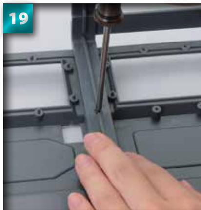
Ensuite, mettez une autre vis autoforeuse de 2 x 6 mm et vissez-la sur la projection qu'il y a entre la porte et le latéral.
