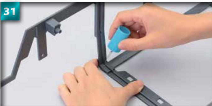
Mettez un peu de colle sur la jointure qui relie les pièces 5 et 6 tandis que vous maintenez les deux pièces en place pour éviter qu'il ne se forme aucun creux au milieu.
