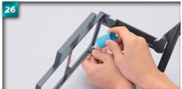
26 Retournez le montage et mettez un peu de colle sur la jointure qui relie les pièces 6 et 8, à l'arrière de la structure.
