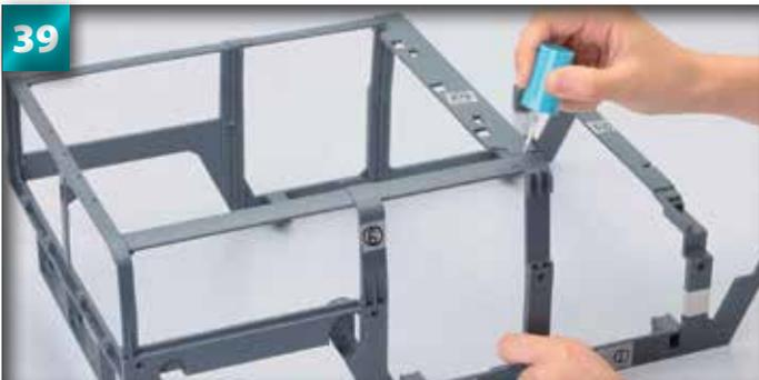
39 Mettez un peu de colle dans les jointures du haut de la caisse où l'extrémité de la pièce 5 s'assemble avec les pièces 6 et 7.
