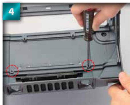
Vissez les vis autoforeuses de 2 x 6 mm dans les trous.
