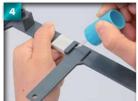
Mettez un peu de colle dans la jointure, de préférence avec une brosse de poils fins. Mettez une première couche de graisse dessus et répétez l'opération, si nécessaire.
