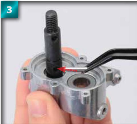
**3** Graissez la base de l'axe du réducteur. Ensuite, avec des pinces, introduisez la barre de 2,5 x 12 mm à travers le trou indiqué par la flèche.
