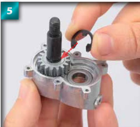
**5** Placez la rondelle semi-circulaire E-7 dans la fine entaille de l'axe, juste au-dessus de la surface du pignon. La partie de l'anneau semi-circulaire doit être orientée vers le haut. Veillez à bien utiliser l'anneau E-7 et non pas le E-6, qui est plus petit et servira dans une étape postérieure.
