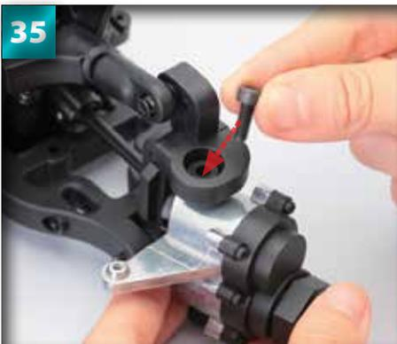
Introduisez une vis à capuchon de 4 x 10 mm dans le trou du collier du bras et le trou de la partie supérieure du moyeu.
