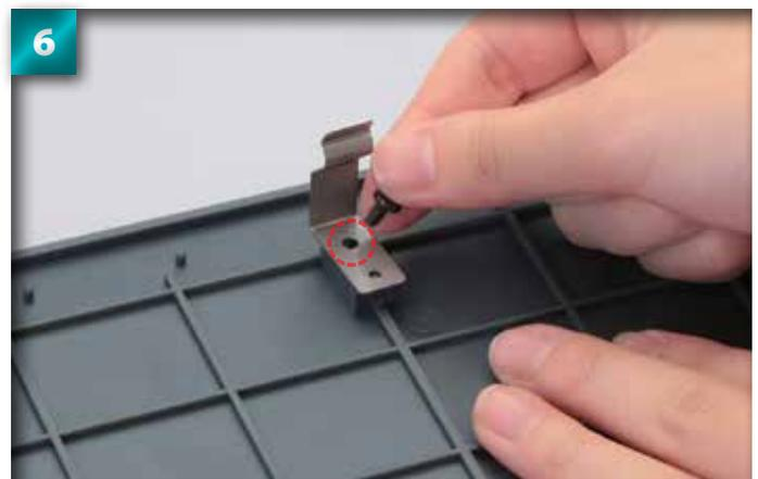
6 Introduisez la vis autoforeuse à tête plate de 3 x 6 mm dans le trou du triangle cerclé en rouge.
