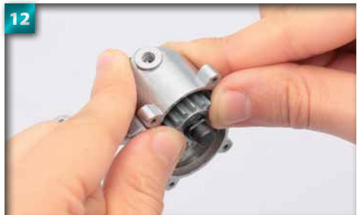
Poussez le pignon avec fermeté pour le mettre en place, de sorte que la rainure qu'il y a sur la pointe de l'axe du réducteur (mis en évidence à l'étape 4) soit visible une fois le pignon fixé.
