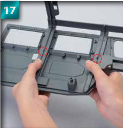
Alignez les projections du montage de la porte de droite avec les trous de l'armature.
