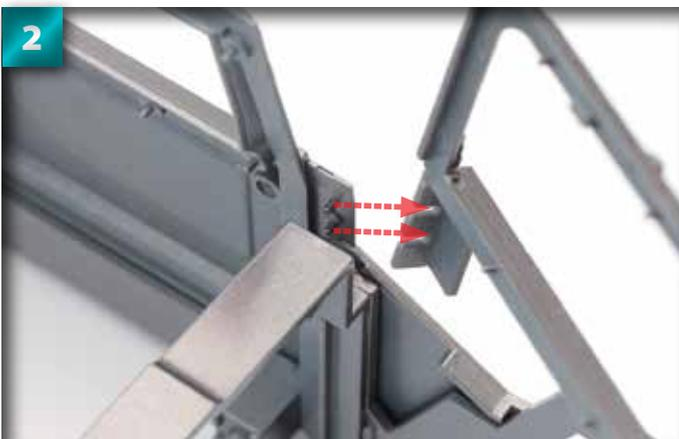
Pour ajuster le cadre du pare-brise, placez les deux barres de l'intérieur du panneau dans les rainures latérales du cadre. Regardez-bien les flèches.
