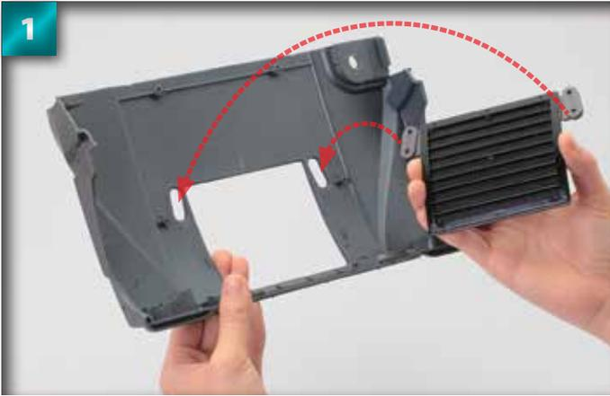
1 Introduisez le couvercle peint du radiateur sous le capot et placez les deux projections latéraux dans les trous, comme il est indiqué par les flèches.
