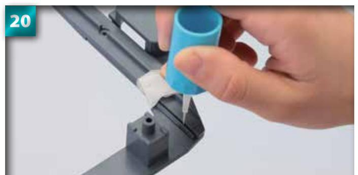
Répétez la séquence 19 avec la jointure qui unit les pièces 2 et 6. Après avoir mis de la colle, posez le montage sur une surface plate pendant 30 à 60 minutes pour le séchage.
