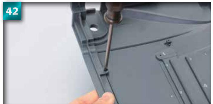
42 Serrez avec un tournevis, mais ne les vissez pas complètement, d'autant que les pièces en plastique pourraient être endommagées.
