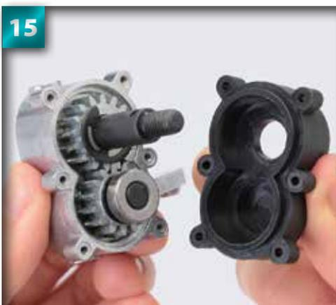
Afin de fermer le boîtier du moyeu alignez le couvercle du moyeu avec le montage de cette phase-ci. L'axe du réducteur de la roue passera au travers du trou du couvercle du moyeu, tandis que les trous pour les 6 vis des deux pièces devront coïncider.
