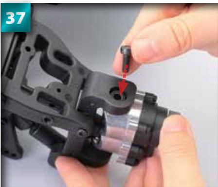
Pendant que vous maintenez le moyeu en place, retournez le montage pour accéder à la partie inférieure du boîtier du moyeu. Répétez les étapes 33, 34 et 35 pour les autres vis de ce côté là.
