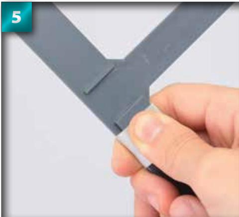
Serrez les pièces avec vos doigts index et pouce pour étaler la colle de manière uniforme à l'intérieur de la jointure.
