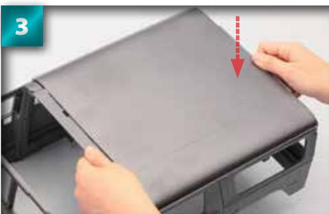
Avec les trois projections dans les trous correspondants, poussez la partie arrière du panneau vers le bas pour l'emboîter dans le triangle installé à l'étape 7 de la page 163.
