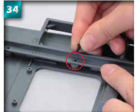
Posez une vis autoforeuse de 2 x 6 mm dans le premier des trous de la partie intérieure de l'armature.
