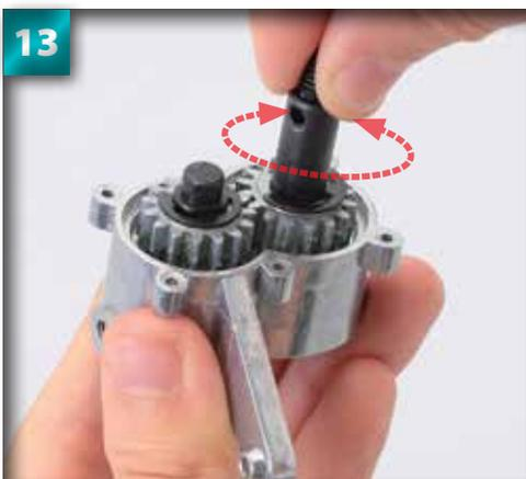
Tournez lentement l'axe du réducteur de la roue pour étaler la graisse de façon uniforme sur tous les engrenages.
