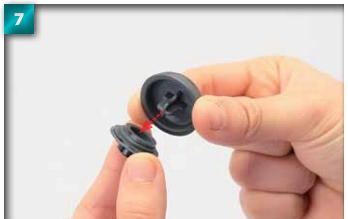
7 Séparez la couverture et la base du filtre à air, peignez-les et attendez le séchage avant de les réinstaller.
