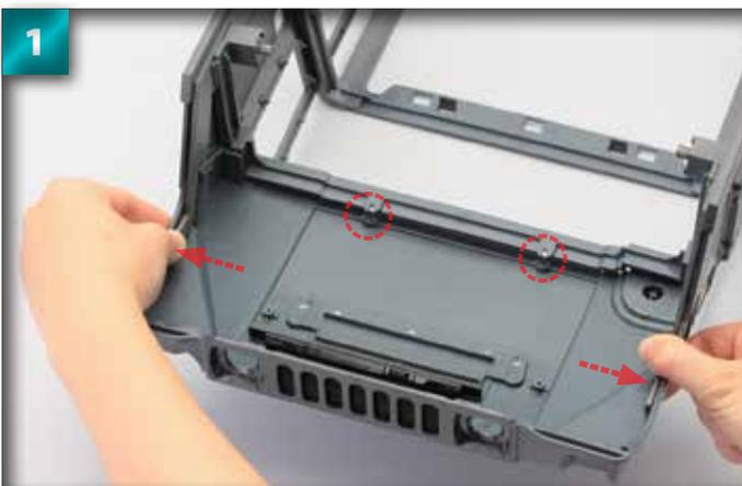
Comme pour l'étape 33, remplacez le capot dans l'armature, veillez à ce que les jointures indiquées par les flèches et les cercles coïncident.
