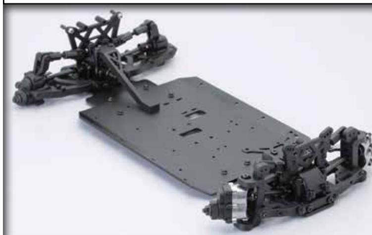
Vous avez déjà terminé cette étape. Votre Hummer est désormais équipée des systèmes de suspension avant et arrière, et les quatre moyeux des roues ont été installés. Rangez le montage avec soin jusqu'à la prochaine étape.
