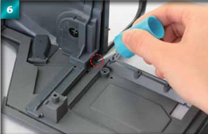
Continuez en déposant de la colle adhésive dans les jointures qui relient le capot et l'armature.
