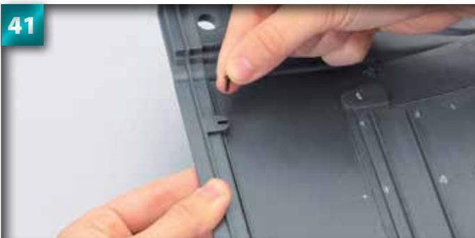
41 Alignez les proéminences qu'il y a le long du bord de la pièce 4 avec celles qu'il y a dans la partie inférieure du capot. Introduisez 2 vis autoforeuses de 2 x 6 mm.
