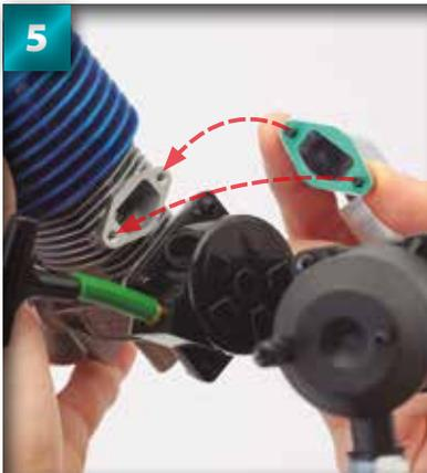
5 Approchez le montage du collecteur et le joint du silencieux de l'orifice d'échappement du moteur.
