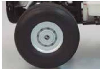
Si le logo n'est pas visible, la roue tourne trop rapidement et il est nécessaire de régler la vitesse de ralenti.
