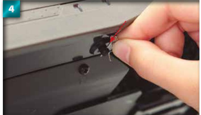
De l'extérieur, faites glisser la première goupille beta à travers le trou situé sur la barre de fixation.
