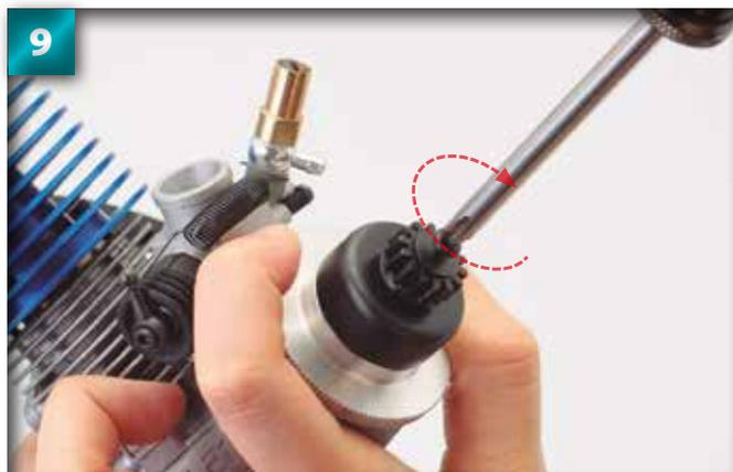
Serrez-la au maximum à l'aide d'un tournevis.
