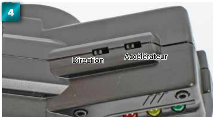
Si les servos fonctionnent dans le sens inverse des contrôles du transmetteur, utilisez les interrupteurs inverseurs pour modifier la direction.
