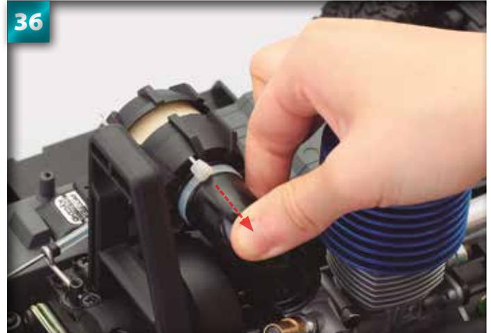
Appuyez fermement sur le tube de la prise d'air que vous venez d'insérer sur l'orifice d'entrée de l'air.
