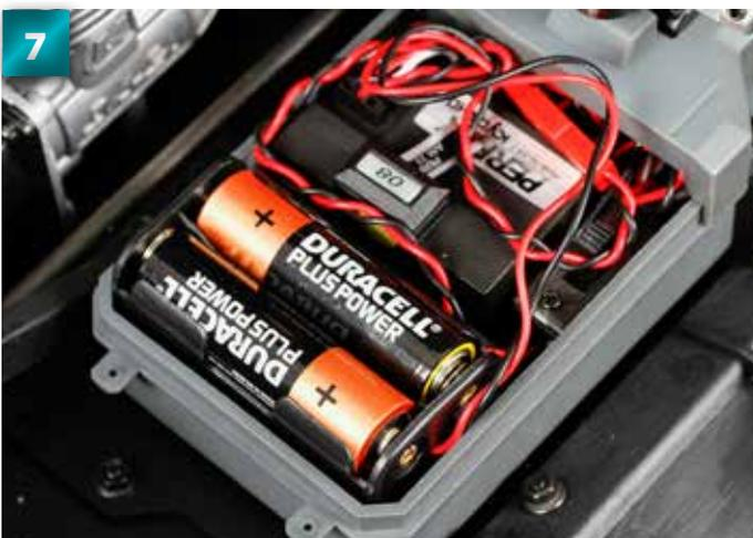
7 Placez le boîtier des piles dans l'espace réservé à cet effet dans le boîtier de radiocommande, situé à côté du récepteur.
