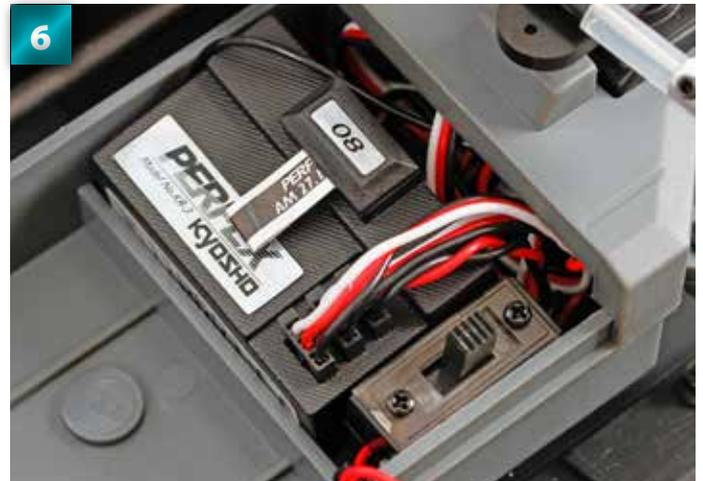
6 Placez le récepteur et l'interrupteur dans les compartiments du boîtier de radiocommande, l'un à côté de l'autre. Veillez à écarter les câbles du milieu.
