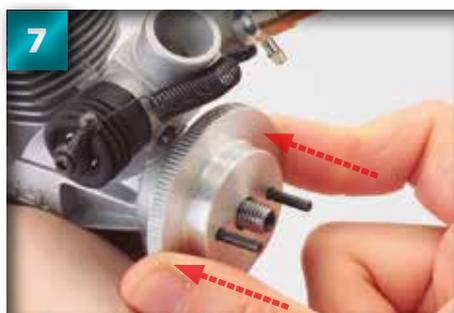
7 Enfoncez fermement le volant moteur pour le positionner correctement.
