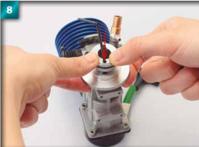
Tout en maintenant la clé Allen dans le trou, avec la pointe touchant la partie extérieure du ressort, enfoncez les mâchoires d'embrayage.
