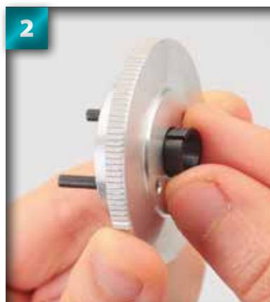
2 Introduisez la douille conique, la partie étroite en premier, dans le trou situé au centre du volant moteur, du côté dépourvu de barres.
