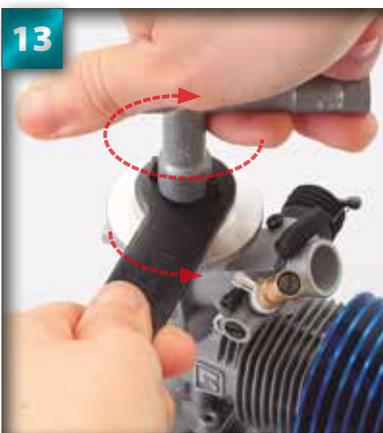
13 Pour fixer les pièces, faites tourner la clé en croix dans le sens des aiguilles d'une montre et la clé du volant moteur dans l'autre sens. De cette manière, le volant moteur épousera complètement la douille et l'axe pilote sera totalement fixé.
