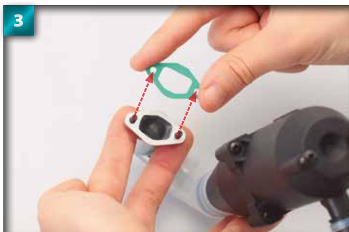
Tout en tenant les vis à capuchon par derrière, placez le joint du collecteur (étape 53) sur les pointes des vis.
