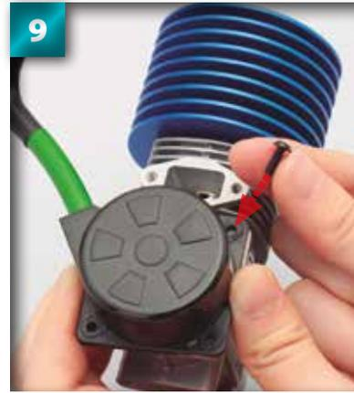
9 Posez la première vis à bouchon 2,5 x 8 mm dans le trou situé en haut à droite.
