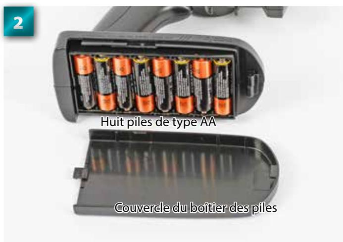
Insérez correctement les piles dans le transmetteur. Veillez à ce que les piles soient bien mises (+/-) et que la connexion soit assurée.
