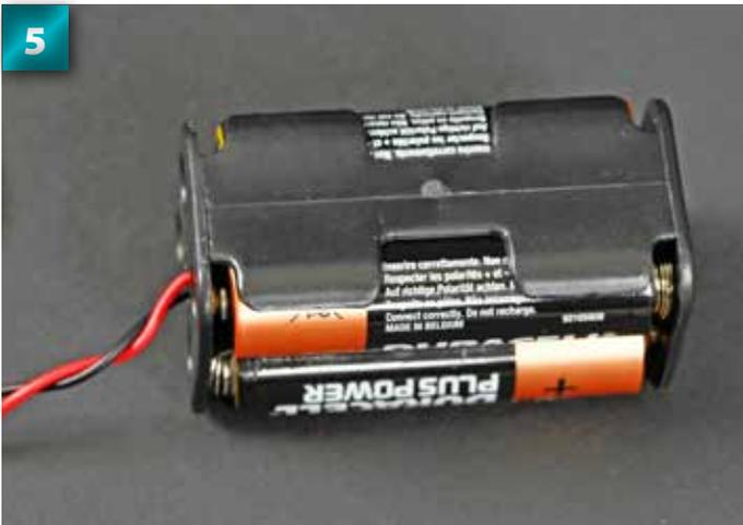
5 Introduisez les quatre piles de type AA à l'intérieur du boîtier des piles.
