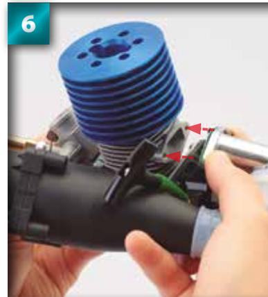
6 Placez le lanceur entre le moteur et le silencieux, puis raccordez le collecteur à l'orifice d'extraction.
