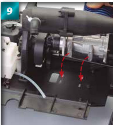
9 Prenez la plaque principale du châssis et identifiez les trous indiqués par les flèches rouges. Ils serviront à fixer le moteur.
