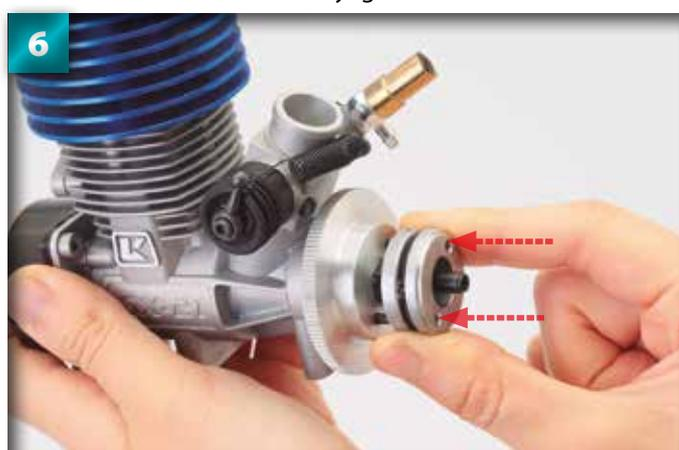
Insérez les deux barres du volant moteur dans les deux trous des mâchoires d'embrayage. Assurez-vous qu'elles ne s'accrochent pas dans le ressort intérieur de l'embrayage.
