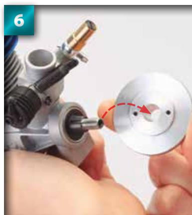
6 À présent, faites glisser le volant moteur, la face plane en premier, sur la pointe du vilebrequin jusqu'à ce que le volant moteur et la douille s'emboîtent comme nous l'avons vu à la séquence 3.
