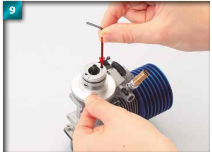
À présent, insérez la clé Allen dans l'autre trou et écartez à nouveau le ressort vers l'extérieur.
