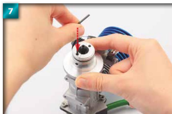
Introduisez l'extrémité longue de la clé Allen 2 mm dans l'un des trous des mâchoires et poussez le ressort sur le côté pour laisser de la place pour la barre du volant moteur.
