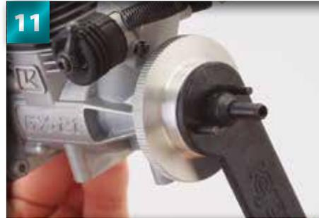
11 Appuyez fermement la clé du volant moteur contre la surface du volant. Il est important de ne laisser aucun espace entre la clé et la surface du volant moteur. Dans le cas contraire, les barres pourraient se plier.
