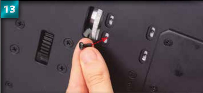
Placez une vis à tête plate 3 x 8 mm (étape 53) dans le premier trou. Serrez légèrement avec la main.
