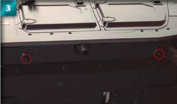
Veillez à ce que les barres de fixation ressortent sous le châssis.
