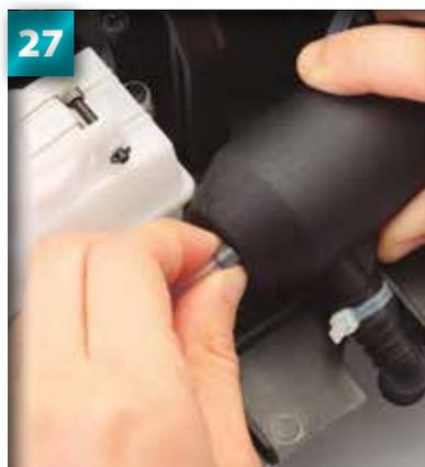
Faites un nœud avec la bride autour du tube de raccordement en silicone reliant le collecteur au silencieux.
