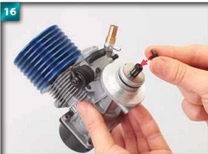
Tout en maintenant la vis et la rondelle ensemble, insérez la pointe de la vis dans l'extrémité ouverte de l'extension de l'axe.
