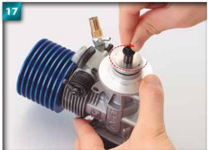
Serrez manuellement la vis à l'intérieur de l'extension de l'axe. Serrez suffisamment pour qu'elle tienne, étant donné qu'il s'agit d'un montage provisoire.
