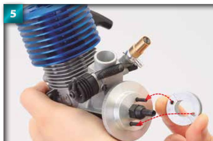
Placez les mâchoires d'embrayage face au volant moteur, la partie arrière tournée vers le carter.
