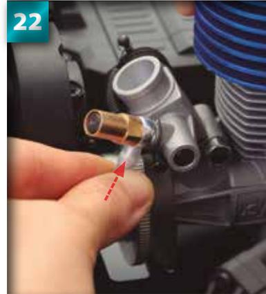
Veillez à ne pas érafler ou gratter le tube en silicone au moment de l'insérer dans le trou.
