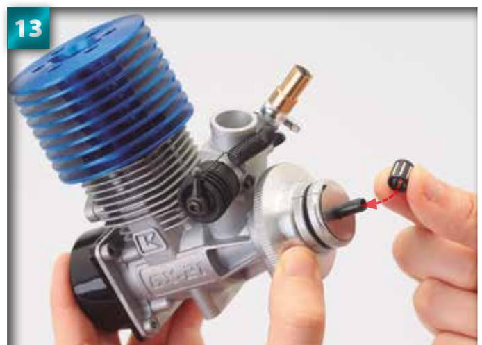
Placez désormais le roulement de l'embrayage sur l'extension de l'axe. Peu importe le côté que vous choisissez pour introduire le roulement.
