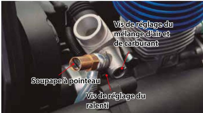
Avant d'allumer le moteur, vous allez devoir régler la soupape à pointeau, la vis de réglage du ralenti ainsi que la vis de réglage du mélange d'air et de carburant. Ces réglages doivent être effectués à chaque fois que vous allumez le moteur, et pas seulement la première fois. Il est indispensable de régler ces pièces régulièrement sans quoi de nombreux facteurs seraient susceptibles de les abîmer.
