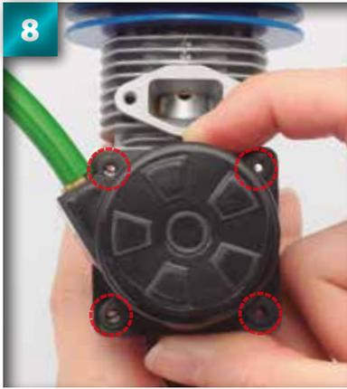
8 Veillez à ce que les pièces s'emboîtent correctement et que les quatre trous pour les vis ne soient pas bouchés.
