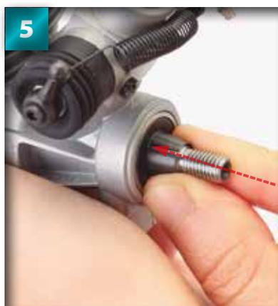
5 Enfoncez la douille le long de l'axe jusqu'à ce qu'elle repose contre le roulement. Peu importe où est située l'ouverture de la douille.
