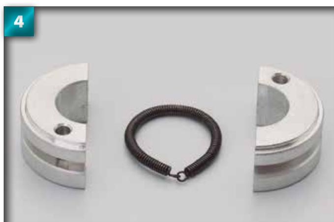
N'essayez pas de démonter les mâchoires d'embrayage. Pour vous faire une idée des composants, l'image ci-dessus vous montre les différentes parties. Les deux jantes en alliage d'aluminium abritent le ressort de l'embrayage, qui est indispensable pour le bon fonctionnement de l'embrayage.
