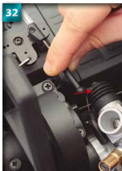
Introduisez l'embout sphérique dans la liaison pour raccorder les deux pièces.
