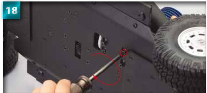
Serrez la vis du côté diagonalement opposé.
