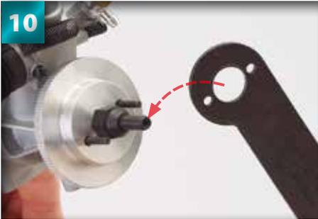
10 Placez désormais la clé du volant moteur sur de l'extension de l'axe. Assurez-vous que les trous de la clé coïncident bien avec les barres du volant moteur.
