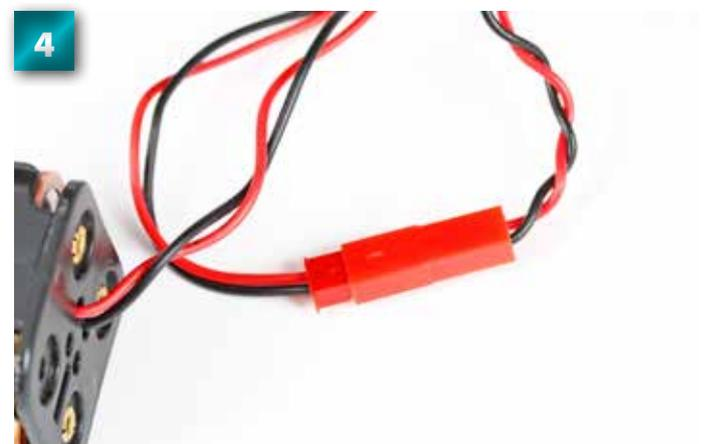
4 Reliez le boîtier des piles à l'interrupteur.
