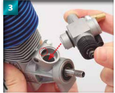
3 En tenant le montage du carter dans une main et le carburateur dans l'autre, introduisez le carburateur dans le support prévu spécialement pour le carburateur du carter. Veillez à ce que l'axe qui maintiendra le carburateur en place (cerclé en rouge) est positionné de manière à ce que la partie incurvée s'emboîte dans l'angle intérieur du support. De cette manière, le carburateur s'emboîte parfaitement dans le support.
