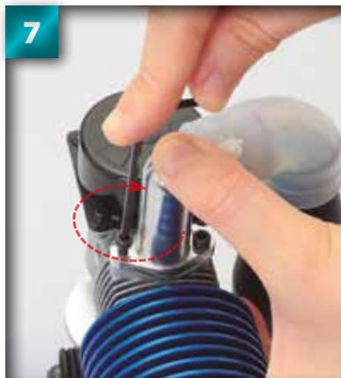
7 Desserrez et retirez la vis située sur l'embout d'échappement du silencieux, et mettez-la de côté.
