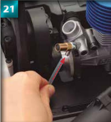
À présent, prenez le tube en silicone qui ressort du fond du réservoir de carburant et introduisez-le dans le trou argenté d'arrivée de carburant du carburateur.
