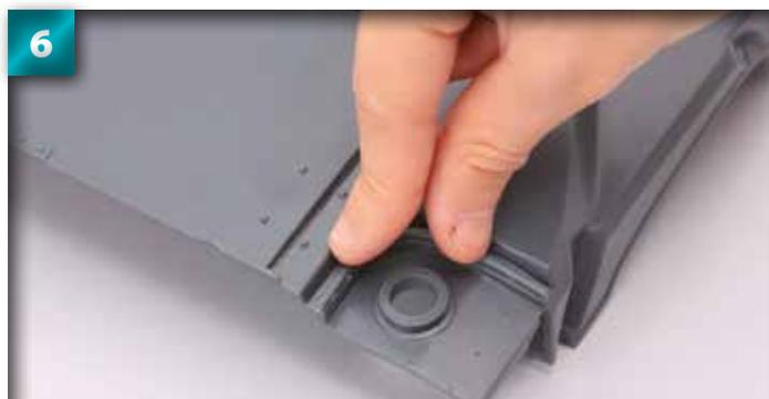
6 Alignez les saillants sous le joint avec les trous du capot.
