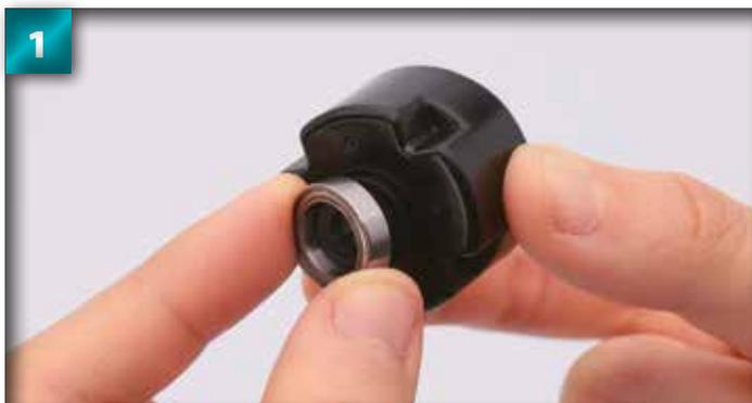
1 Placez le roulement 1510 sur le saillant circulaire du carter du différentiel.
