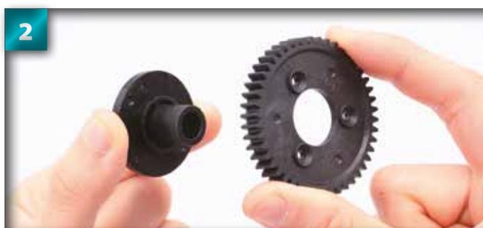
Introduisez le saillant du support de la roue dentée dans le trou de la roue dentée 46T. Assurez-vous de le faire par l'arrière.
