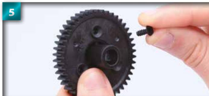
Introduisez une vis dans l'un des trous coniques de l'avant de la roue dentée.
