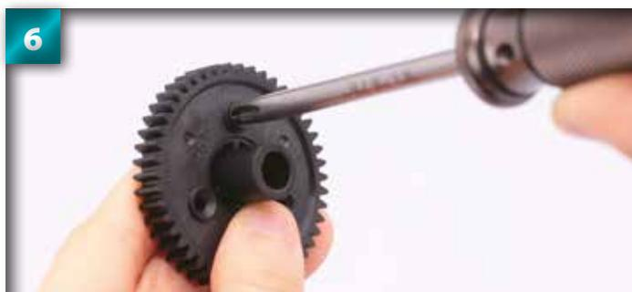
Serrez-la avec le tournevis, sans la bloquer : laissez environ 1 mm entre la tête de la vis et la surface de la roue dentée.
