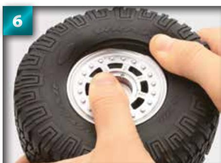
6 Faites tourner la roue et encochez l'autre bord du pneu dans l'autre côté de la roue.
