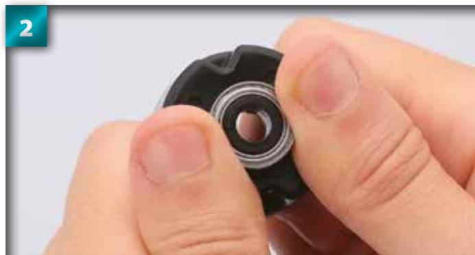
2 Appuyez fermement pour fixer le roulement sur le carter. Vérifiez que le roulement est bien aligné avec le carter.
