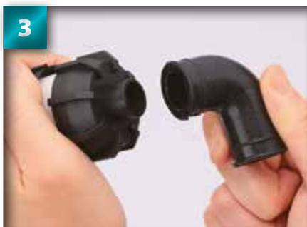
Assemblez le tuyau dans la base du filtre à air. En cas de difficulté vous pouvez limer un peu l'intérieur du tube.
