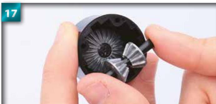
17 Introduisez le palier dans la cavité du différentiel. Il doit rester encoché dans les fentes de l'intérieur.
