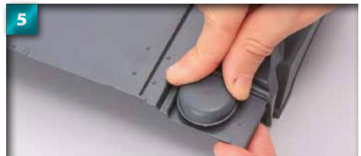
L'assemblage du filtre à air doit venir se loger dans le trou à côté du joint.
