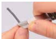
5 Prenez le joint du filtre à air. Pour l'installer correctement, placez le bout le plus allongé vers l'avant du capot.
