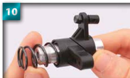
10 Placez le ressort sur l'essieu, entre les encoches de la partie inférieure du bras du protecteur.
