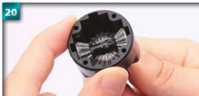
20 Tenez bien le carter du différentiel et lentement faites tourner l'articulation pour répandre la graisse dans tout l'engrenage.
