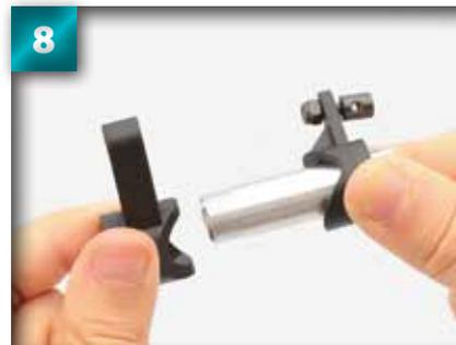
8 Maintenant introduisez l'essieu dans le bras inférieur du protecteur du servo frein. La bielle doit rester comme sur l'image.
