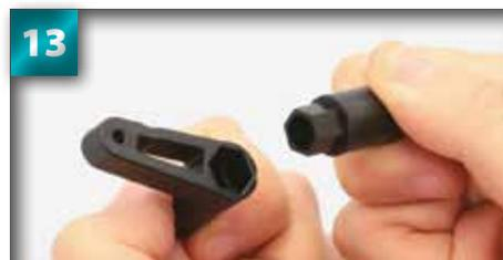
Séparez les pièces supérieure et inférieure du protecteur du servo frein gauche, fournies assemblées. Observez que les deux pièces s'engrènent hexagonalement.
