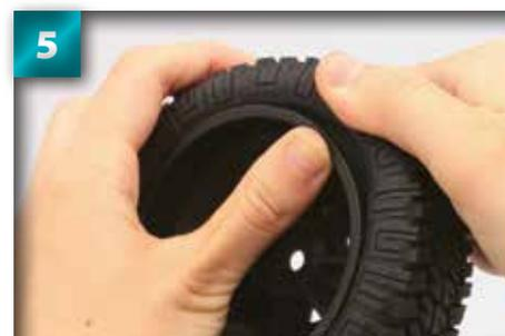
5 En faisant tourner la roue, soulevez légèrement le bord du pneu pour l'encocher dans la jante.
