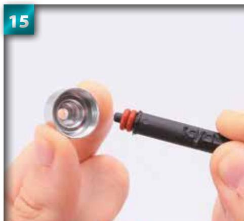
Placez le couvercle de l'amortisseur au bout de la tige, sur les deux joints toriques et l'anneau de fermeture.
