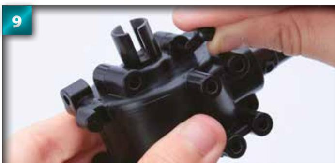
Insérez l'une des vis 4 x 12 mm dans le trou à droite sur l'arbre de transmission.
