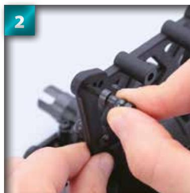
**2** Introduisez le bout du capuchon vissé dans le trou en haut à gauche de la suspension arrière.
