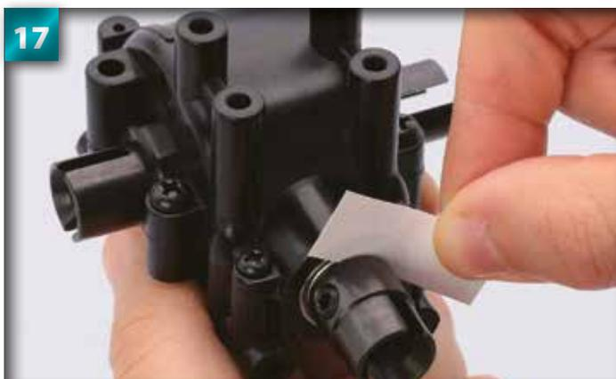
17 Insérez un morceau de carton fin entre l'articulation et le roulement pour les garder à la bonne distance.
