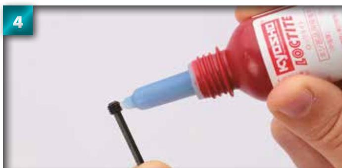
4 Introduisez la clé Allen dans la tête hexagonale de la vis de pression afin d'y déposer un peu de scellant ou de colle adhésive.
