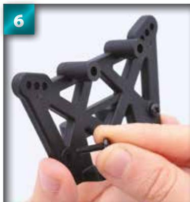
6 Introduisez l'autre vis de 3 x 12 mm dans le trou de l'autre côté de l'amortisseur.
