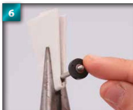
6 Posez la deuxième rondelle de 2,3 mm sur la tige, juste derrière le piston.
