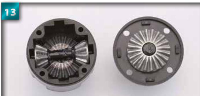
Pressez le planétaire sur l'articulation jusqu'à ce que la barre s'y encoche. Reprenez l'assemblage du différentiel de l'étape précédente.
