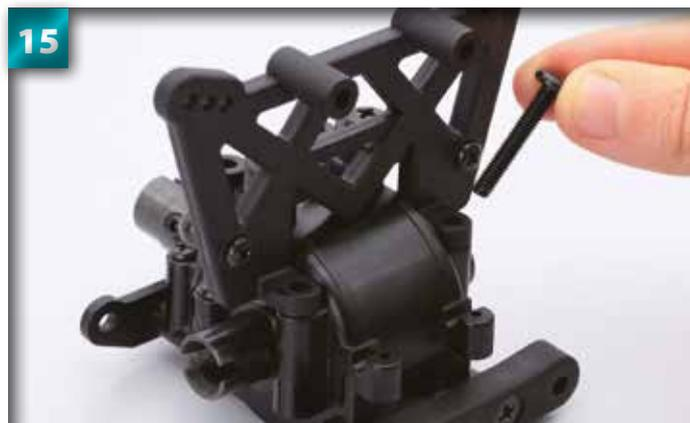
Introduisez une des vis de 4 x 25 mm dans le trou du saillant bas de l'arrière de l'amortisseur.
