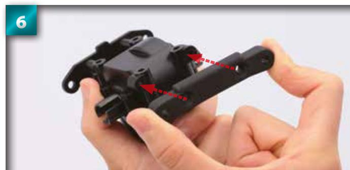
Posez l'assemblage comme sur l'image et placez le support de la suspension arrière sur le côté opposé à celui de la plaque.
