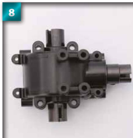
Ajustez la position de la partie haute de la cloison pour aligner les trous dans lesquels seront fixées les vis sur ceux de la partie basse.
