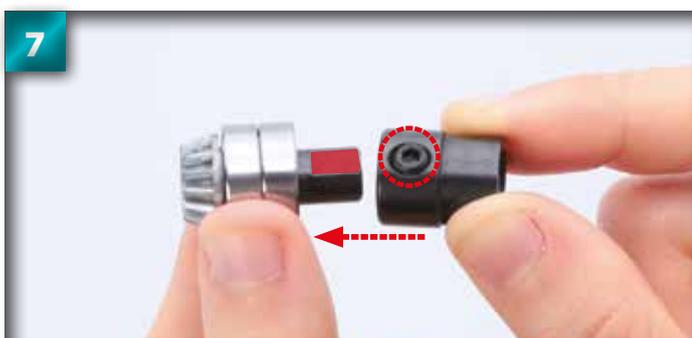
7 Introduisez l'arbre de transmission dans l'articulation et faites en sorte de laisser la vis de pression sur la surface plate de l'arbre (cercle rouge).
