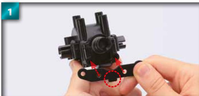
Tout en tenant l'assemblage de l'étape précédente comme sur l'image, placez la plaque de suspension arrière sous l'arbre de transmission. Le cercle rouge indique la position de la plaque.
