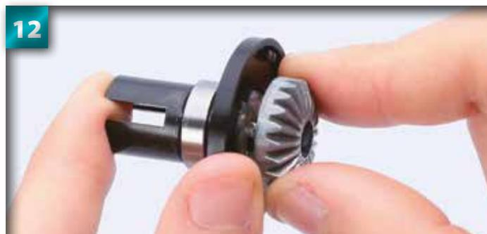
Orientez l'encoche dans le même sens que la barre et introduisez le planétaire jusqu'au fond en le faisant glisser sur l'articulation.
