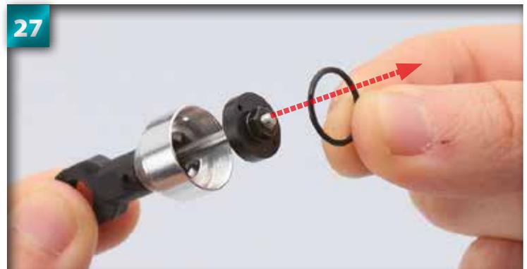
27 Poussez la tige à travers le couvercle puis passez le joint torique de 11 mm à travers le piston.
