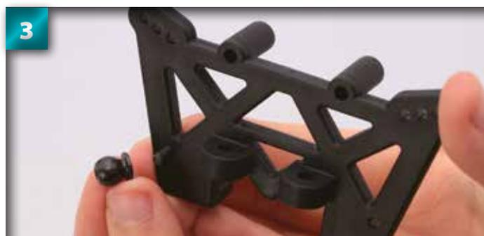
Tenez la vis et placez l'un des embouts sur la tête de la vis.
