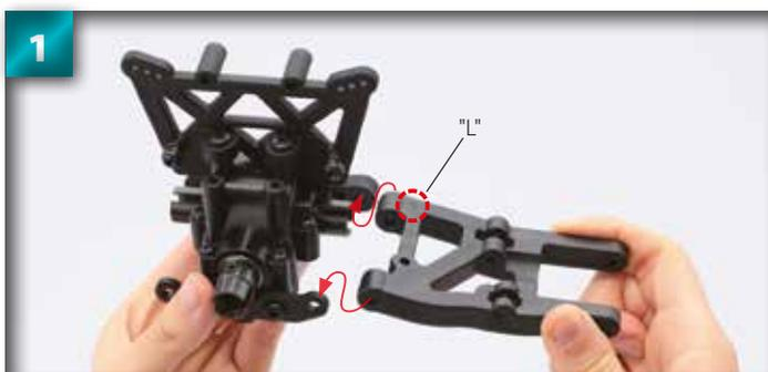
Tenez la cloison inférieure comme sur l'image et placez le bras inférieur gauche entre le support et la plaque de suspension.
