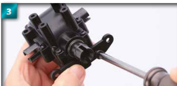
Introduisez une vis de 4 x 10 mm dans le trou à droite de la plaque de suspension et serrez.
