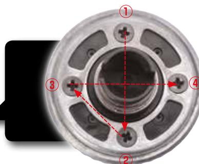
Introduisez une des vis autoforeuses de 2,6 x 12 mm dans l'un des trous et serrez-la à moitié. Suivez alors l'ordre indiqué sur l'image à droite afin de visser les trois autres à moitié. Une fois les quatre vis en place, terminez de visser à tour de rôle, en suivant toujours ce même ordre.
