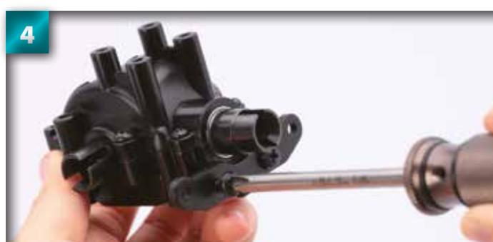
Serrez une autre vis de 4 x 10 mm dans le trou de la plaque de suspension à gauche du précédent.
