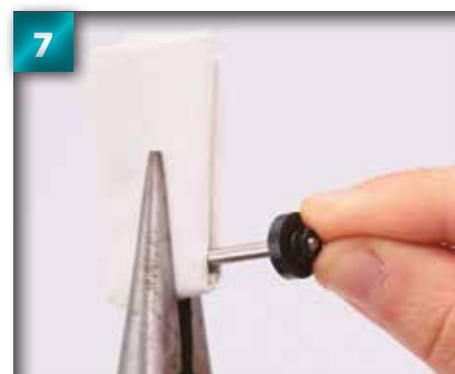
7 Placez l'écrou de 2,6 mm sur le filetage de la tige et vissez-la à la main.
