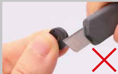
Ne coupez jamais la surface extérieure du piston, à moins que la bavure ne dépasse de quelques millimètres, car vous pourriez déformer facilement la pièce.
