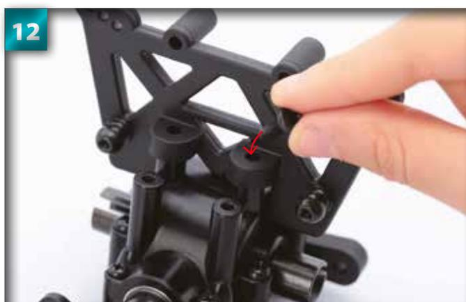
12 Placez une vis de 4 x 10 mm dans l'un des trous des saillants en demi-cercle de l'avant de l'amortisseur.
