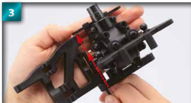
3 Poussez l'axe à travers les trous du bras gauche de suspension.
