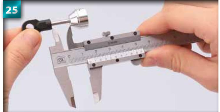
25 Mesurez l'espace entre le couvercle et l'anneau inférieur. L'anneau inférieur devrait être à 14 mm du couvercle. Serrez-le ou desserrez-le pour bien l'ajuster.
