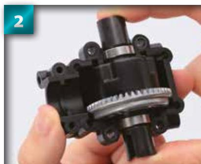
Placez l'assemblage du différentiel dans la cavité de la partie basse de la cloison, comme sur l'image.
