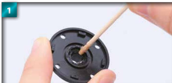
1 Déposez un peu de graisse sur le bout d'un cure-dent et étalez-la sur le creux au centre et à l'intérieur du carter du différentiel.
