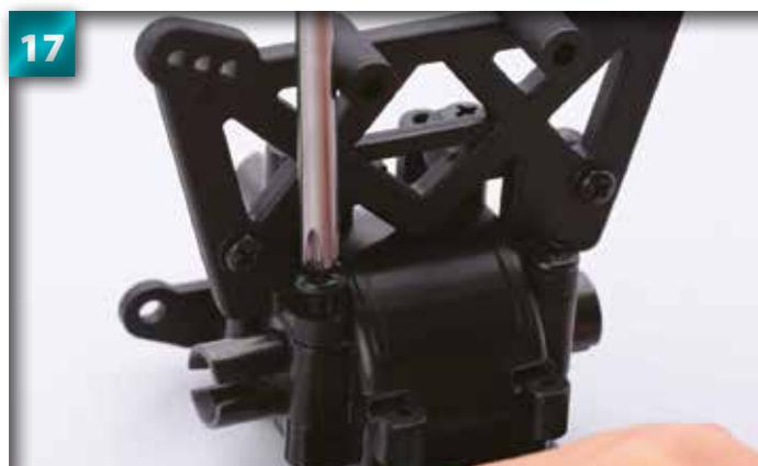
Placez la deuxième vis dans le trou du saillant de l'autre côté et serrez-la afin de fixer l'amortisseur sur la cloison.
