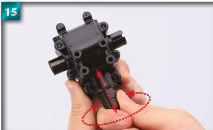
15 Une fois la partie haute de la cloison refermée, vérifiez le mouvement de l'arbre de transmission. Faites-le tourner de gauche à droite tout en le tirant vers l'arrière et en le forçant doucement à s'encocher jusqu'à ce que les engrenages et les articulations roulent doucement.
