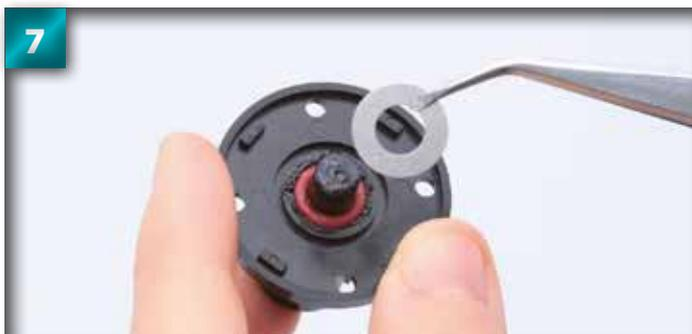
Placez la rondelle sur l'articulation et posez-la sur le joint torique.
