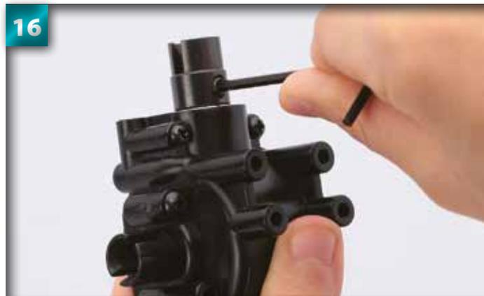
16 Si vous devez forcer trop, desserrez un peu la vis de pression avec la clé Allen.
