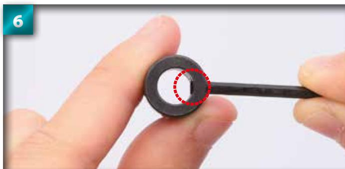
6 Serrez la vis de pression dans le trou jusqu'à ce que 0,5 mm de la tige apparaisse à l'intérieur de l'articulation.
