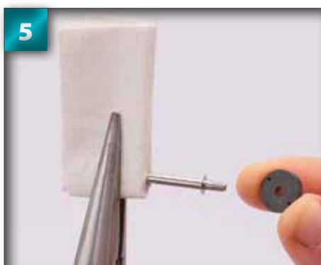
5 Placez le piston au bout de la tige, juste derrière la rondelle.
