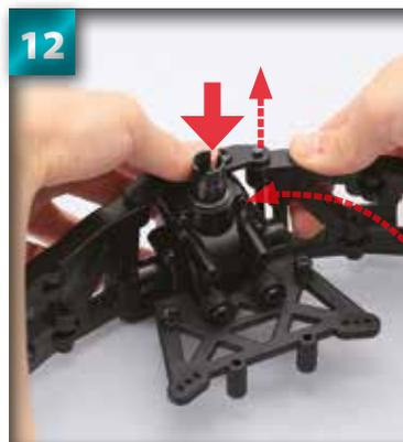
**12** Tout en appuyant sur le bras vers l'intérieur pour aligner les trous, poussez le montage vers le bas, afin que l'axe entre dans le trou de la plaque de suspension.
