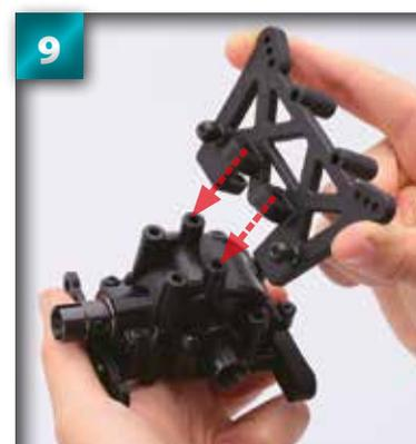
9 Placez l'amortisseur arrière sur la cloison, au dessus des saillants se projetant sur le dessus (flèches rouges).
