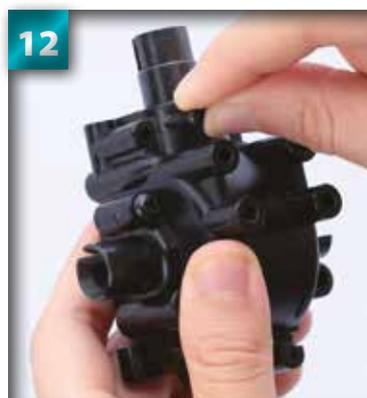
Introduisez une vis de 3 x 10 mm dans les trous de chaque côté de l'arbre de transmission.
