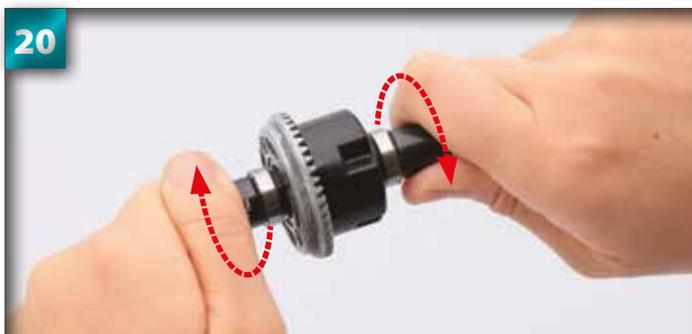
Faites tourner l'articulation du différentiel des deux côtés pour répartir la graisse sur tout l'engrenage intérieur.
