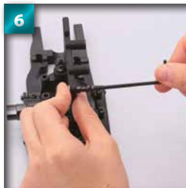
Aidez-vous d'une clé Allen de 2,5 mm pour serrer la vis et l'écrou encore un peu.
