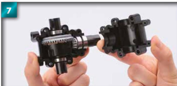
Placez la partie haute de la cloison sur le différentiel et l'axe et encochez-la dans la pièce précédente.
