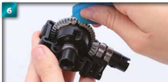
Graissez un peu les engrenages 13T et 43T et faites-les tourner pour étaler la graisse.
