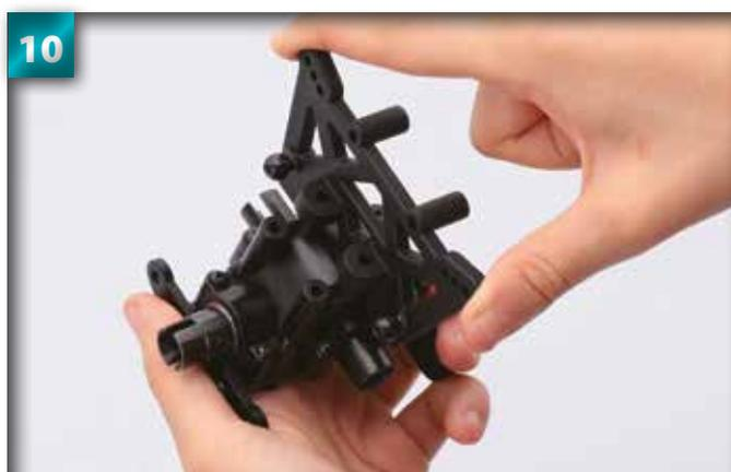
10 Alignez les saillants en demi-cercle de l'avant de l'amortisseur et les saillants de la cloison.
