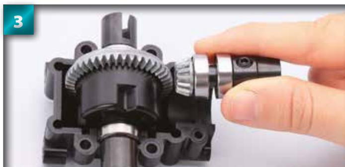
Placez l'arbre de transmission dans le creux cylindrique de la cloison, à côté du différentiel.
