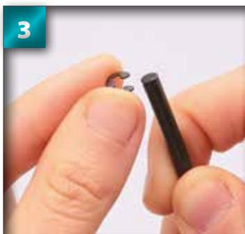
Tenez l'anneau en demi-cercle en laissant au dessus le côté légèrement rebondi et repérez la rainure au bout de l'axe de 4 x 74 mm.
