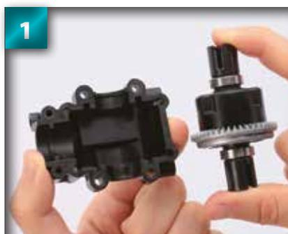
Prenez la partie basse de la cloison et reprenez l'assemblage du différentiel.
