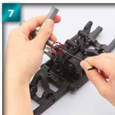
Introduisez le deuxième capuchon vissé dans l'articulation à rotule de 5,8 mm et faites-la sortir à travers le trou à droite de la suspension.
