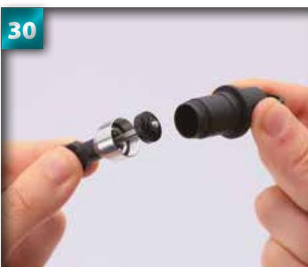
30 Placez provisoirement l'amortisseur et le montage de la tige dans le boîtier de l'amortisseur.
