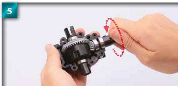
Faites délicatement tourner l'arbre de transmission vers la droite pour vérifier que l'engrenage du différentiel tourne doucement. Vérifiez que pendant ce temps les pièces restent bien en place.
