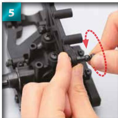
Serrez la vis et l'écrou avec vos doigts.
