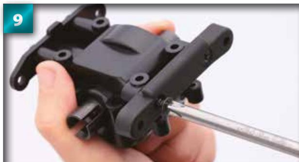
Fixez une autre vis de 4 x 16 mm dans le deuxième trou du support de suspension.
