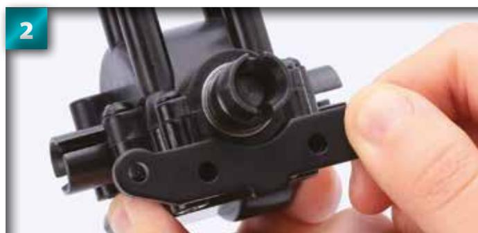
Alignez les trous (dans lesquels vous fixerez les vis) de la plaque inférieure de suspension et ceux de la cloison.
