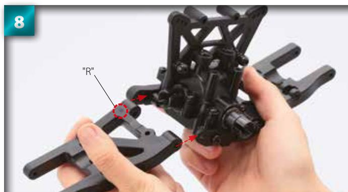
8 Disposez le bras droit de la suspension de l'autre côté de l'assemblage, entre le support et la plaque de suspension.
