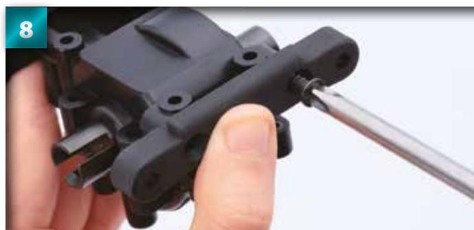
Introduisez une vis à tête conique de 4 x 16 mm dans l'un des trous et vissez-la sur la cloison.
