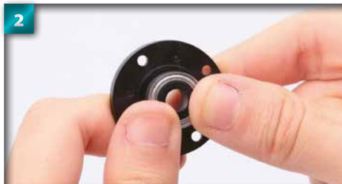
2 Appuyez fermement sur le roulement afin de le fixer sur le carter. Vérifiez l'alignement du roulement et du carter.
