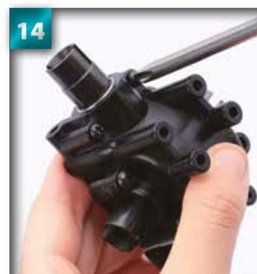
Ensuite, serrez la deuxième vis dans le trou du côté opposé de l'assemblage.
