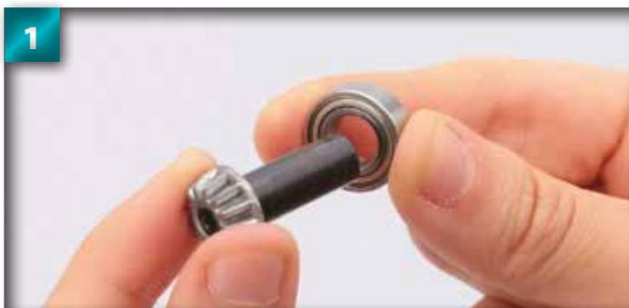
1 Tenez l'arbre de transmission fourni monté et placez le roulement 1680 sur l'arbre en le posant derrière l'engrenage.
