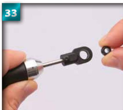
Tenez l'assemblage de l'amortisseur et tournez-le de manière à exposer le côté le plus large de l'anneau inférieur. Prenez une rotule perforée de 6,8 mm.
