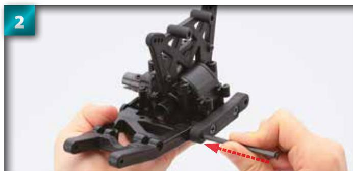
Introduisez l'un des axes dans le trou du support de suspension.
