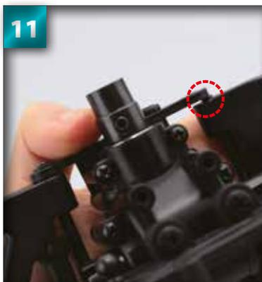
**11** Poussez le bras droit de suspension vers l'assemblage afin d'aligner les trous de la plaque et du bras.
