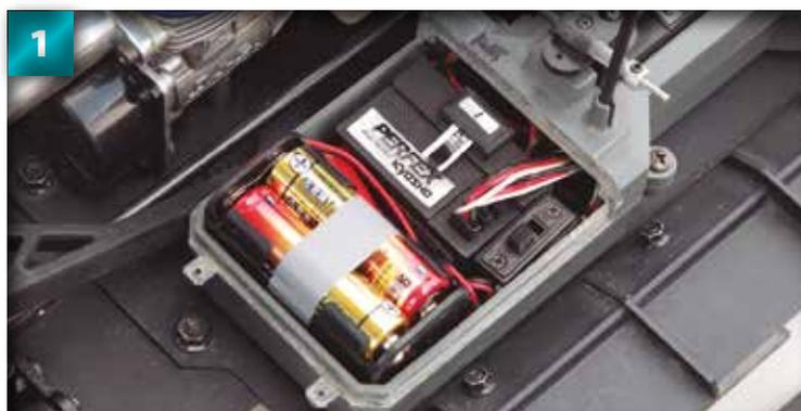
Le boîtier de la batterie et l'interrupteur d'alimentation se trouvent à l'intérieur du boîtier de radiocommande, qui sera placé à la base du châssis dans les étapes postérieures. Le boîtier est présenté ouvert sur l'image ci-dessus, mais pendant que la voiture est en marche il restera verrouillé par des chevilles. C'est ce qui empêchera la poussière et la saleté d'entrer en contact avec les composants, car cela pourrait altérer le fonctionnement des pièces qu'il contient.
