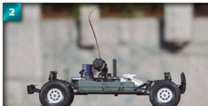
Quelle que soit la longueur de l'antenne, elle doit être plus longue que la hauteur du toit de la carrosserie. Cela ne posera aucun problème, car le câble en résine molle de l'antenne est suffisamment souple comme pour s'enfiler par la carrosserie.
