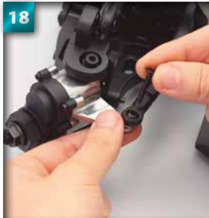
Placez une vis à tête conique 3 x 18 mm dans la boule située dans la cavité de la barre d'accouplement et faites-la également passer par le trou du bras du moyeu.
