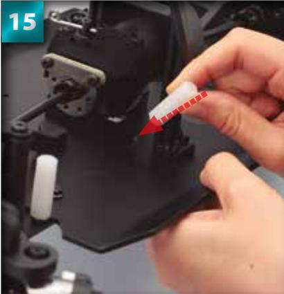
15 Retournez à nouveau le châssis, tout en maintenant la vis du dessous pour éviter qu'elle ne tombe, puis installez le deuxième pilier du réservoir de carburant sur la pointe de la vis.
