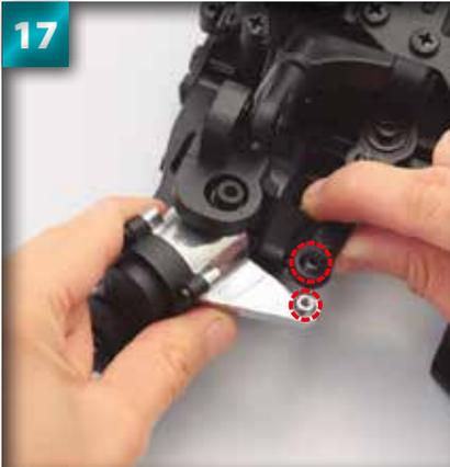
Raccordez le bras du moyeu avec l'extrémité libre de la barre de d'accouplement de façon à faire coïncider les trous (signalés par un cercle) de part et d'autre.
