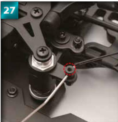
27 Placez la vis de pression dans le trou du bras de servo dans lequel se trouve la bielle de direction.
