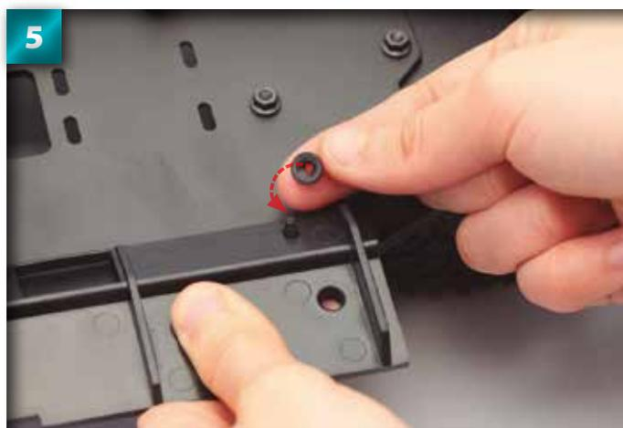
Maintenez la vis en place et mettez un écrou à embase 3 mm sur l'extrémité de la vis.
