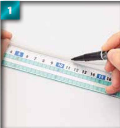
1 Placez le tuyau en silicone sur la règle, en parfait alignement. Marquez le tuyau à une distance de 11 cm au feutre. N'appuyez pas sur le tuyau.
