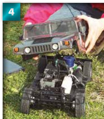
La structure et les panneaux de la carrosserie seront d'ores et déjà installés. La seule chose à faire est de placer le châssis avec l'antenne située en dessous puis abaisser la carrosserie jusqu'à faire cliquer les crochets. Tout est fin prêt pour courir.
