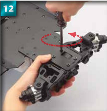
Ensuite, retournez le montage du châssis et commencez à desserrer les vis à tête conique 4 x 16 mm qui fixent la cloison avant au châssis.
