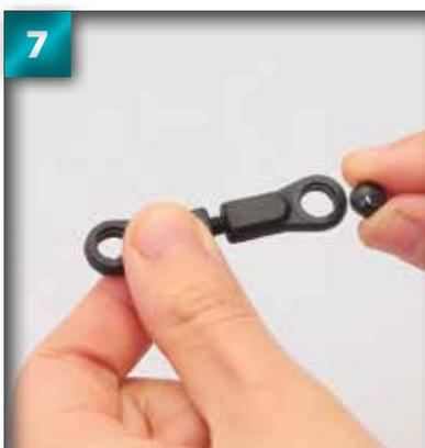
7 Placez une boule perforée de 6,8 mm dans l'une des cavités de la première barre d'accouplement. Le trou dans la boule doit être perpendiculaire à la cavité de la barre.
