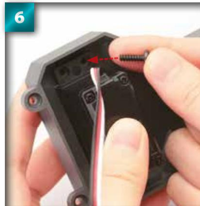
6 Retournez l'assemblage puis insérez une autre vis 3 x 10 mm dans le trou de l'autre côté, opposé diagonalement à celui que vous avez utilisé étape 5.
