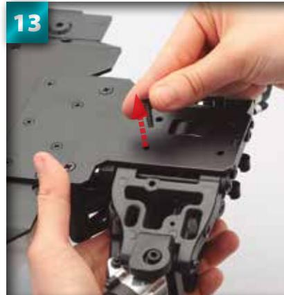
Retirez les quatre vis afin d'enlever la cloison arrière. Rangez les vis en un lieu sûr.
