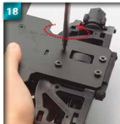
Retirez les quatre vis pour pouvoir enlever la cloison arrière.
