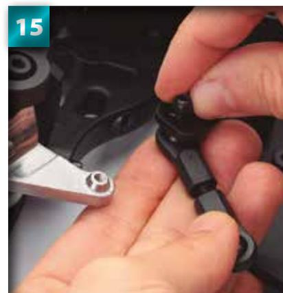
**15** Placez le châssis sur le côté et maintenez l'écrou en place avec la pointe de la clé croisée 5,5. Placez le tournevis Phillips sur la cime de la vis à tête conique.
