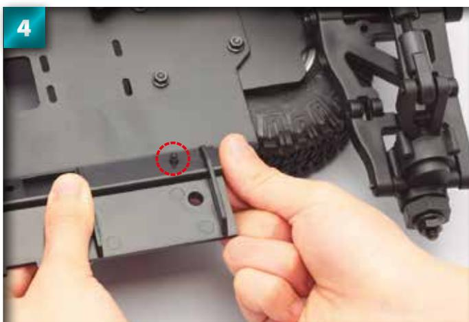
Insérez à l'arrière une vis à tête plate 3 x 10 mm dans la première paire de trous.
