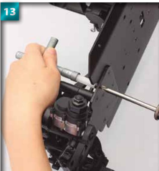
Mettez le châssis sur le côté et serrez la vis à l'aide d'un tournevis tandis que vous maintenez le pilier du réservoir en place avec la clé croisée.
