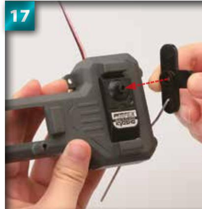
17 Maintenez le boîtier de direction avec la servo-direction orientée vers le haut, comme indiqué sur l'image. Placez l'ensemble composé par la bielle de direction et le bras de servo sur l'arbre faisant saillie de la servo-direction, de sorte que le bord arrondi de l'arrière du bras de servo s'ajuste sur l'arbre.
