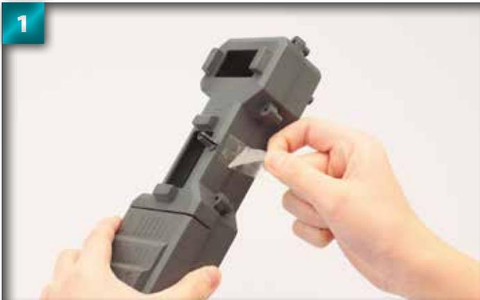
Retirez le ruban de cellophane qui permet de maintenir rattachées les pièces du boîtier de radiocommande.
