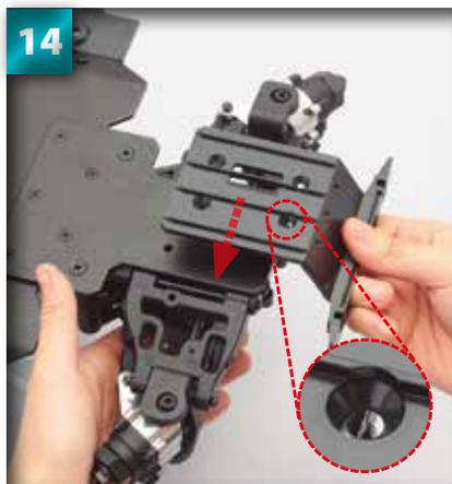
Avec les trous en bon alignement, remplacez les quatre vis à tête conique 4 x 16 mm retirées séquence 13. Vissez avec délicatesse à l'aide d'un tournevis.
