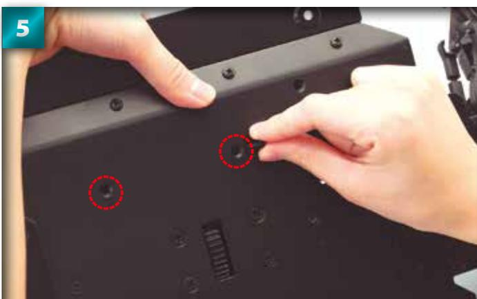
Lorsque les projections de la partie inférieure du boîtier correspondent aux six trous marqués d'un cercle séquence 4, introduisez les vis auto-taraudeuses 3 x 8 mm, en commençant par les trous du centre marqués par un cercle. Enfoncez tout d'abord la vis dans le trou le plus près du bord.
