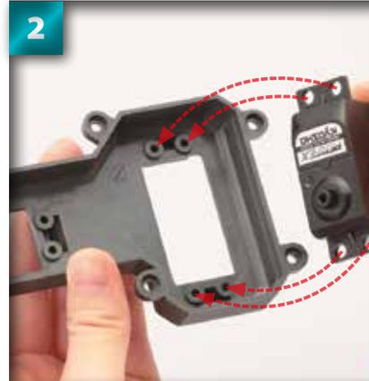
2 Placez cette pièce du boîtier face vers le bas pour que la partie inférieure soit orientée vers le haut, puis posez la servo-direction dans l'orifice rectangulaire, de façon à ce que les trous préparés à recevoir les vis des deux pièces correspondent.
