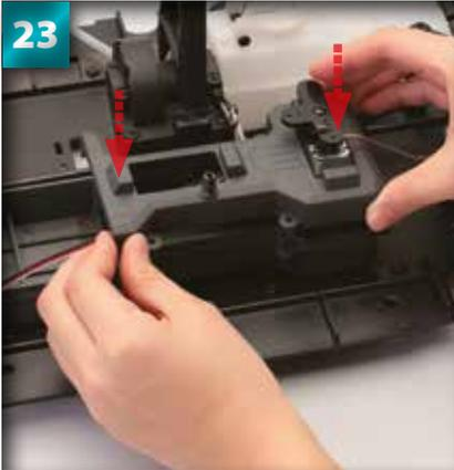
23 Descendez avec soin le boîtier de radiocommande et placez-le sur la partie inférieure installée à l'étape antérieure. Les pièces doivent s'imbriquer en douceur les une dans les autres.
