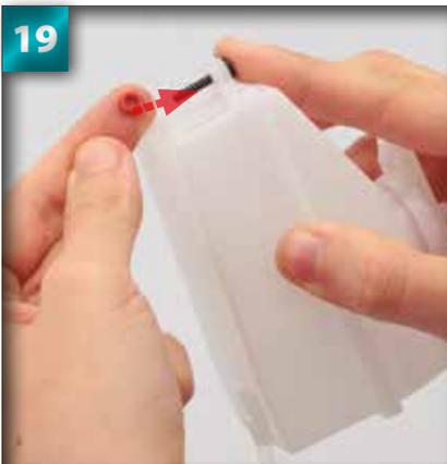
19 Posez un joint torique 3 mm sur la pointe de la vis.
