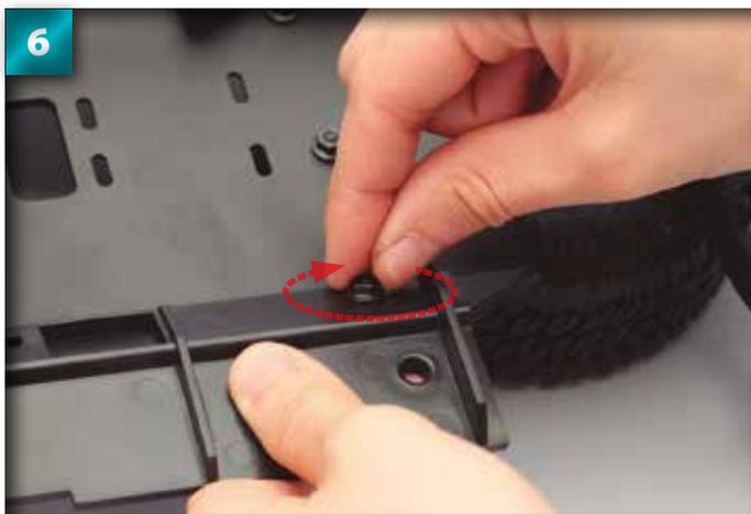
Tournez l'écrou dans le sens des aiguilles d'une montre pour le fixer. Pour l'instant, le serrer à la main suffit.
