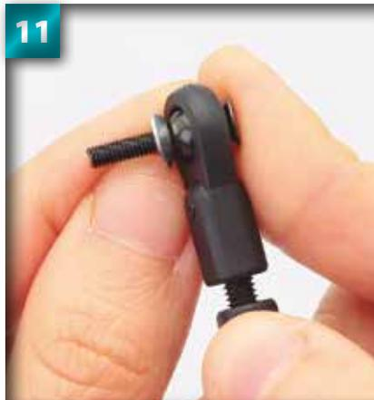
**11** En maintenant la vis à tête conique en place, positionnez la barre d'accouplement avec la pointe de la vis orientée vers le haut, en dessous du côté gauche de la plaque de direction (regardez la flèche).
