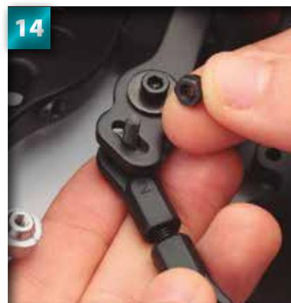
**14** Maintenez la barre d'accouplement ainsi que la vis à tête conique en place, puis insérez l'écrou en nylon 3 mm sur la pointe de la vis.
