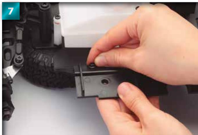
Répétez les séquences 4, 5 et 6 avec les trois autres paires de trous pour attacher le support de la carrosserie gauche au châssis.
