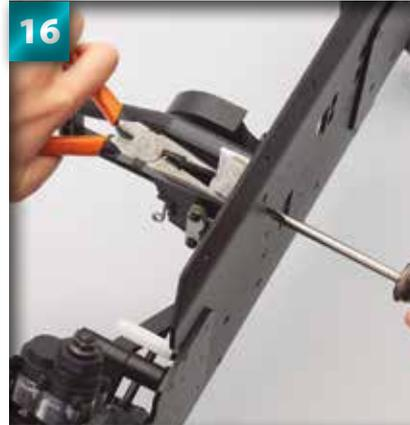
16 Étant donné que la vis est très proche de l'arceau de sécurité, il n'est donc pas possible d'utiliser la clé croisée dans cette séquence. À la place, prenez la pince à pointe fine, mais couvrez d'abord le pilier du réservoir avec un chiffon ou un mouchoir pour le protéger.
