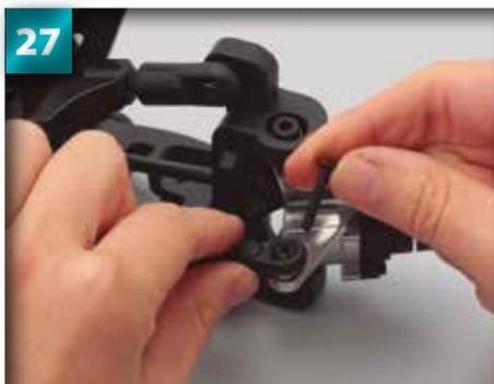
Introduisez la deuxième vis à tête conique 3 x 18 mm à travers les trous de la boule de la barre d'accouplement et du bras du moyeu.
