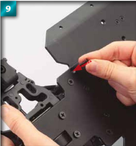
Placez la plaque principale du châssis de sorte que le fond soit orienté vers le haut. Repérez le trou représenté sur l'image, situé à l'extrémité avant du châssis, puis enfoncez une vis à tête conique 3 x 12 mm.
