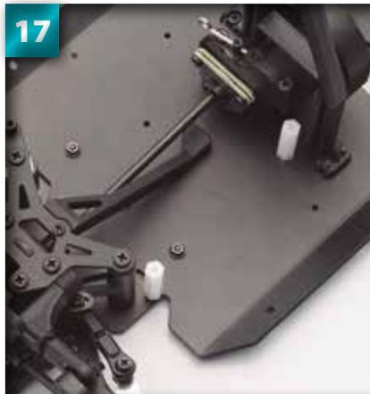
17 Enfoncez la première vis à tête plate 3 x 15 mm dans le trou à l'avant du réservoir.
