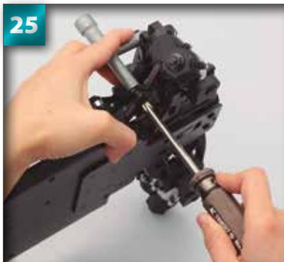
À l'identique de la séquence 16, maintenez en place l'écrou à l'aide de la clé croisée et serrez la vis avec le tournevis.
