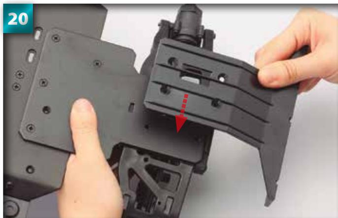
Placez le support du pare-choc arrière de façon identique au support du pare-choc avant.
