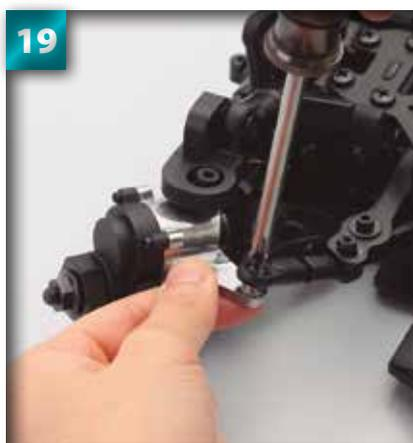
Retournez avec précaution le châssis et placez un écrou 3 mm sur la pointe de la vis.
