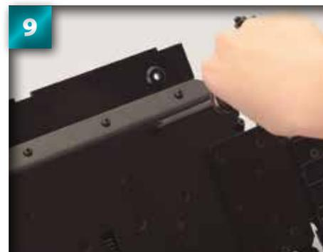
Enfoncez les autres vis auto-taraudeuses 3 x 8 mm dans les trois autres trous mis en évidence séquence 4. Serrez-les à fond à l'aide d'un tournevis.
