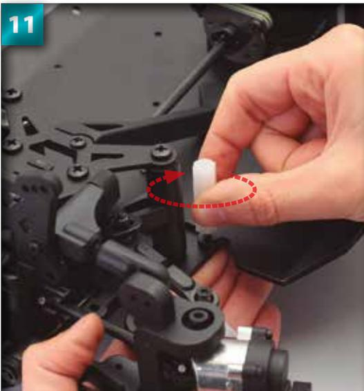
Pendant que vous tenez la vis en place par le bas, tournez le pilier du réservoir dans le sens des aiguilles d'une montre pour le fixer au montage.
