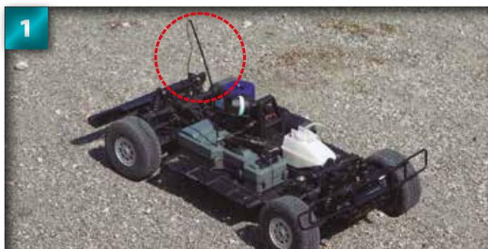
Voici l'antenne, sise au centre du châssis sans la carrosserie. La longueur du câble dépendra de la fréquence radio utilisée par la télécommande, mais elle ne devrait pas être aussi longue au point de se plier, vu que cela pourrait créer des interférences dans l'émission du signal.
