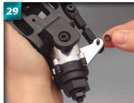
Retournez le châssis et placez le deuxième écrou 3 mm sur la pointe de la vis.
