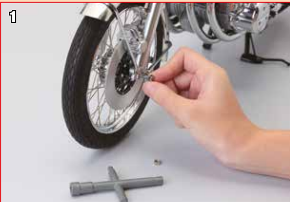
1 Si le pneu avant a blanchi retirez la roue avant.
