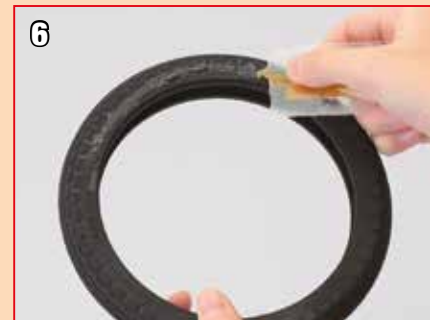
6 Déposez de la graisse légère à base minérale (comme celle qui a été fournie dans l'étape 6) sur la surface extérieure du pneu.
