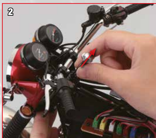
2 Retirez l'arbre de direction qui tient l'assemblage de la fourche avant en place.
