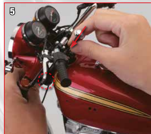
5 Retournez l'assemblage de la fourche avant vers sa position initiale et installez à nouveau l'arbre de direction (voir étape 72).
