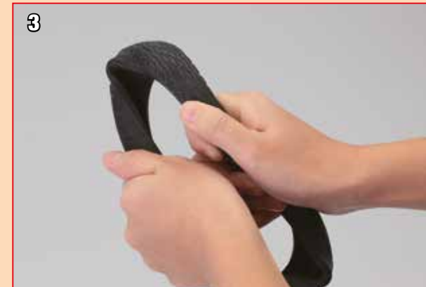
3 Tordez le pneu afin d'en retirer la poussière. Frottez la surface du pneu avec une brosse à dents, qui vous aidera à retirer la poussière des bandes de roulement.
