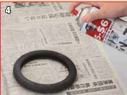
4 Placez le pneu sur du papier journal et pulvérisez du lubrifiant à base de silicone afin de le nettoyer.
