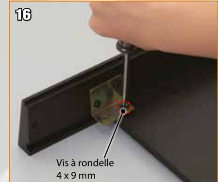
Introduisez une vis à rondelle 4 x 9 mm dans l'orifice du joint aligné sur l'orifice de la base 9.
