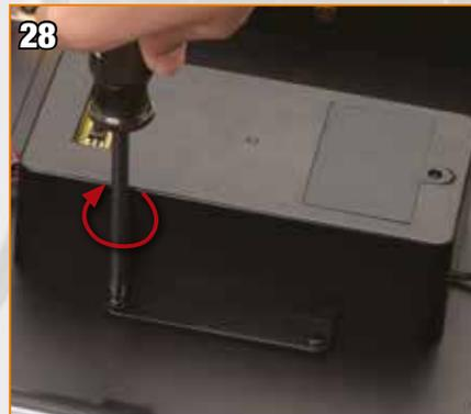
Insérez trois vis à rondelle 4 x 10 mm dans les orifices restants.
