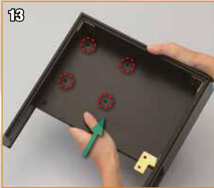
Glissez la base 9 dans les encoches des bases 2 et 4 et, à travers la fente au fond de la base 6, dans les orifices cerclés d'après les positions sur l'image ci-dessus.
