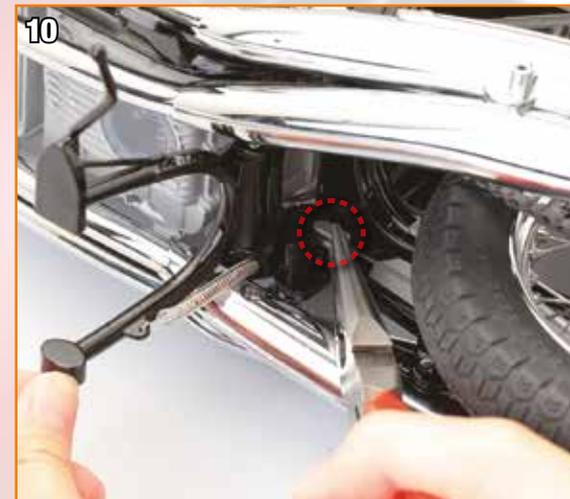
10 Montez à nouveau la tige du frein arrière sur le rotor du frein arrière.
