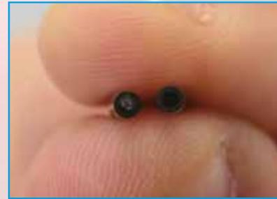
L'image ci-dessus montre l'extrémité d'un câble déconnecté. À gauche l'extrémité cassée du connecteur est toujours à l'intérieur. À droite vous voyez l'autre extrémité du câble, plus
