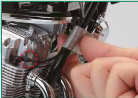
Secouez légèrement le câble afin de laisser à l'horizontale l'extrémité reliée au connecteur (cerclé). Fixez temporairement le câble avec du ruban adhésif.
