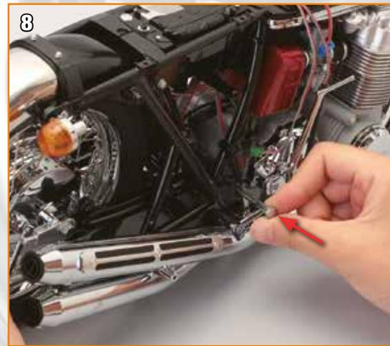
8 Introduisez l'axe pivotant dans les orifices alignés du cadre et du bras basculant.
