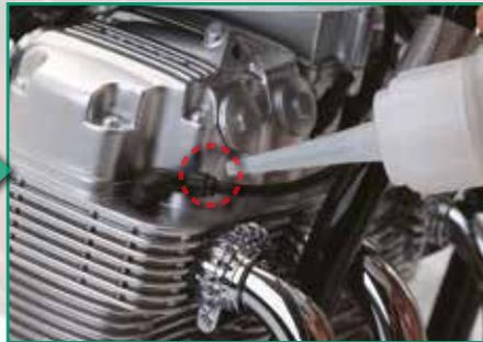
Déposez un peu de colle instantanée sur l'union du câble et du connecteur (cerclé). Gardez le câble dans la même position, jusqu'à ce que la colle soit sèche.
