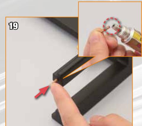
Avec un peu de colle multi-usages, collez le boulon de connexion (étape 52) dans l'orifice de la base 2.
