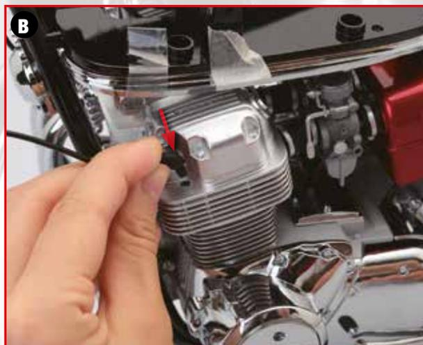
Tenez l'extrémité du câble de remplacement et introduisez-la dans l'orifice indiqué sur l'image. Passez l'autre extrémité vers le haut et par le cadre, en suivant le parcours du câble d'origine.
