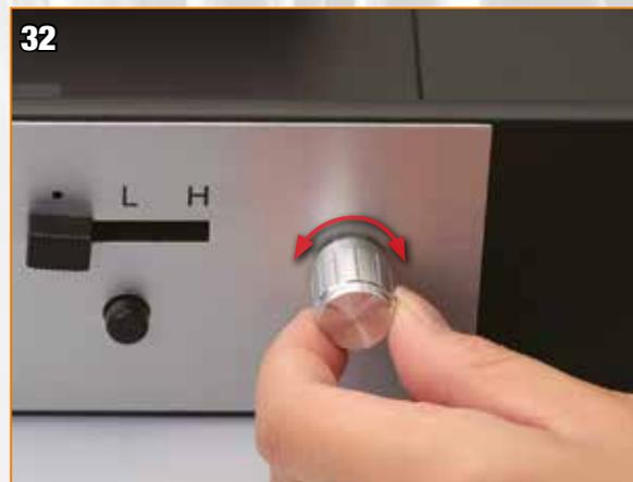
Tournez lentement le bouton de chaque côté afin d'en vérifier le mouvement, qui doit être doux. Tournez le bouton complètement à gauche afin de régler le volume au minimum, à droite pour le régler sur le maximum.
