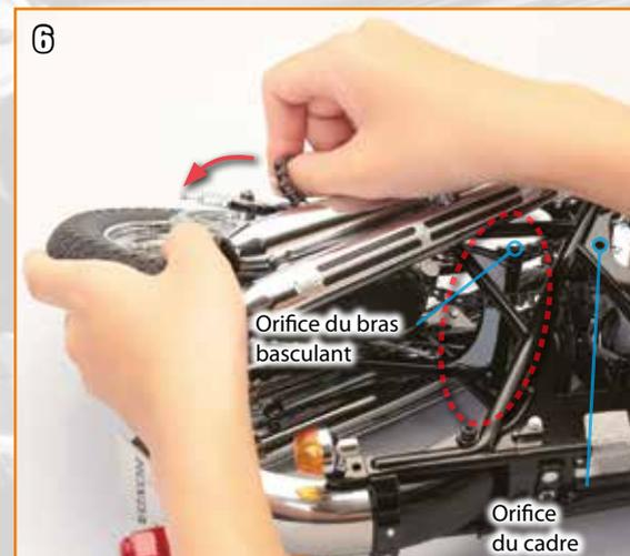
6 Posez le cadre principal sur son côté droit. Réinstallez le bras basculant et la roue arrière dans leurs emplacements en laissant l'orifice à l'avant du bras basculant vers l'orifice du cadre. La chaîne doit être sur le pignon arrière.
