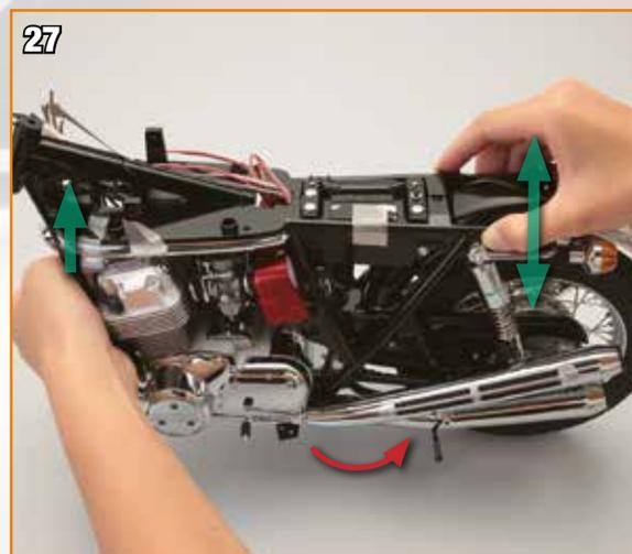
27 Soulevez le support central et appuyez légèrement sur l'arrière de la structure tandis que vous soulevez l'avant, afin de tester la suspension arrière.
