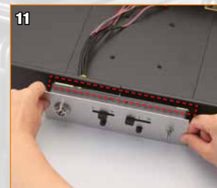
11 Ajustez la position de la partie supérieure du panneau de contrôle afin de l'aligner à l'orifice supérieur de la base.
