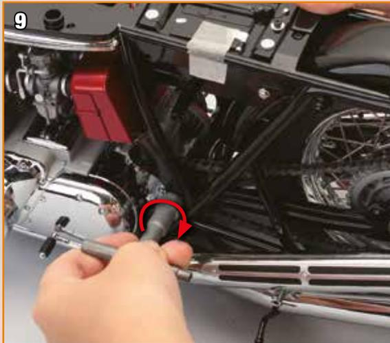
9 Prenez le croisillon et serrez l'écrou sur l'extrémité de l'axe pivotant.
