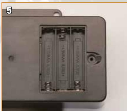
Trois piles AAA seront installées dans le compartiment à piles à la fin du montage. Pour le moment, réinstallez le couvercle et la vis.
