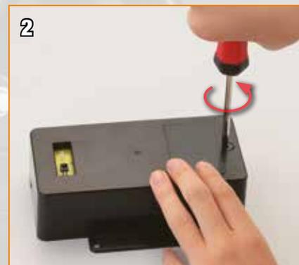
2 Desserrez la vis sur le côté opposé du boîtier de contrôle.
